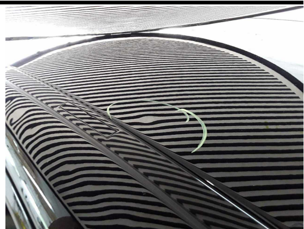
Beschädigung #3: Fahrzeugdach: Dach (2 Stück) - Delle(n) - sanft instandsetzen
