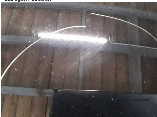
Beschädigung #1: Motorhaube: Motorhaube - verkratzt / versch... - auslegen / polieren
