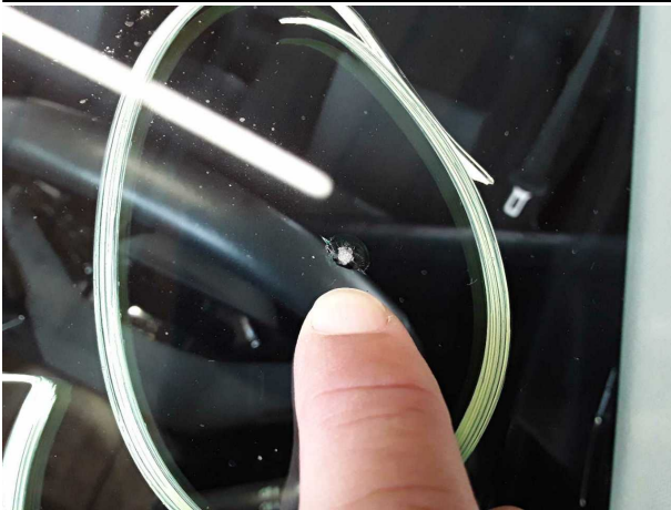
Beschädigung #5: Verglasung: Frontscheibe (Rissbildung) - Steinschlag - erneuern
