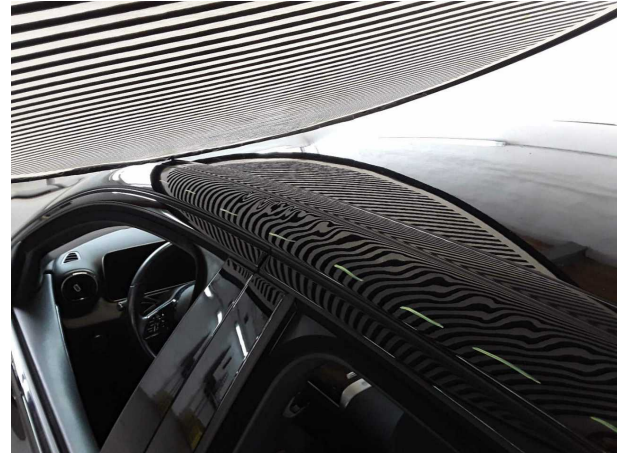
Beschädigung #4: Fahrzeugdach: Dachholm links - Delle / Lackschaden - instandsetzen und lackieren
