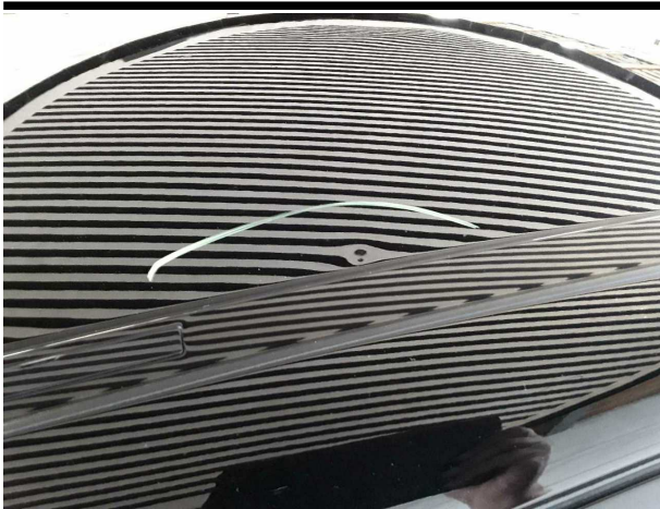
Beschädigung #3: Fahrzeugdach: Dach (2 Stück) - Delle(n) - sa... instandsetzen
