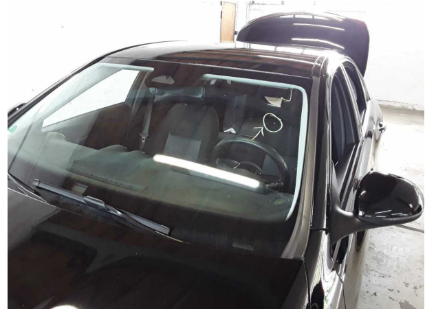
Beschädigung #5: Verglasung: Frontscheibe (Rissbildung) - Steinschlag - erneuern
