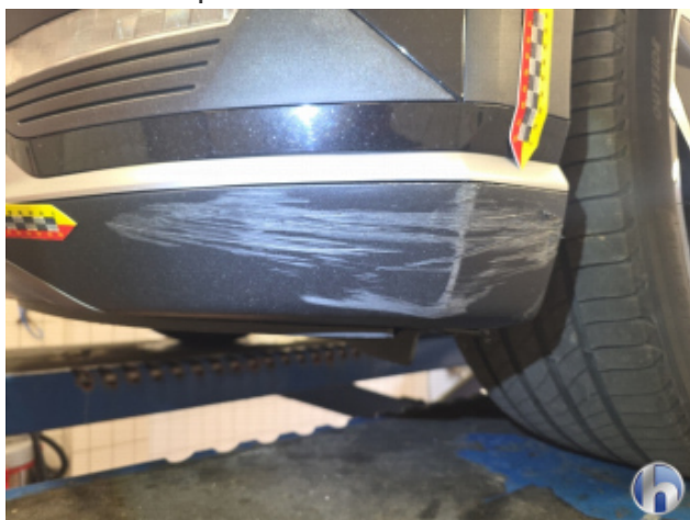
4. Stoßfänger Vorne Kratzer - Smart Repair
