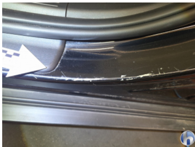
1. Einstiegsleiste Vorne - Links Kratzer Tief Bis Grundierung - Smart Repair
