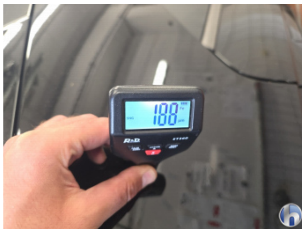
6. Seitenwand - Hinten - Rechts Nachlackiert - Ohne Reparatur
