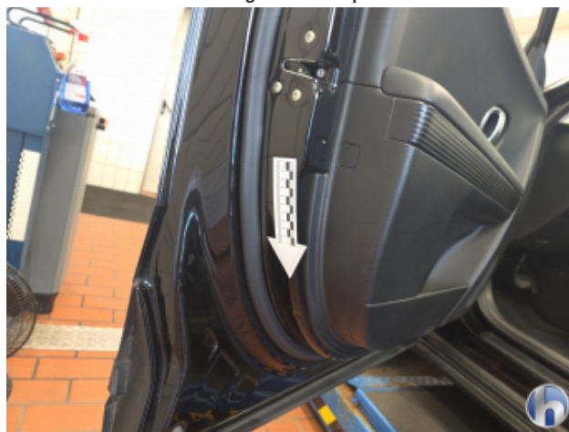
1. Einstiegsleiste Vorne - Links Kratzer Tief Bis Grundierung - Smart Repair
