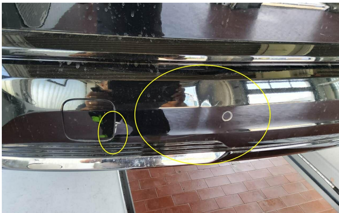
Bild 24 : Stossfänger hinten deformiert,
