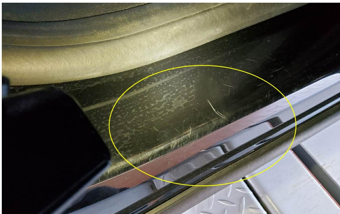
Bild 28 : Tür hinten rechts Einstieg, zerkratzt, Gebrauchsspur
