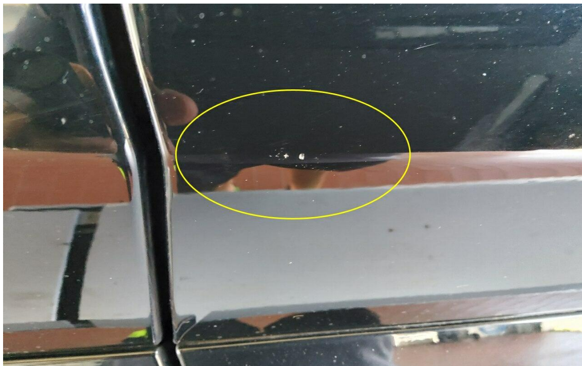
Bild 29 : Türe vorne rechts zerkratzt,
