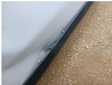
Aleta / Trasero Izquierdo / Abolladura
