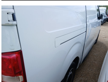
Aleta / Trasero Derecho / Abolladura
