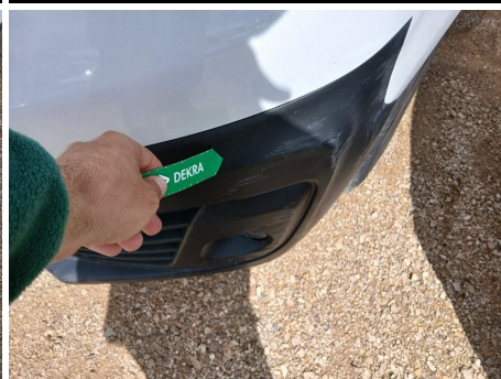
Paragolpes inferior / Delantero / Ralladura
