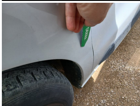
Aleta / Delantero Izquierdo / Abolladura
