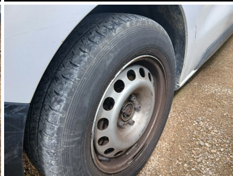
Embellecedor de tuerca de rueda / Delantero Izquierdo / Faltante
