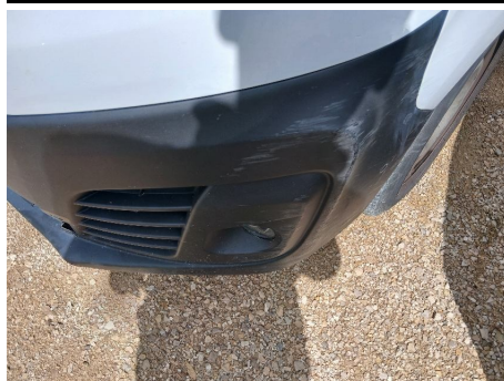
Paragolpes inferior / Delantero / Ralladura
