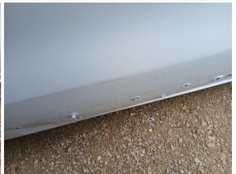
Moldura de puerta / Delantero Derecho / Faltante
