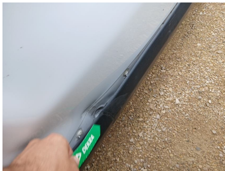
Moldura de aleta / Trasero Izquierdo / Ralladura
