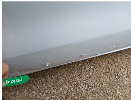
Moldura de puerta / Delantero Derecho / Faltante
