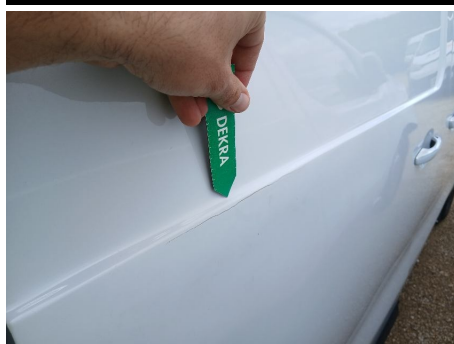
Puerta / Derecha / Abolladura
