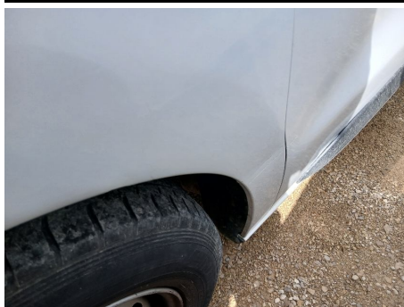
Aleta / Delantero Izquierdo / Abolladura
