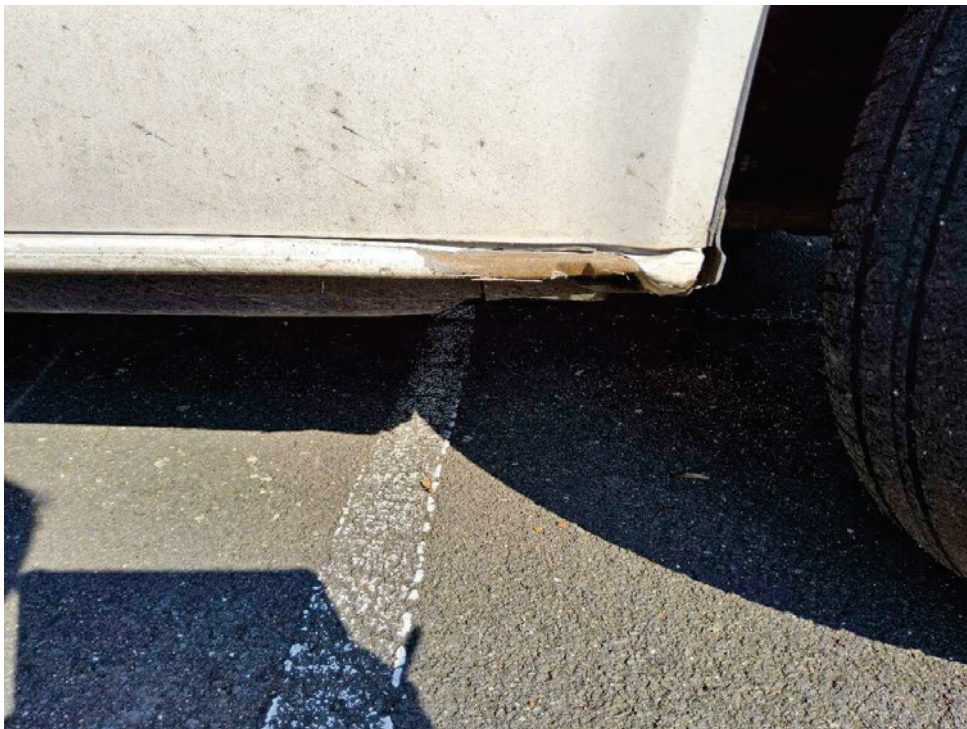
Bild 6 : Schweller rechts verformt
