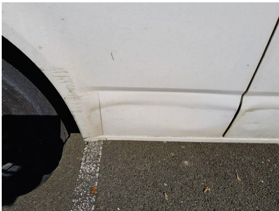
Bild 9 : Seitenwand rechts unterhalb verformt
