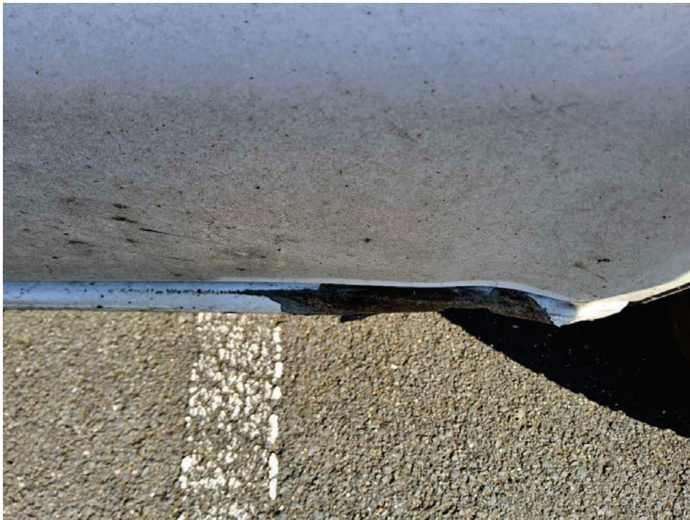
Bild 7 : Schweller rechts und Tür vorn rechts verformt
