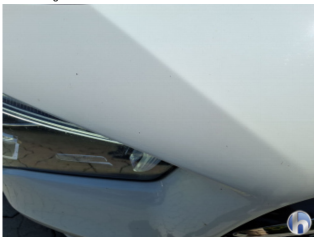
4. Stoßfänger Vorne Steinschlag - Lackieren
