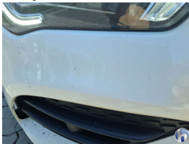
4. Stoßfänger Vorne Steinschlag - Lackieren
