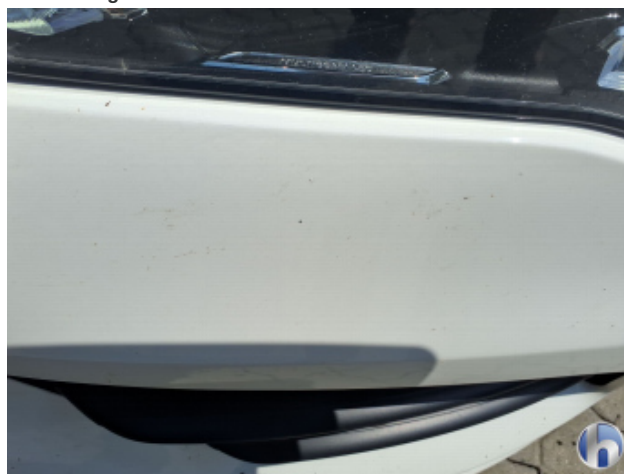
4. Stoßfänger Vorne Steinschlag - Lackieren
