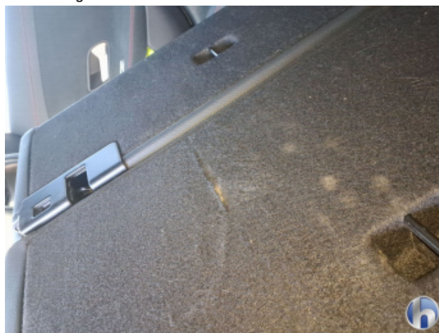
7. Sitz Innenraum links hinten Beschädigt - Erneuern
