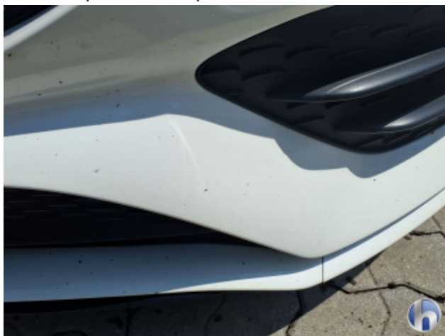
4. Stoßfänger Vorne Steinschlag - Lackieren
