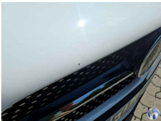
4. Stoßfänger Vorne Steinschlag - Lackieren
