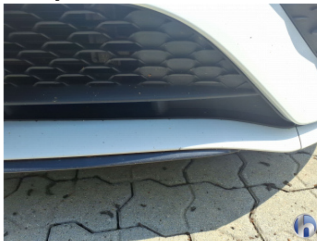
4. Stoßfänger Vorne Steinschlag - Lackieren
