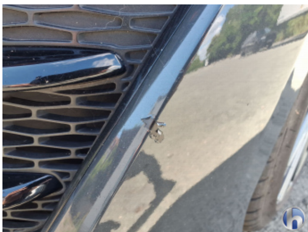
2. Stoßfänger Vorne Lackabplatzer - Lackieren
