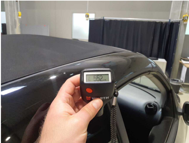
Nachlackierung 1: Dachholm rechts
