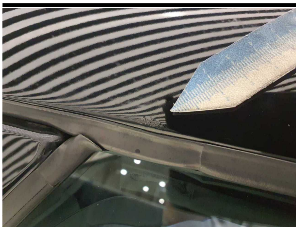
Beschädigung #6: Fahrzeugdach: Dachholm rechts - nicht fachgerecht instandgesetzt - instandsetzen und lackieren
