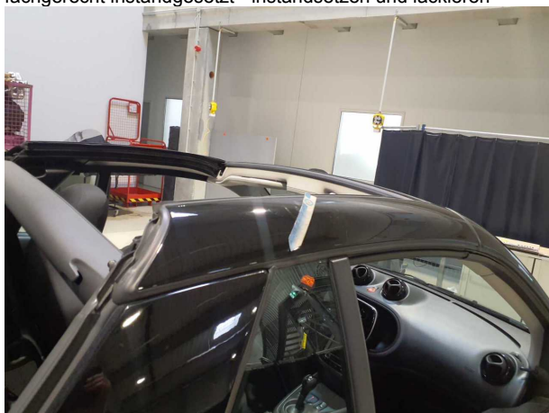
Beschädigung #6: Fahrzeugdach: Dachholm rechts - nicht fachgerecht instandgesetzt - instandsetzen und lackieren
