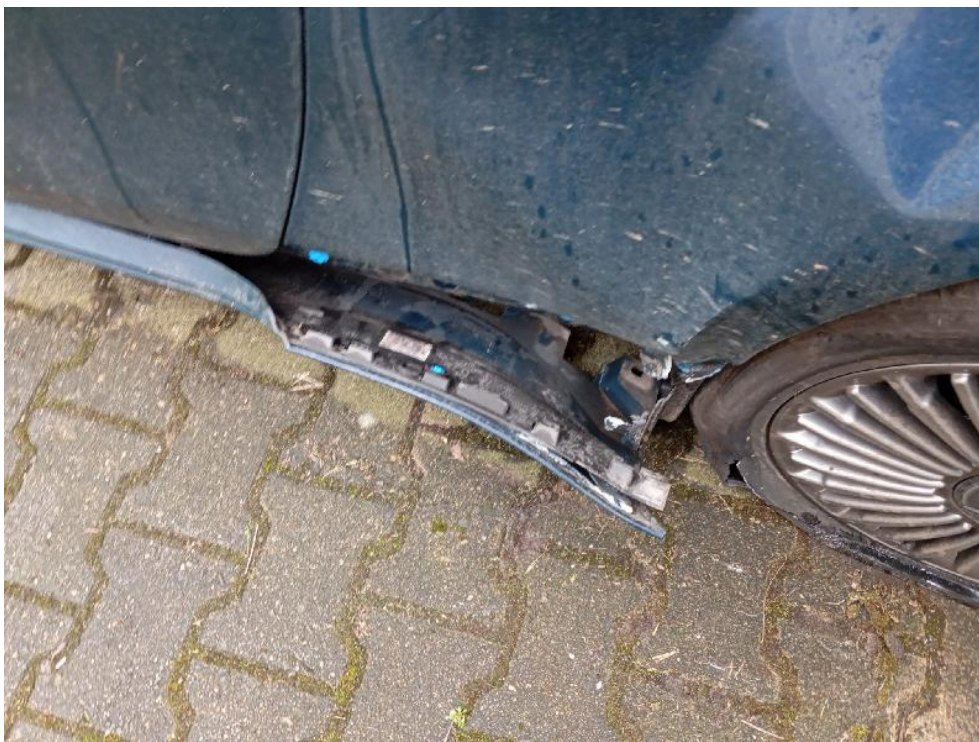
Bild: 13 Seitenwand links verformt
