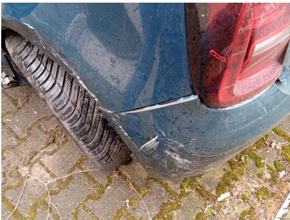
Bild: 21 Stoßfänger hinten ausgebrochen und verschrammt
