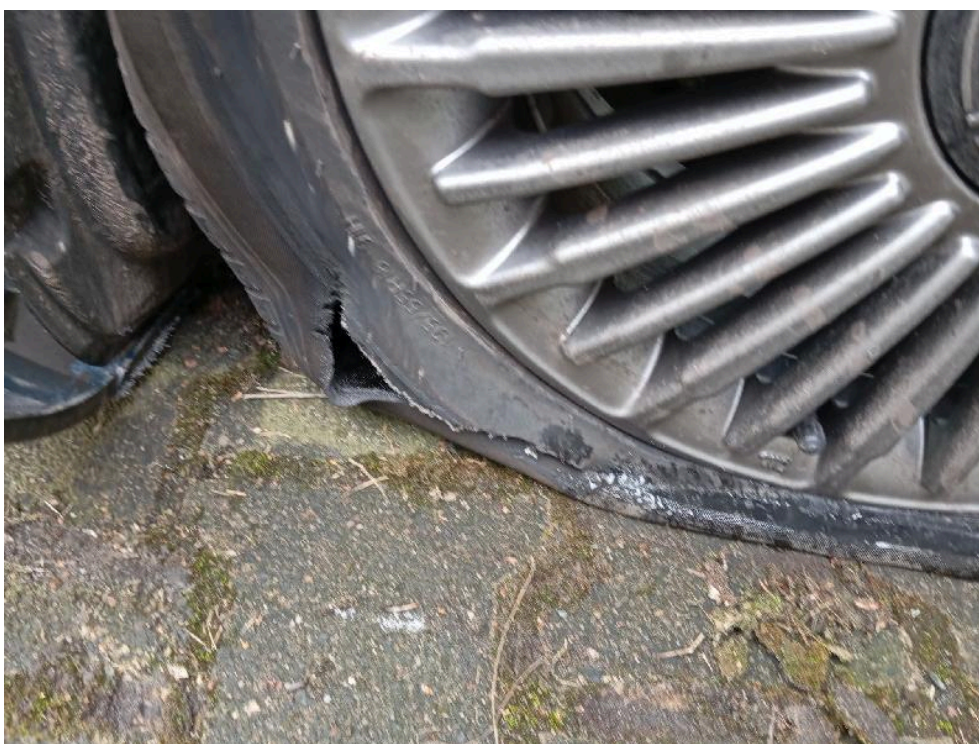
Bild: 14 Reifen hinten links defekt
