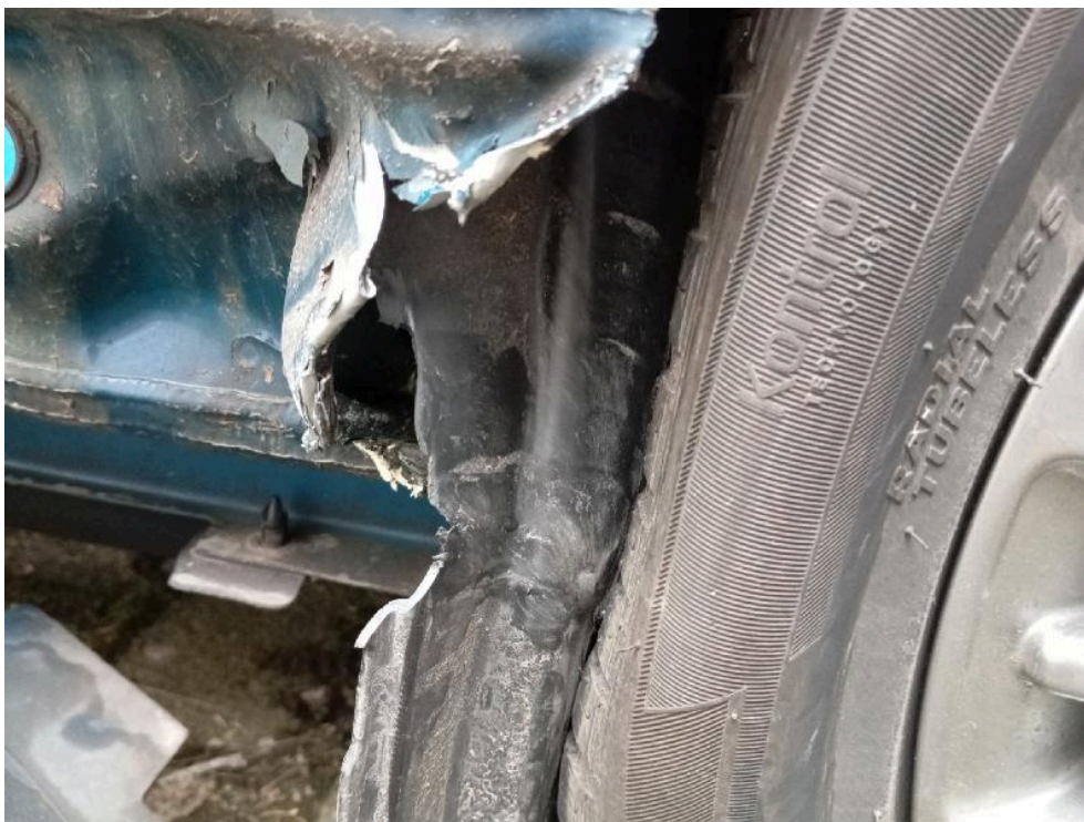
Bild: 19 Seitenwand links aufgerissen
