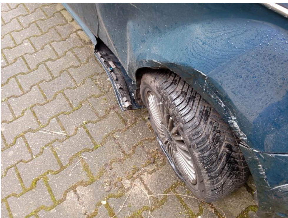
Bild: 12 Seitenwand links verformt Rad hinten links Fehlstellung
