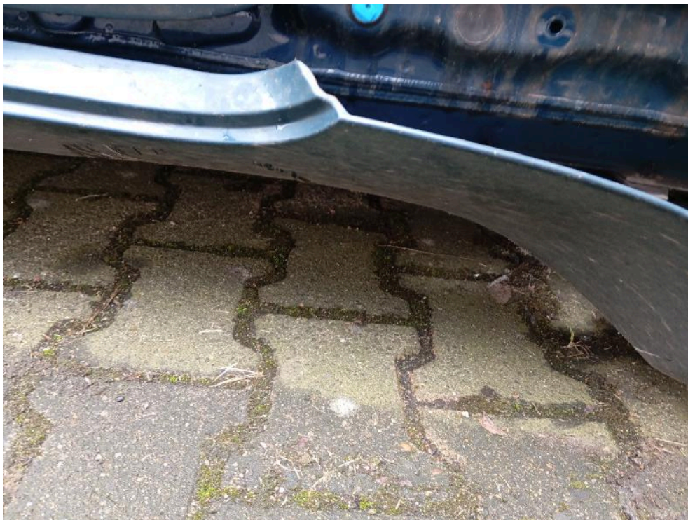
Bild: 17 Schwellerverkleidung links ausgebrochen
