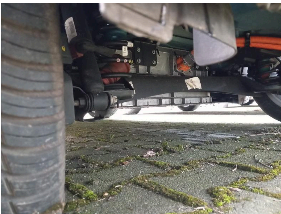
Bild: 20 Hinterachse verformt
