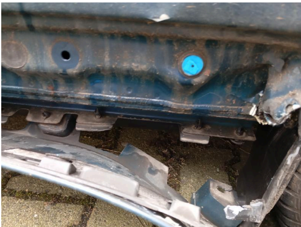
Bild: 16 Schweller links verformt
