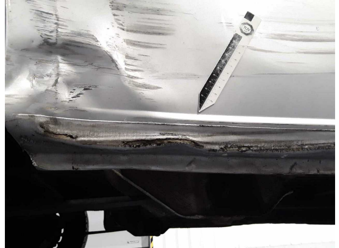
Beschädigung 21: Schweller rechts: Schweller - beschädigt - erneuern
