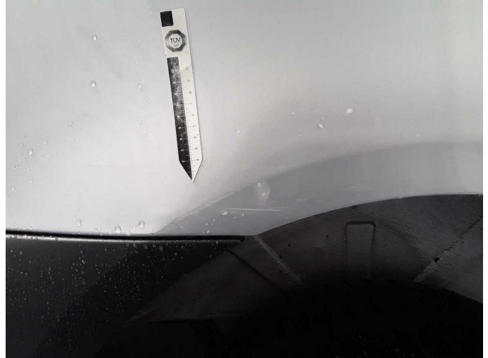
Beschädigung 10: Seitenwand links: Seitenwand - Delle / Lackschaden - instandsetzen/lackieren (S3)
