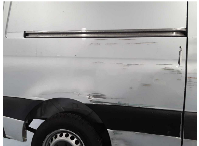
Beschädigung 30: Seitenwand rechts: Seitenwand - beschädigt - erneuern
