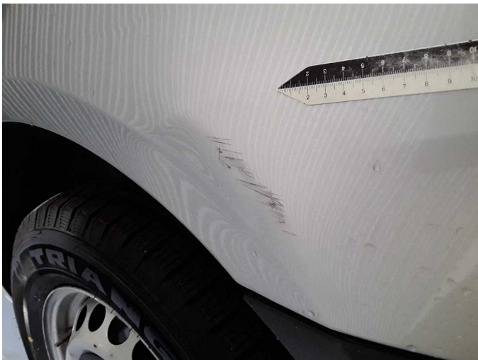
Beschädigung 25: Kotflügel rechts: Kotflügel rechts - verformt - instandsetzen/lackieren (S3)
