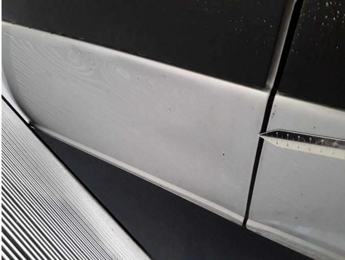
Beschädigung 9: Schweller links: Schweller - verformt - erneuern
