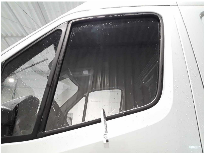
Beschädigung 7: Verglasung: Türscheibe vorn links - verkratzt / verschürft - aufbereiten
