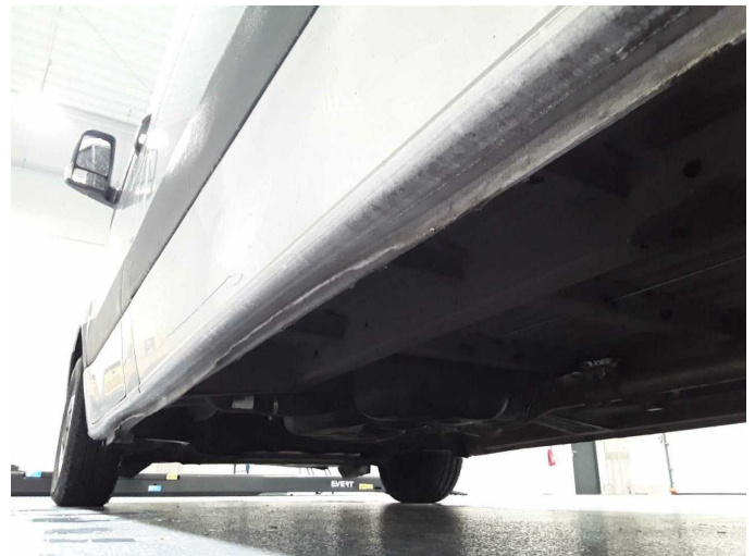
Beschädigung 9: Schweller links: Schweller - verformt - erneuern
