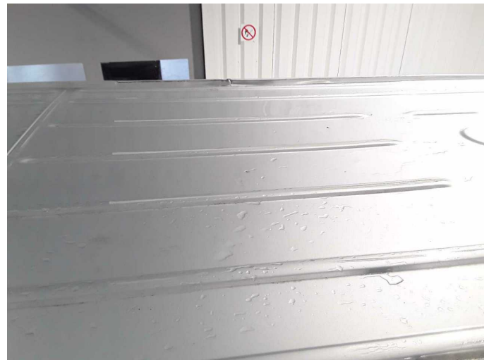
Beschädigung 37: Fahrzeugdach: Dach - verkratzt / verschürft - erneuern
