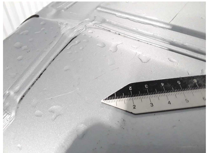
Beschädigung 34: Koffer: Dachabschlußprofil - Kratzer - lackieren
