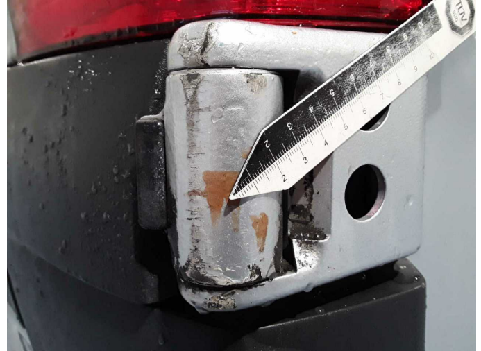
Beschädigung 12: Heckklappe/-tür: Scharnier - verkratzt / verschürft - lackieren
