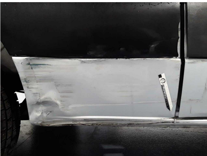
Beschädigung 21: Schweller rechts: Schweller - beschädigt - erneuern
