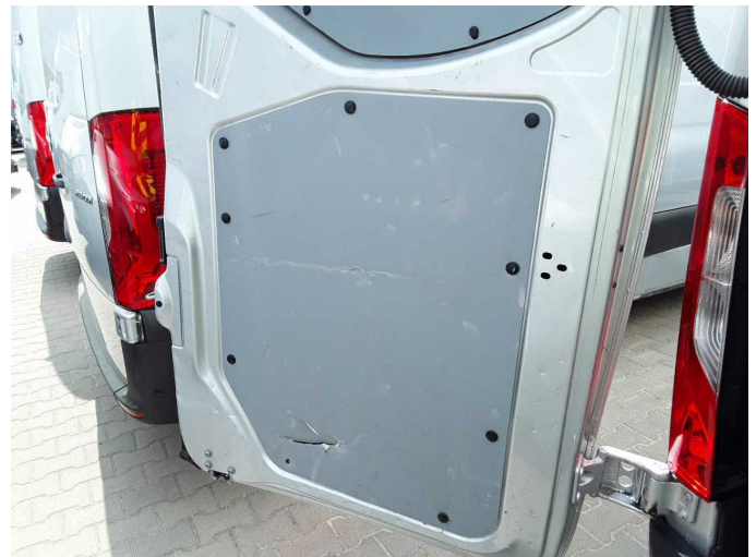
Beschädigung 3: Heckklappe/-tür: Verkl. Hecktür Sperrholz unten - beschädigt - erneuern
