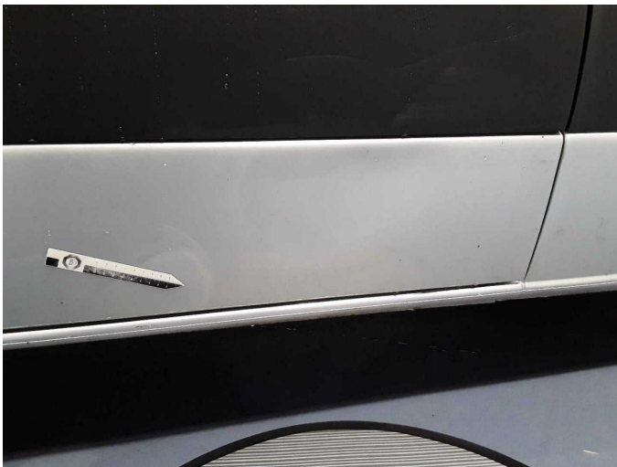
Beschädigung 22: Schiebetür rechts: Schiebetür - beschädigt - erneuern
