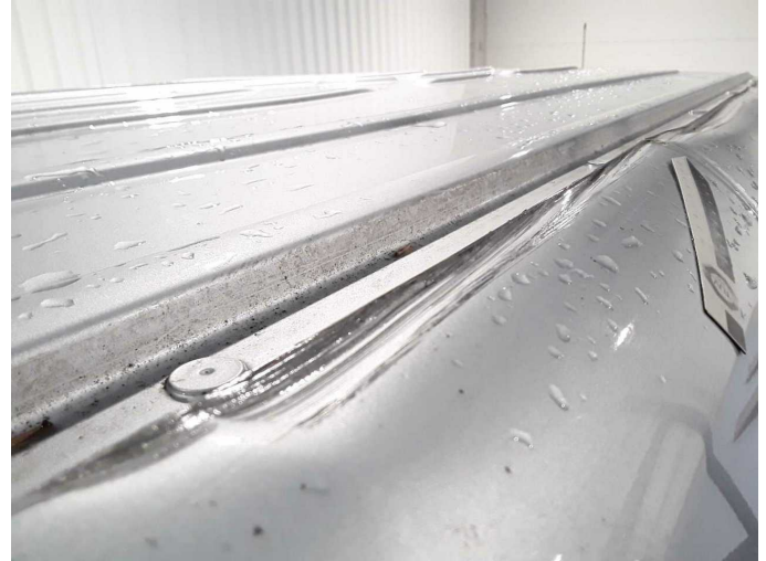
Beschädigung 37: Fahrzeugdach: Dach - verkratzt / verschürft - erneuern
