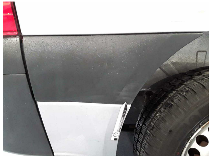
Beschädigung 19: Seitenwand rechts: Schutzleiste - verkratzt / verschürft - erneuern
