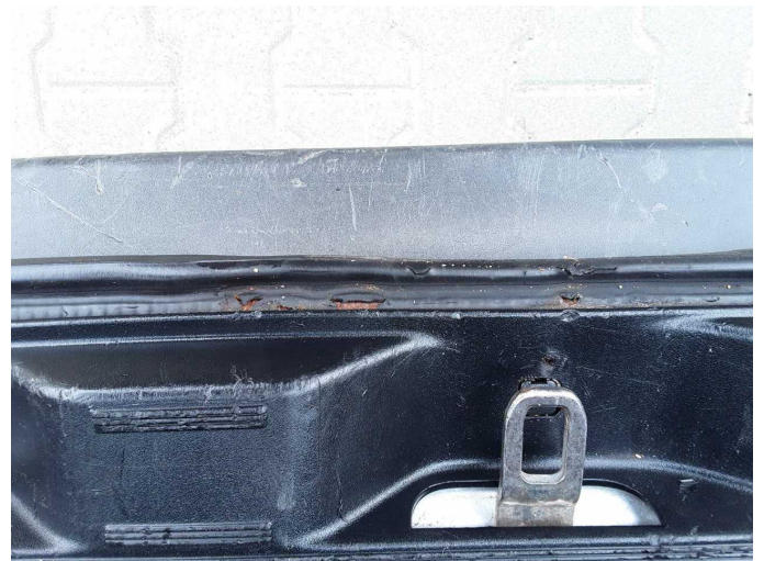
Beschädigung 5: Heckklappe/-tür: Dichtung - beschädigt - erneuern
