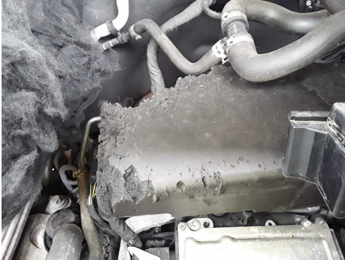
Beschädigung 2: Motor: Motorabdeckung - beschädigt - erneuern
