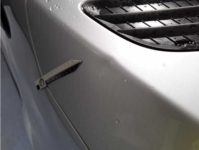
Beschädigung 31: Motorhaube: Motorhaube - Delle / Lackschaden - instandsetzen/lackieren (S3)
