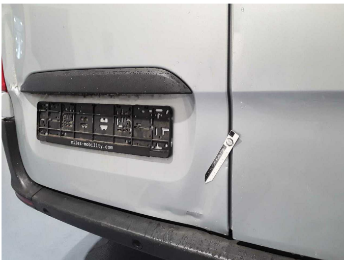
Beschädigung 14: Heckklappe/-tür: Hecktür links - beschädigt - erneuern
