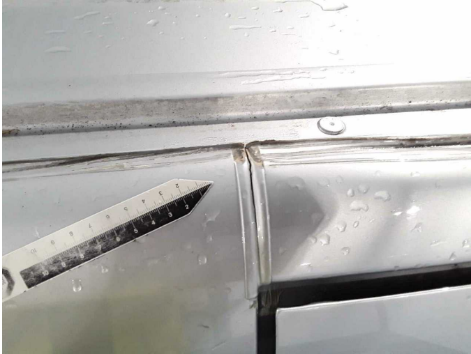
Beschädigung 37: Fahrzeugdach: Dach - verkratzt / verschürft - erneuern
