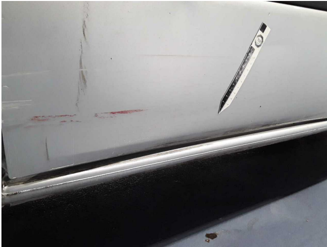
Beschädigung 22: Schiebetür rechts: Schiebetür - beschädigt - erneuern
