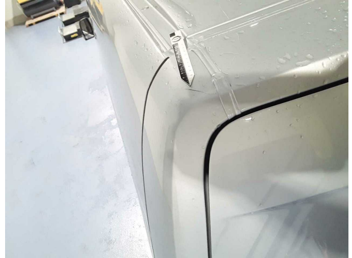
Beschädigung 35: Karosserie: C-Säule links - Kratzer - lackieren
