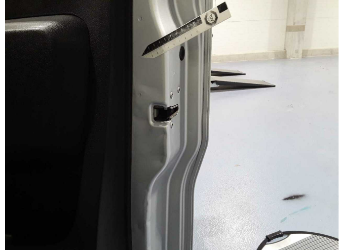
Beschädigung 27: Tür vorn rechts: Tür - Delle / Lackschaden - Smart Repair
