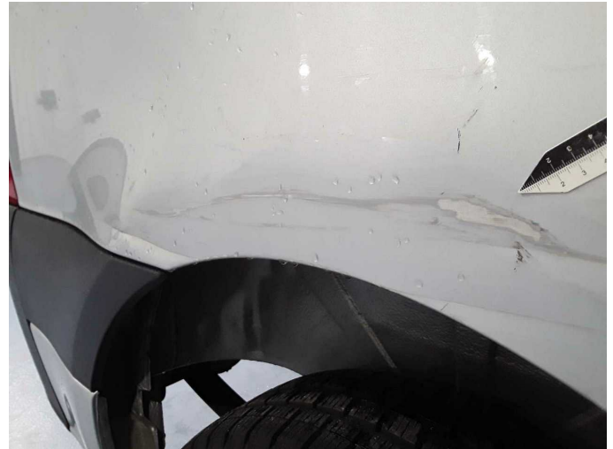
Beschädigung 30: Seitenwand rechts: Seitenwand - beschädigt - erneuern
