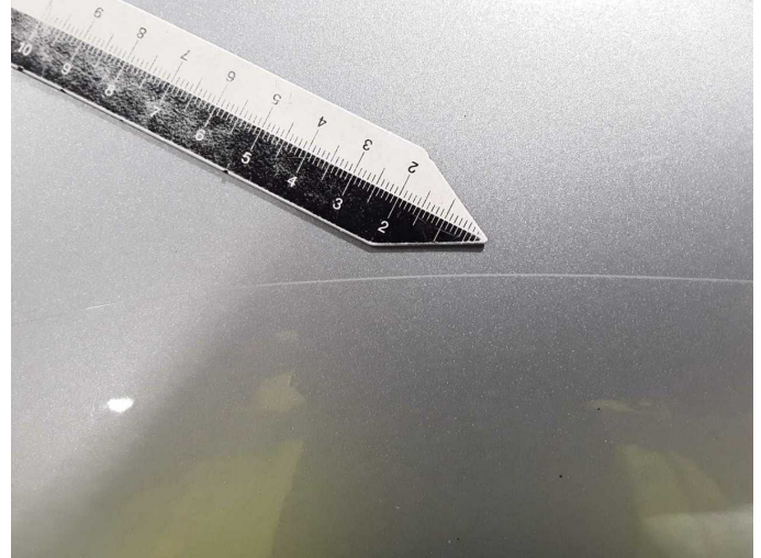
Beschädigung 31: Motorhaube: Motorhaube - Delle / Lackschaden - instandsetzen/lackieren (S3)
