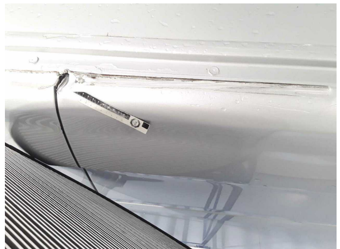
Beschädigung 36: Fahrzeugdach: Dachholm links - beschädigt - erneuern
