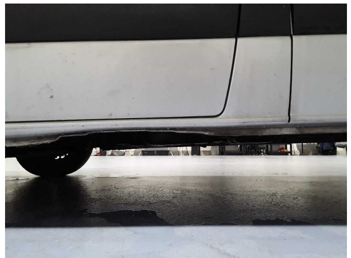
Beschädigung 9: Schweller links: Schweller - verformt - erneuern
