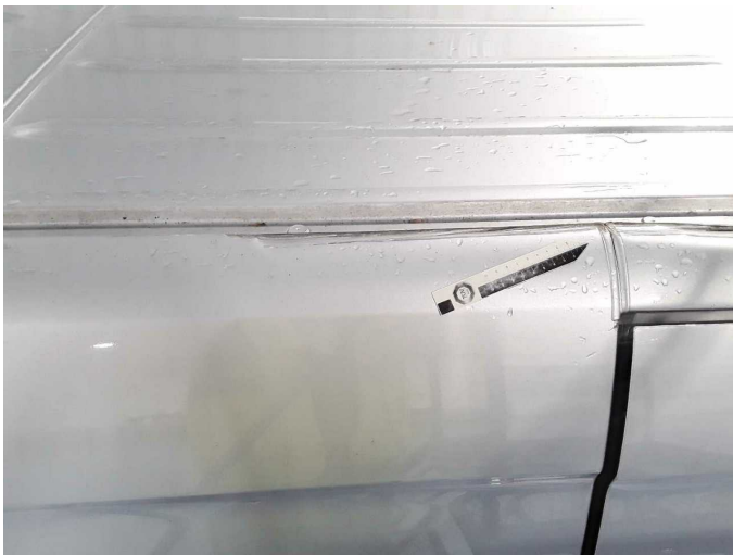
Beschädigung 37: Fahrzeugdach: Dach - verkratzt / verschürft - erneuern
