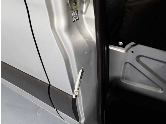
Beschädigung 26: Schweller rechts: Einstieg - Delle / Lackschaden - Smart Repair
