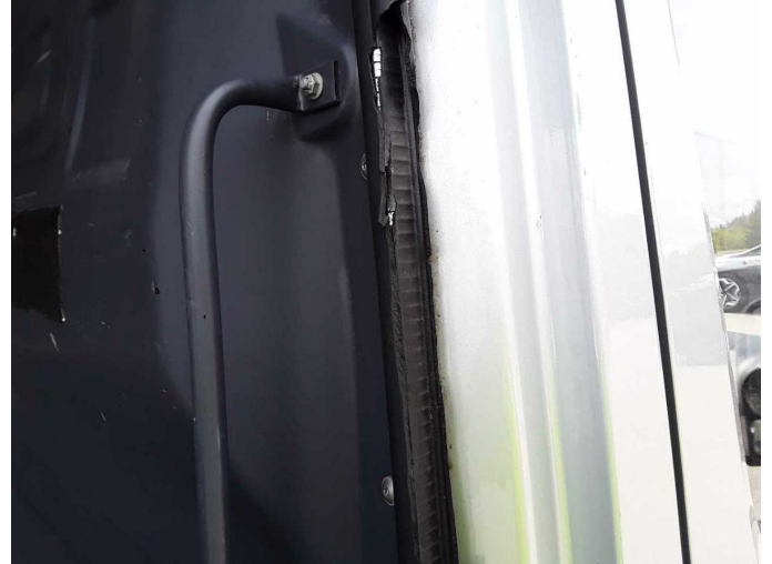
Beschädigung 4: Schiebetür rechts: Türdichtung - beschädigt - erneuern
