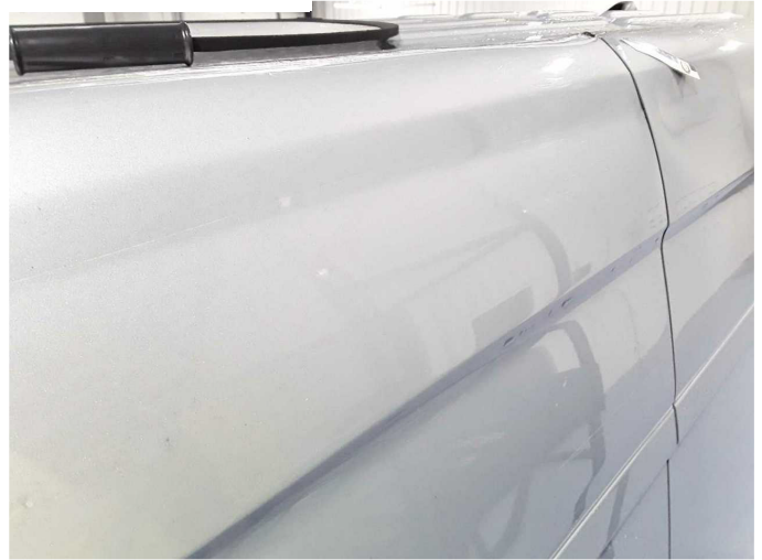
Beschädigung 36: Fahrzeugdach: Dachholm links - beschädigt - erneuern
