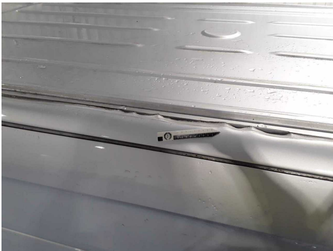
Beschädigung 33: Fahrzeugdach: Dachholm rechts - beschädigt - erneuern
