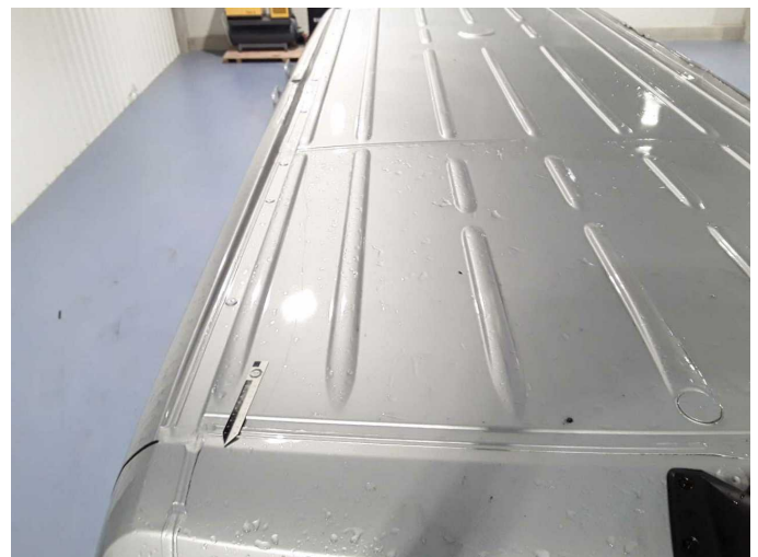
Beschädigung 34: Koffer: Dachabschlußprofil - Kratzer - lackieren
