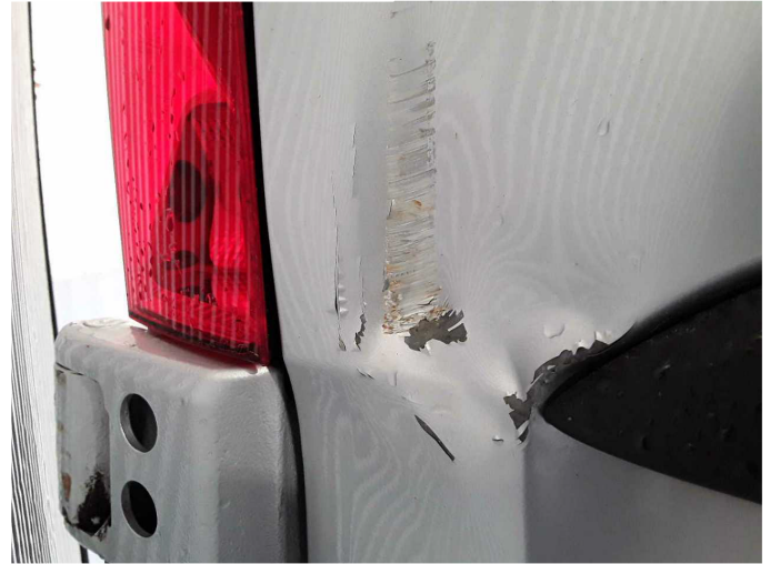
Beschädigung 14: Heckklappe/-tür: Hecktür links - beschädigt - erneuern
