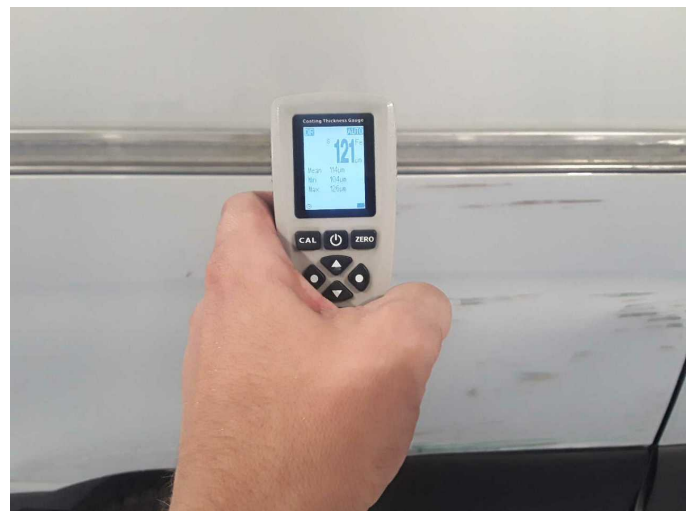
Seitenwand rechts: 121 μm
