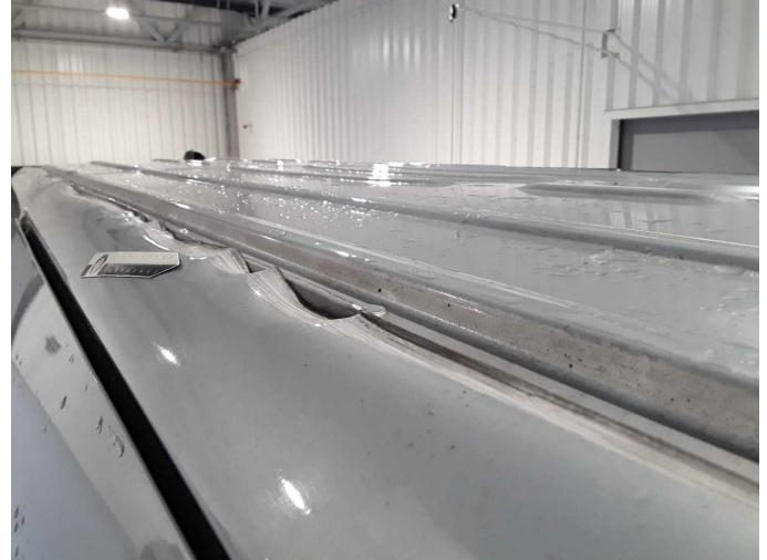
Beschädigung 33: Fahrzeugdach: Dachholm rechts - beschädigt - erneuern
