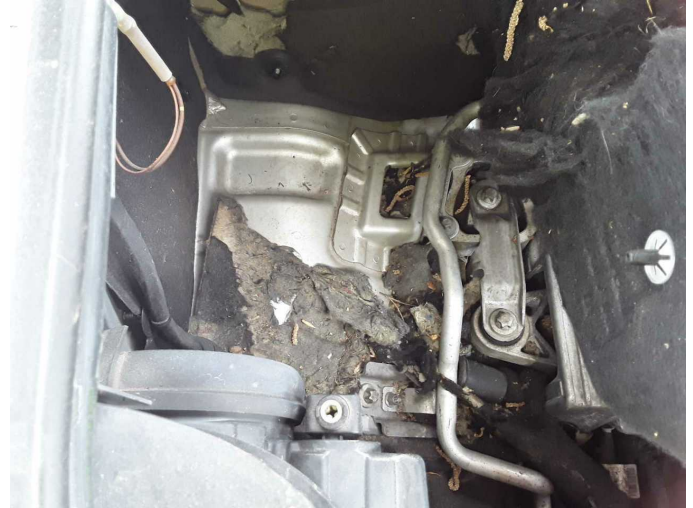
Beschädigung 2: Motor: Motorabdeckung - beschädigt - erneuern
