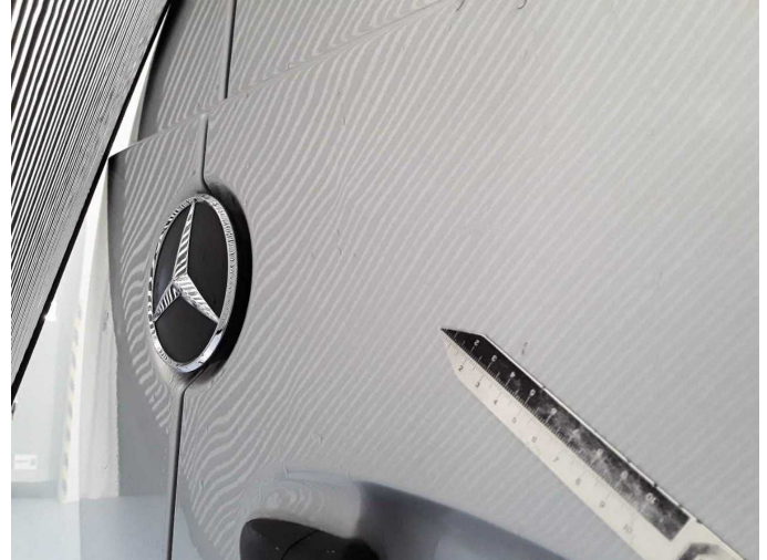
Beschädigung 15: Heckklappe/-tür: Hecktür rechts - Delle / Lackschaden - instandsetzen/lackieren (S3)
