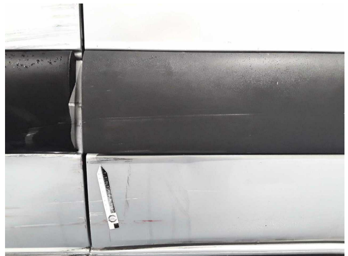
Beschädigung 23: Schiebetür rechts: Schutzleiste - beschädigt - erneuern
