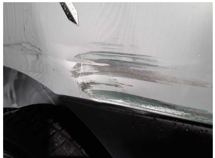
Beschädigung 30: Seitenwand rechts: Seitenwand - beschädigt - erneuern
