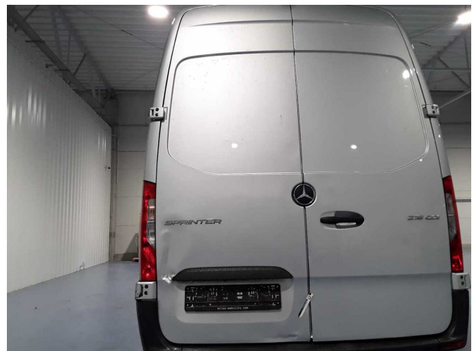
Beschädigung 14: Heckklappe/-tür: Hecktür links - beschädigt - erneuern
