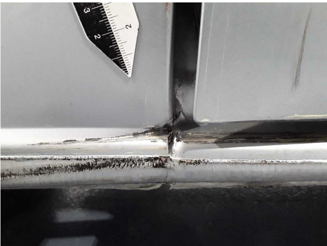
Beschädigung 21: Schweller rechts: Schweller - beschädigt - erneuern
