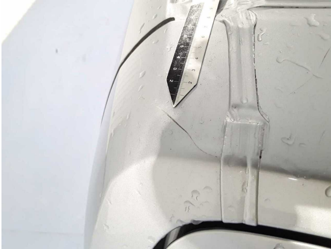
Beschädigung 35: Karosserie: C-Säule links - Kratzer - lackieren
