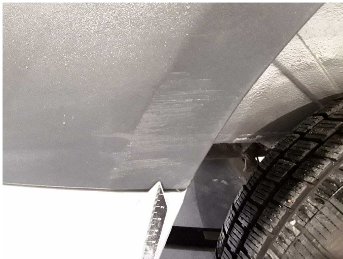
Beschädigung 19: Seitenwand rechts: Schutzleiste - verkratzt / verschürft - erneuern
