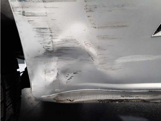
Beschädigung 21: Schweller rechts: Schweller - beschädigt - erneuern
