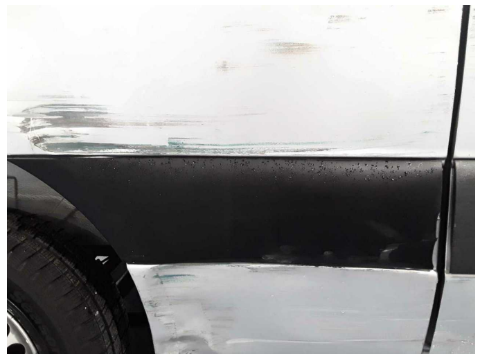
Beschädigung 20: Seitenwand rechts: Schutzleiste - gebrochen / gerissen - erneuern
