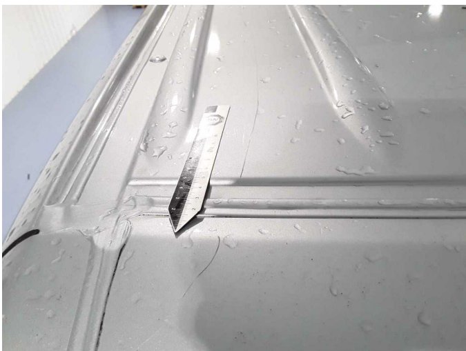
Beschädigung 34: Koffer: Dachabschlußprofil - Kratzer - lackieren
