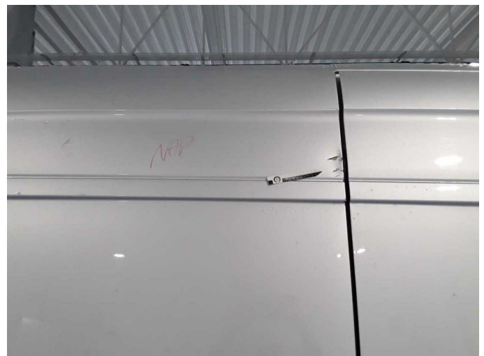
Beschädigung 30: Seitenwand rechts: Seitenwand - beschädigt - erneuern
