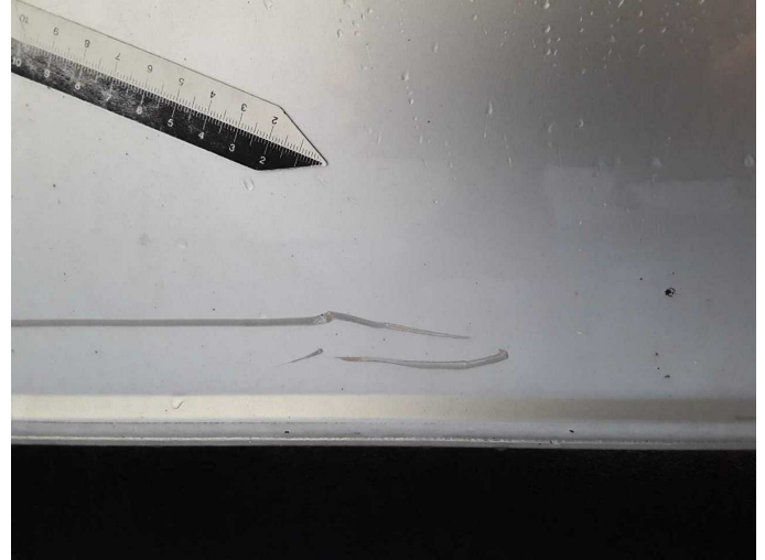
Beschädigung 9: Schweller links: Schweller - verformt - erneuern
