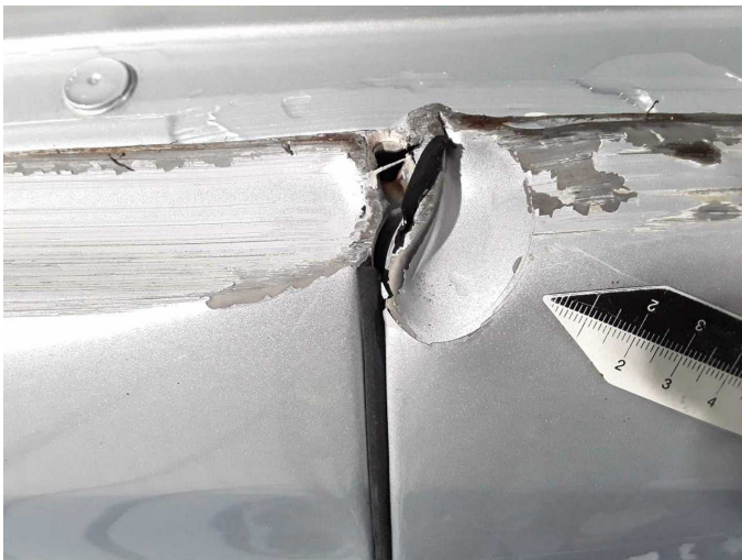
Beschädigung 36: Fahrzeugdach: Dachholm links - beschädigt - erneuern
