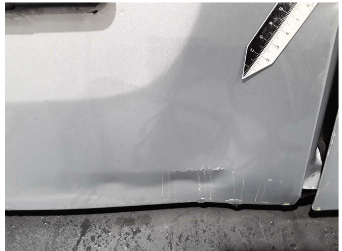
Beschädigung 14: Heckklappe/-tür: Hecktür links - beschädigt - erneuern
