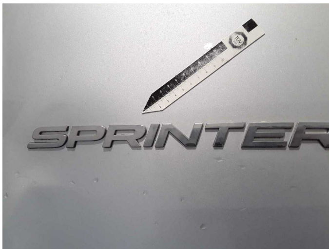
Beschädigung 16: Heckklappe/-tür: Emblem - beschädigt - erneuern
