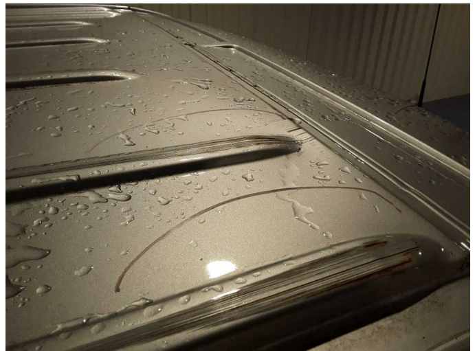
Beschädigung 37: Fahrzeugdach: Dach - verkratzt / verschürft - erneuern
