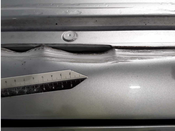
Beschädigung 33: Fahrzeugdach: Dachholm rechts - beschädigt - erneuern
