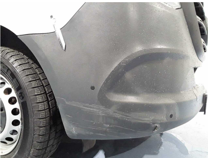
Beschädigung 32: Stossfänger vorn: Stossfänger vorn (unlackiert) - gebrochen / gerissen - erneuern
