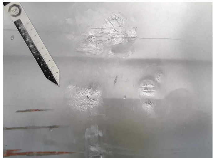
Beschädigung 22: Schiebetür rechts: Schiebetür - beschädigt - erneuern
