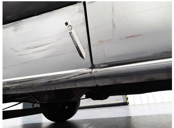
Beschädigung 21: Schweller rechts: Schweller - beschädigt - erneuern
