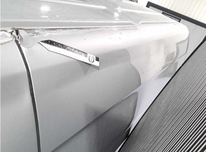
Beschädigung 36: Fahrzeugdach: Dachholm links - beschädigt - erneuern
