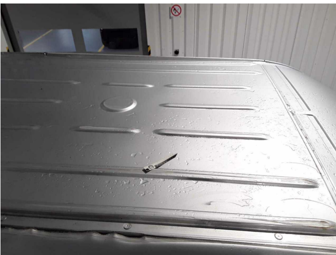
Beschädigung 37: Fahrzeugdach: Dach - verkratzt / verschürft - erneuern
