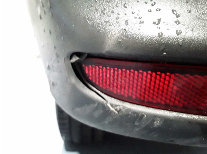
Beschädigung 18: Heckleuchte: Heckleuchte (LED) links - beschädigt - erneuern
