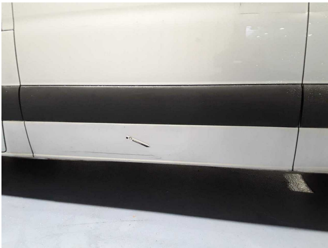
Beschädigung 9: Schweller links: Schweller - verformt - erneuern
