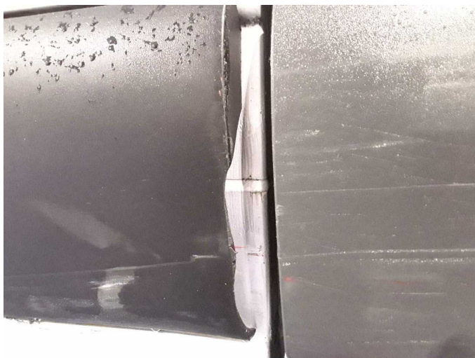
Beschädigung 20: Seitenwand rechts: Schutzleiste - gebrochen / gerissen - erneuern
