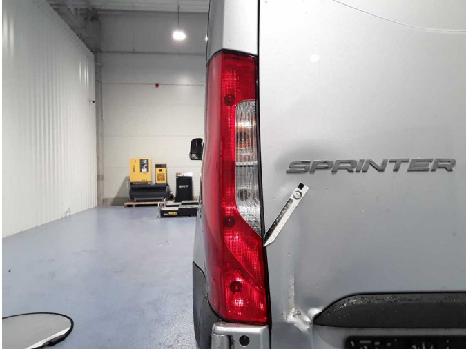
Beschädigung 11: Heckleuchte: Heckleuchte links (Sicherheitsrelevant) - verkratzt / verschürft - erneuern
