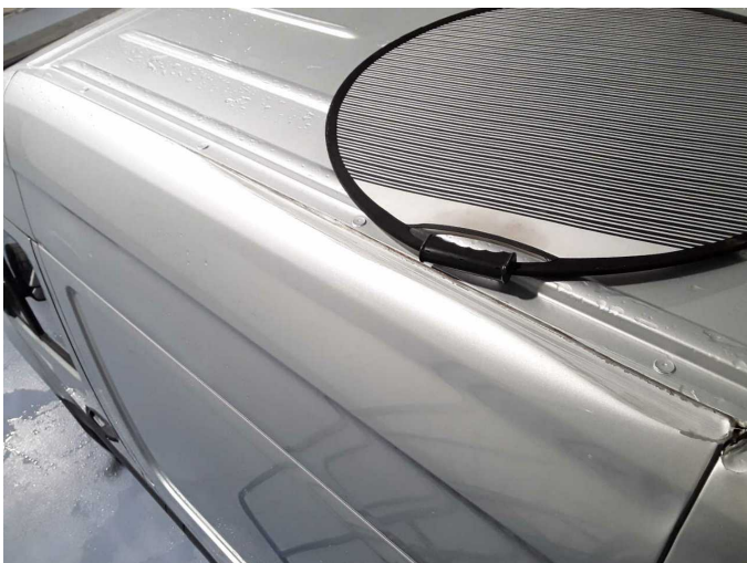
Beschädigung 36: Fahrzeugdach: Dachholm links - beschädigt - erneuern
