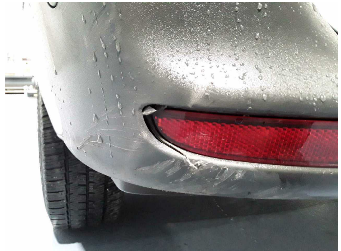
Beschädigung 13: Stossfänger hinten: Schutzleiste links - gebrochen / gerissen - erneuern
