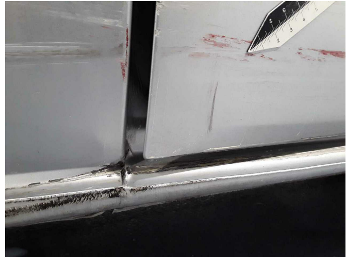
Beschädigung 22: Schiebetür rechts: Schiebetür - beschädigt - erneuern
