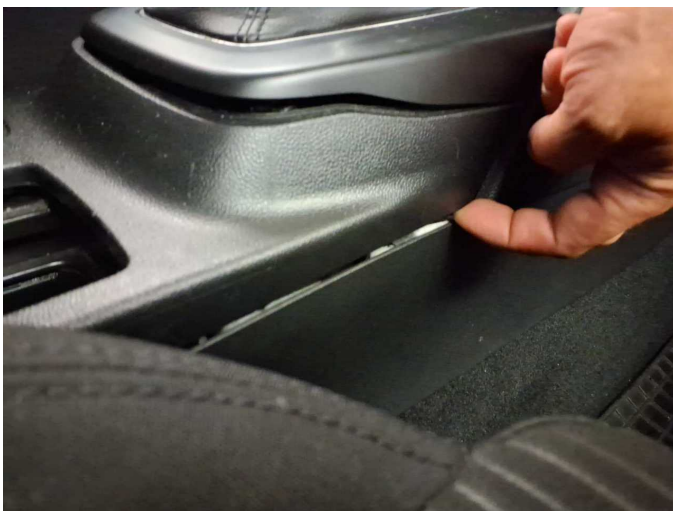
Damage 9: Instrument panel: Centre console - front (Evtl. Mehrkosten) - Loose - Un- / install
