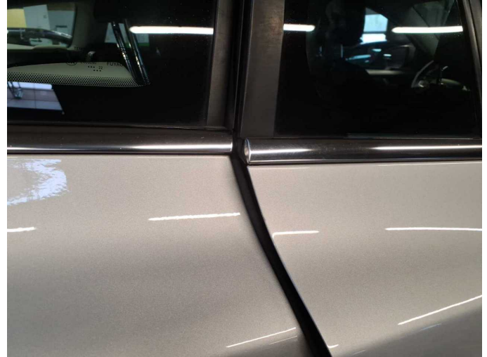
Damage 10: Door - rear right side: Door (Hängt durch, liegt nicht richtig an) - Malposition - Set / adjust
