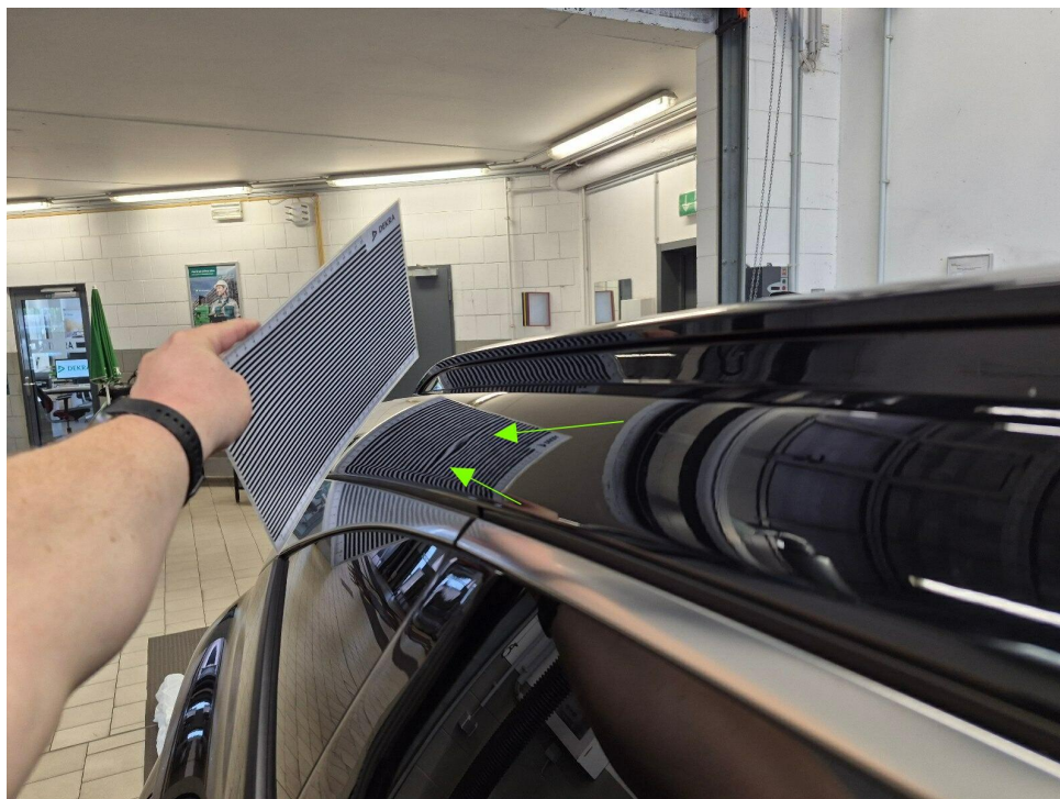
Bild 12 : Dachrahmen rechts Dellen
