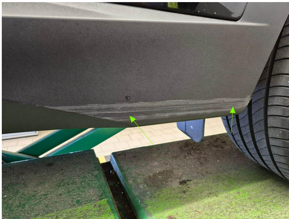
Bild 8 : Tür hinten links Blende verschrammt
