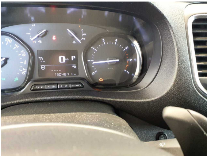
Damage 13: Engine: Engine (MKL an, AGR Ventil mit Abgaskühler muss ersetzt werden) - Sub-function - repair according to calculation
