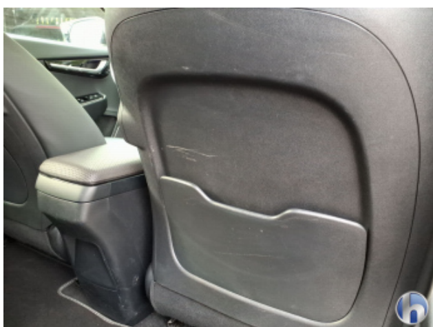
1. Verkleidung Verschmutzt - Reinigen
