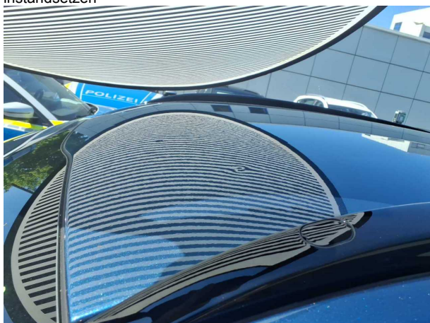
Beschädigung #7: Karosserie: Karosserie - Hagelschaden - sanft instandsetzen
