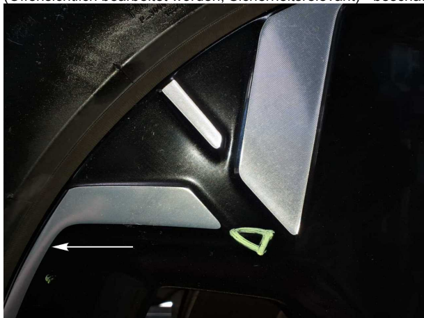
Beschädigung #5: Rad/Reifen: Leichtmetallfelge vorn rechts (Offensichtlich bearbeitet worden, Sicherheitsrelevant) - beschädigt
