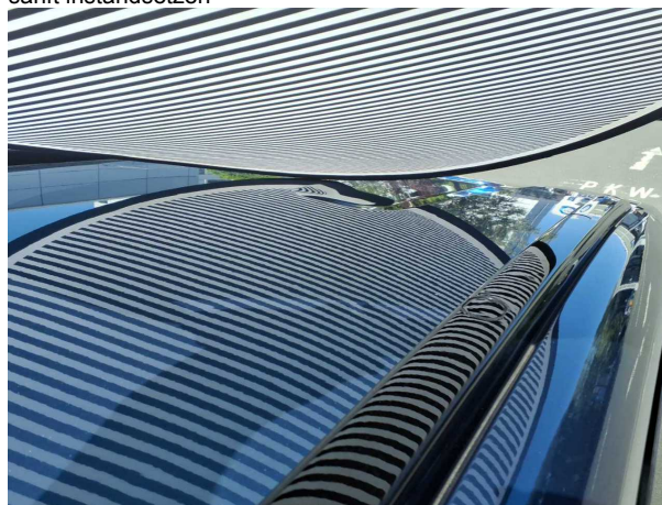
Beschädigung #7: Karosserie: Karosserie - Hagelschaden - sanft instandsetzen
