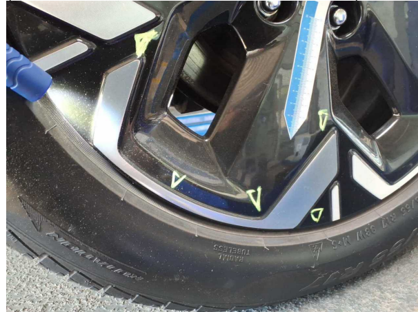
Beschädigung #3: Rad/Reifen: Leichtmetallfelge hinten rechts (Offensichtlich bearbeitet worden, Sicherheitsrelevant) -
