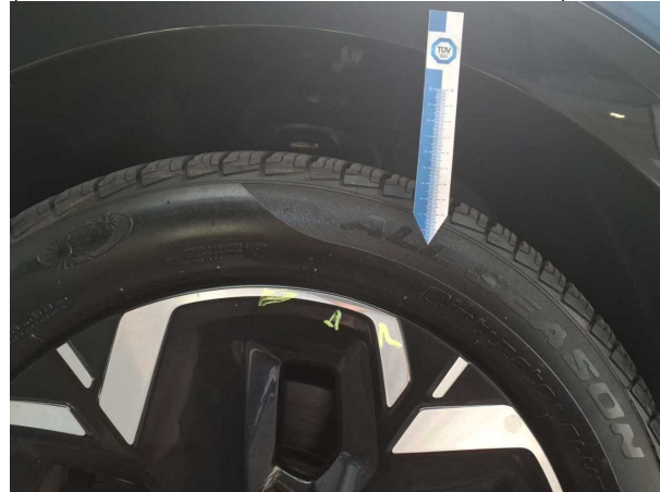
Beschädigung #4: Rad/Reifen: Leichtmetallfelge vorn links (Offensichtlich bearbeitet worden, Sicherheitsrelevant) -
