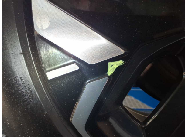
Beschädigung #3: Rad/Reifen: Leichtmetallfelge hinten rechts (Offensichtlich bearbeitet worden, Sicherheitsrelevant) - beschädigt
