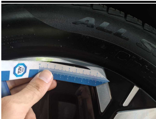
Beschädigung #4: Rad/Reifen: Leichtmetallfelge vorn links (Offensichtlich bearbeitet worden, Sicherheitsrelevant) - beschädigt
