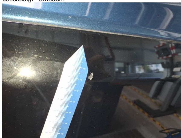
Beschädigung #2: Tür vorn rechts: Zierleiste unten - beschädigt - erneuern
