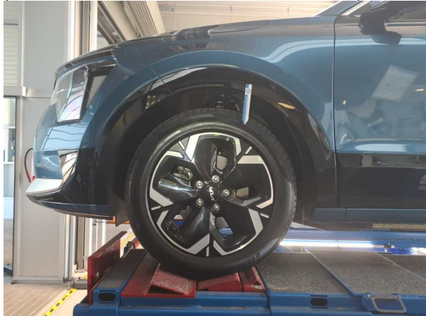
Beschädigung #4: Rad/Reifen: Leichtmetallfelge vorn links (Offensichtlich bearbeitet worden, Sicherheitsrelevant) - beschädigt
