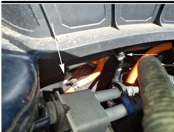
Beschädigung #6: Fahrerhaus: Dämmmatte - Marderschaden - erneuern
