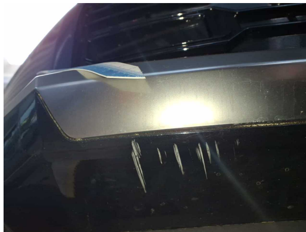
Beschädigung #1: Stossfänger vorn: Spoiler - verkratzt / verschürft - Smart Repair
