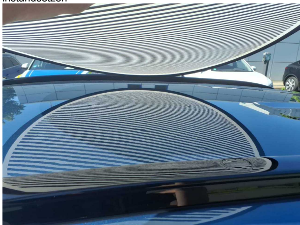
Beschädigung #7: Karosserie: Karosserie - Hagelschaden - sanft instandsetzen
