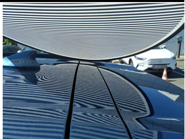
Beschädigung #7: Karosserie: Karosserie - Hagelschaden - sanft instandsetzen
