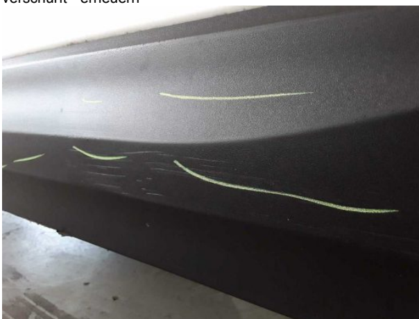
Beschädigung #15: Tür vorn rechts: Zierleiste unten - verkratzt / verschürft - erneuern
