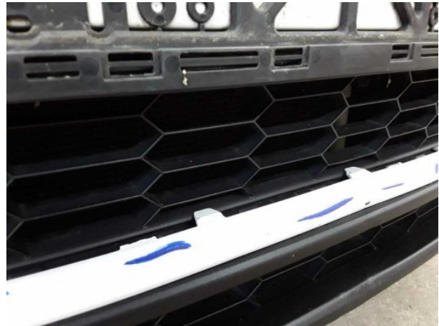
Beschädigung #18: Stossfänger vorn: Grill - verformt - erneuern
