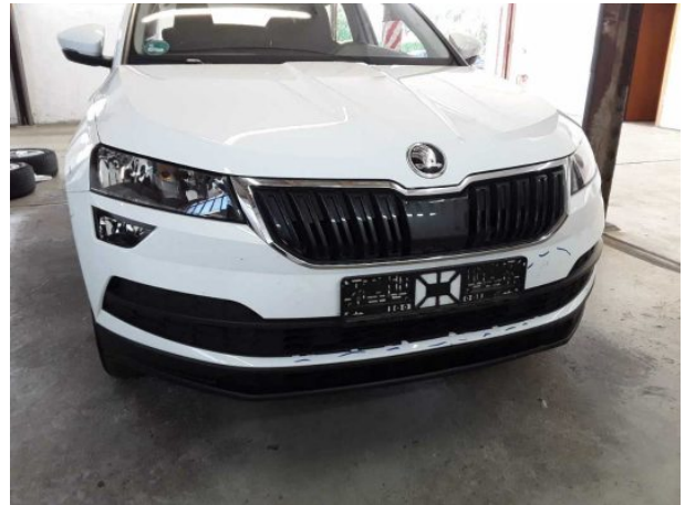
Beschädigung #23: Stossfänger vorn: Stossfänger vorn - beschädigt - erneuern
