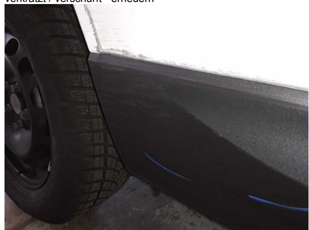
Beschädigung #16: Tür hinten rechts: Zierleiste unten - verkratzt / verschürft - erneuern
