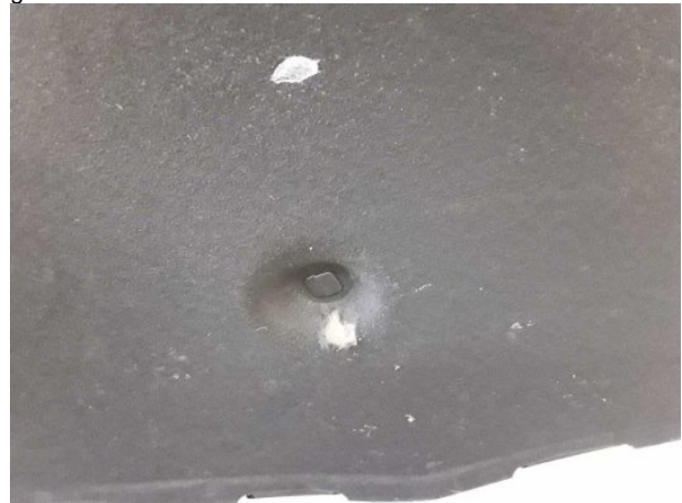
Beschädigung #6: Motorhaube: Dämmmatte - Marderschaden - erneuern
