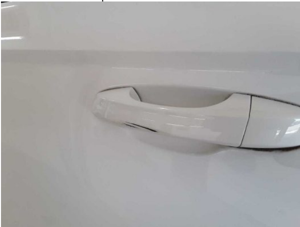
Beschädigung #11: Tür hinten links: Griff außen - verkratzt / verschürft - Smart Repair
