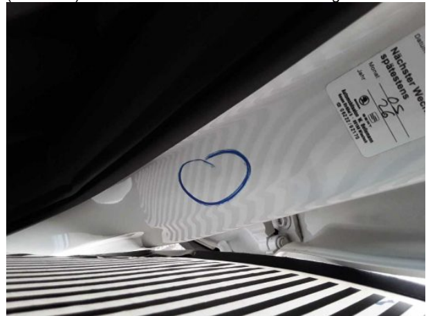
Beschädigung #8: Schweller links: Einstieg - Delle(n) - sanft instandsetzen
