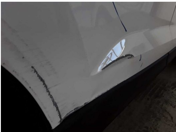
Beschädigung #24: Tür hinten rechts: Tür - verformt - erneuern
