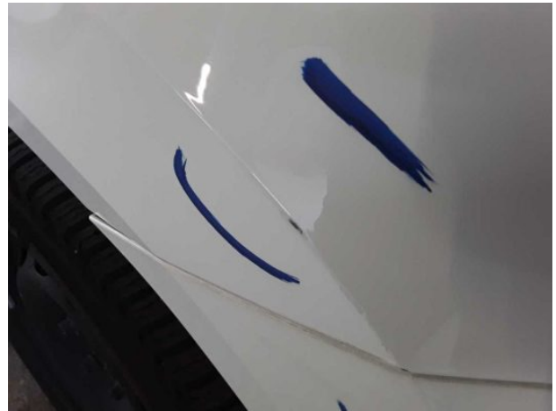
Beschädigung #10: Kotflügel rechts: Kotflügel rechts - verkratzt / verschürft - Smart Repair
