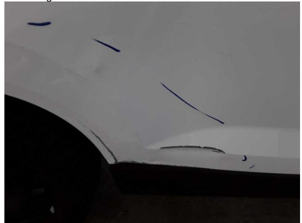
Beschädigung #24: Tür hinten rechts: Tür - verformt - erneuern
