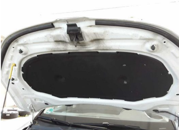
Beschädigung #6: Motorhaube: Dämmmatte - Marderschaden - erneuern
