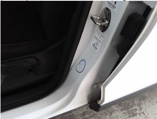
Beschädigung #8: Schweller links: Einstieg - Delle(n) - sanft instandsetzen
