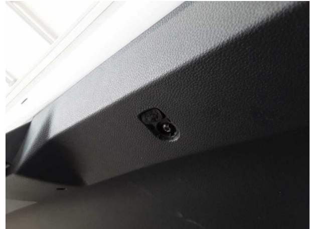
Damage #5: Boot lid / rear door: Door handle - inside - Broke... torn - Replace
