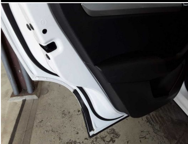
Beschädigung #17: Tür hinten links: Tür - Delle(n) - sanft instandsetzen
