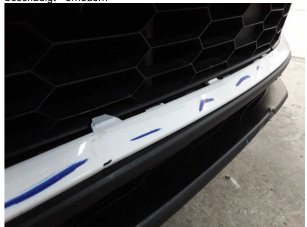
Beschädigung #23: Stossfänger vorn: Stossfänger vorn - beschädigt - erneuern
