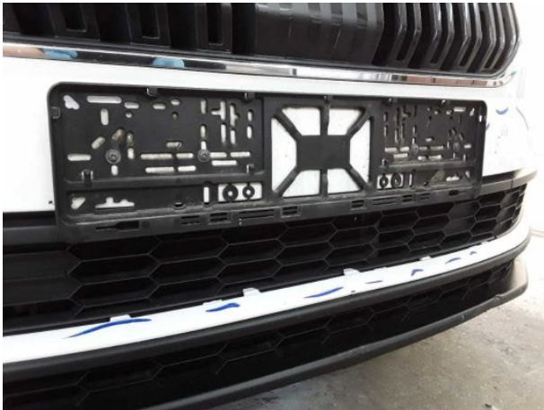
Beschädigung #18: Stossfänger vorn: Grill - verformt - erneuern
