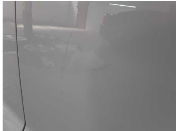
Beschädigung #22: Tür vorn rechts: Tür - Delle / Lackschaden - instandsetzen und lackieren
