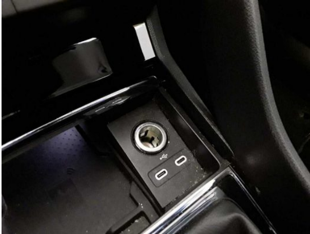
Beschädigung #3: Interieur: Zigarettenanzünder (Fehlt) - kein Abzug
