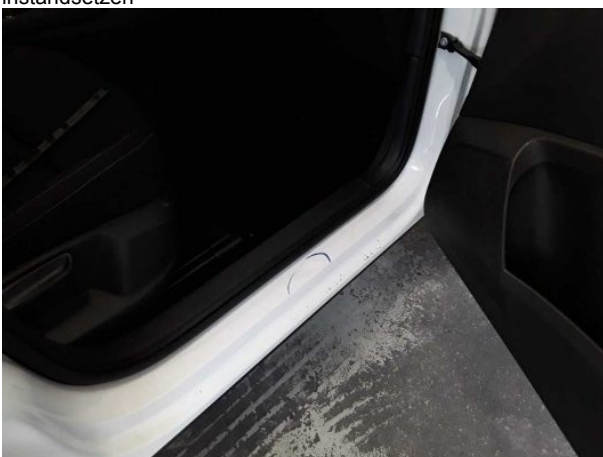
Beschädigung #9: Schweller rechts: Einstieg - Delle(n) - sanft instandsetzen
