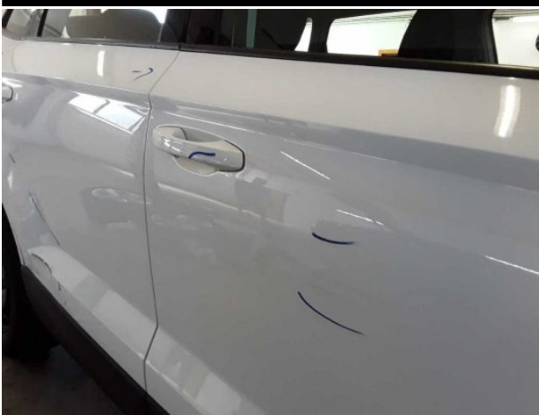
Beschädigung #22: Tür vorn rechts: Tür - Delle / Lackschaden - instandsetzen und lackieren
