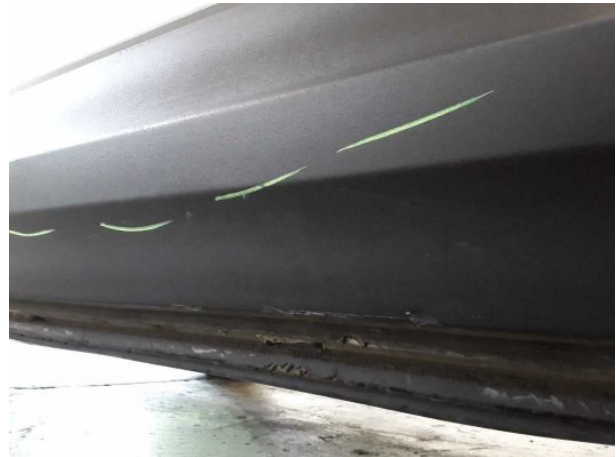
Beschädigung #15: Tür vorn rechts: Zierleiste unten - verkratzt / verschürft - erneuern
