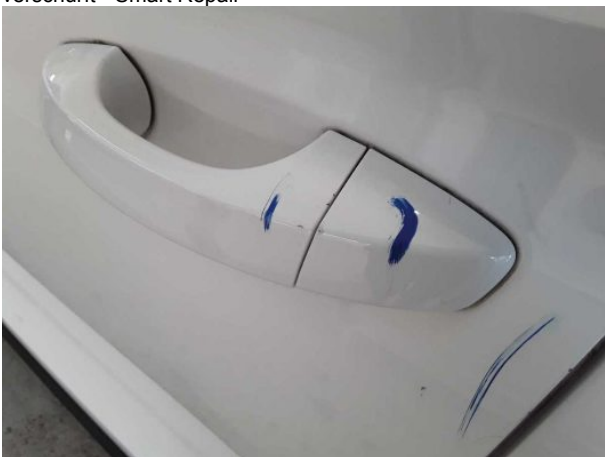
Beschädigung #12: Tür vorn links: Griff außen - verkratzt / verschürft - Smart Repair
