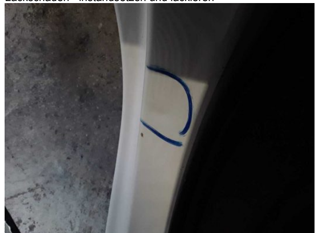
Beschädigung #21: Seitenwand rechts: Einstieg - Delle / Lackschaden - instandsetzen und lackieren
