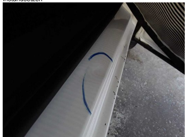
Beschädigung #9: Schweller rechts: Einstieg - Delle(n) - sanft instandsetzen
