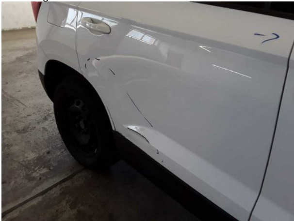
Beschädigung #24: Tür hinten rechts: Tür - verformt - erneuern
