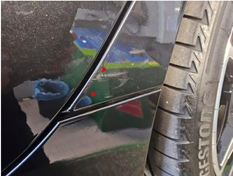
Bild 17 : Seitenwand links verschrammt
