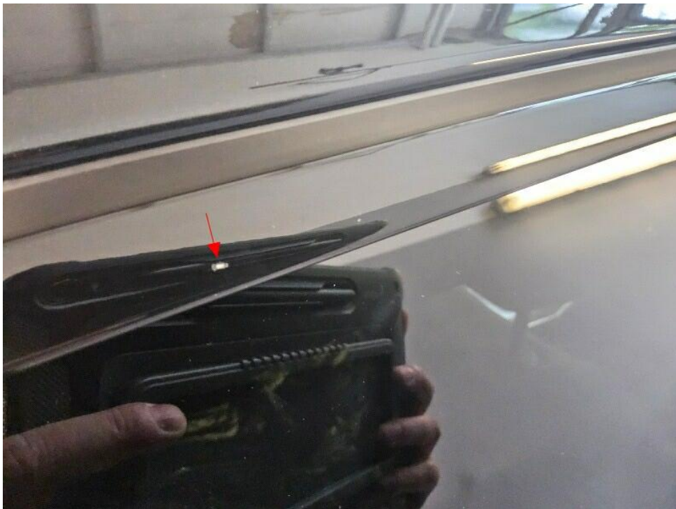
Bild 20 : Blende Tür HR oben verschrammt
