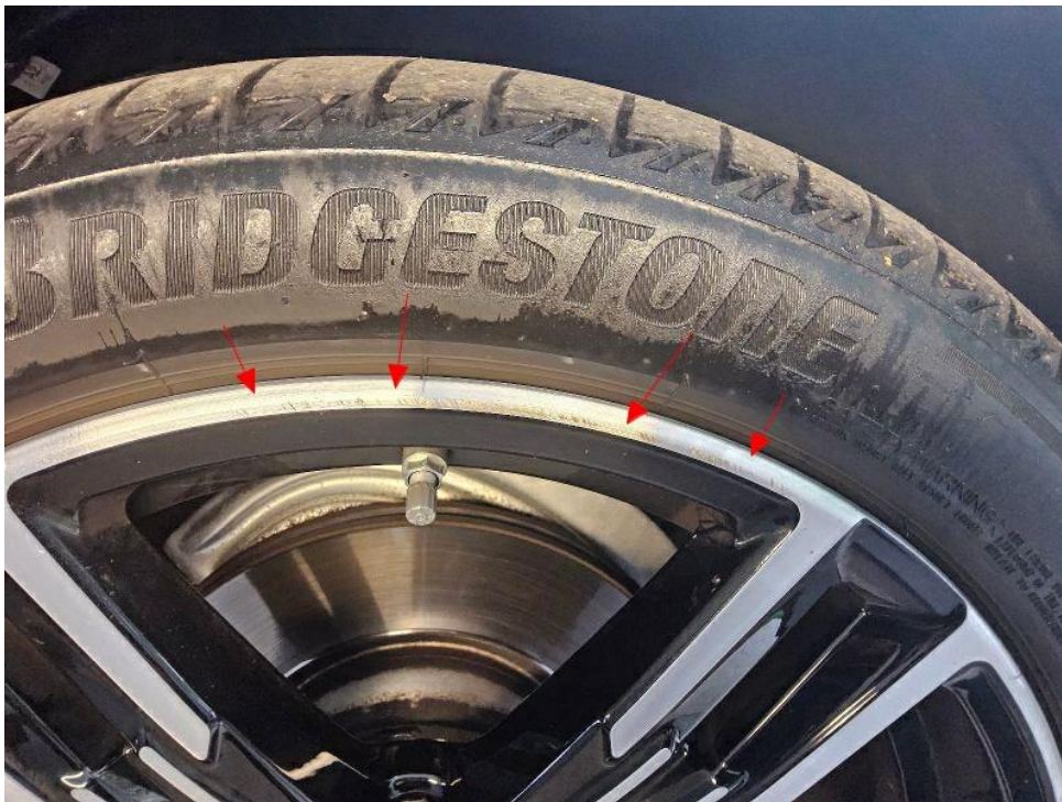
Bild 14 : Felge vorne rechts verschrammt
