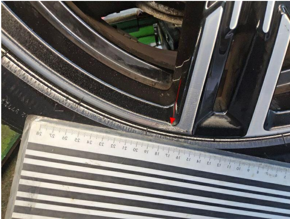
Bild 15 : Felge vorne rechts verschrammt
