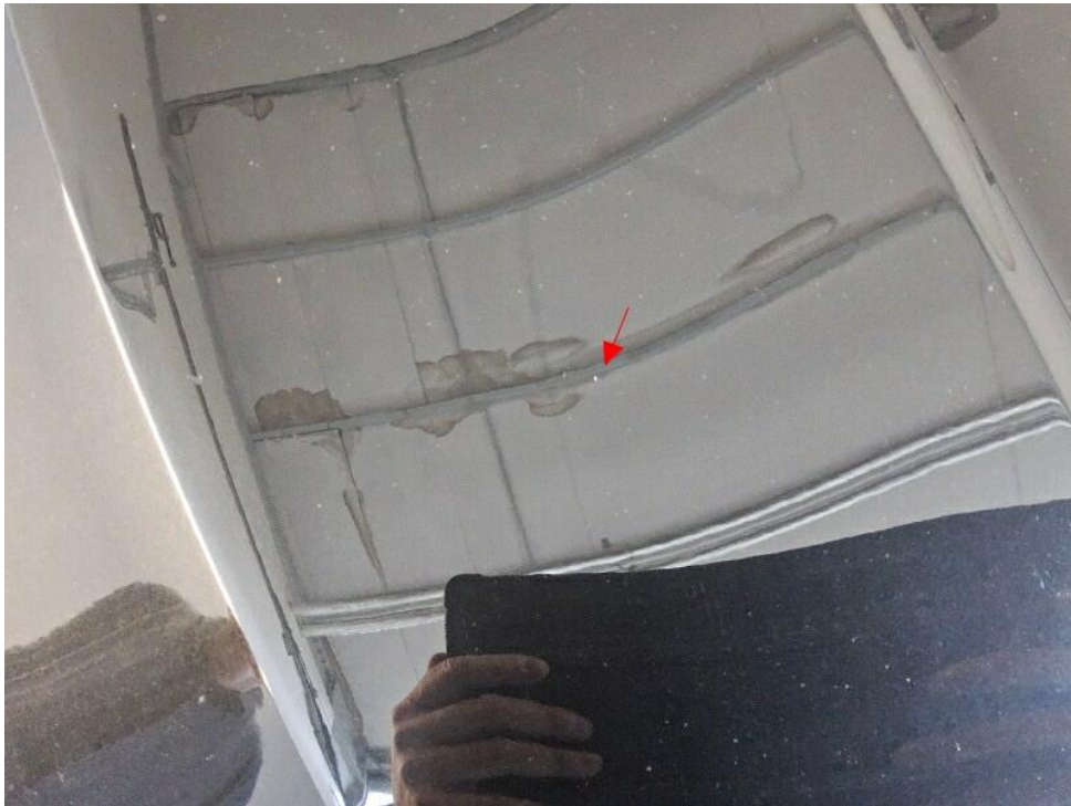
Bild 19 : Deckel vorne Steinschlag
