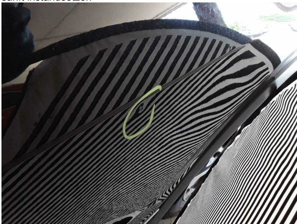
Beschädigung #4: Tür hinten links: Tür - Delle / Lackschaden - sanft instandsetzen
