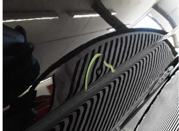
Beschädigung #4: Tür hinten links: Tür - Delle / Lackschade... sanft instandsetzen
