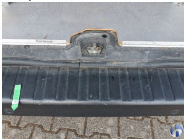
2. Stoßfänger Hinten Beschädigt - Erneuern
