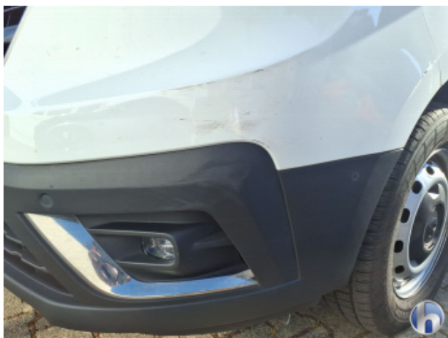
6. Stoßfänger Vorne Beschädigt - Lackieren
