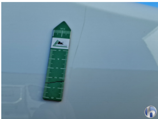
5. Kotflügel Vorne - Rechts Oberflächenkratzer - Aufbereiten / Polieren
