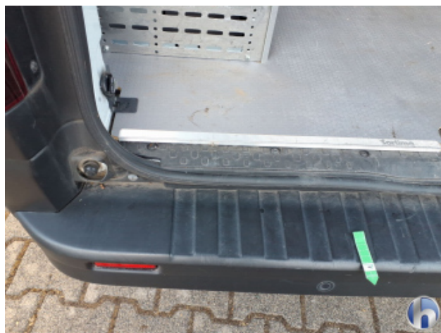
2. Stoßfänger Hinten Beschädigt - Erneuern
