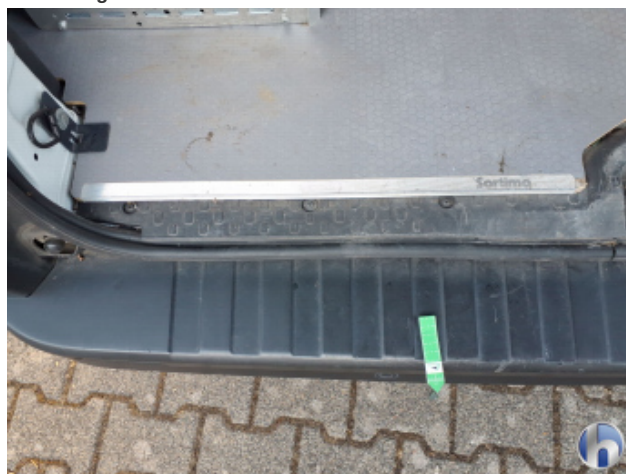
2. Stoßfänger Hinten Beschädigt - Erneuern
