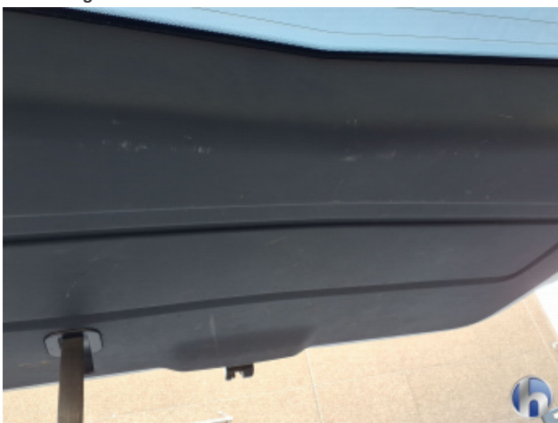
8. Heckklappenverkleidung Beschädigt - Erneuern
