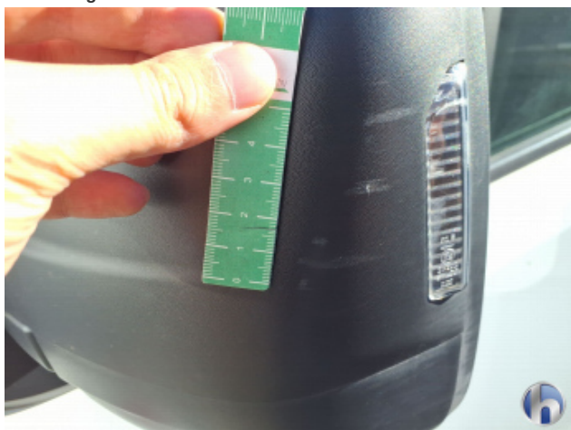
3. Außenspiegel - Links Kratzer - Smart Repair
