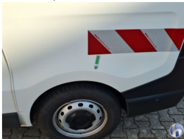
4. Seitenwand - Hinten - Links Oberflächenkratzer - Aufbereiten / Polieren
