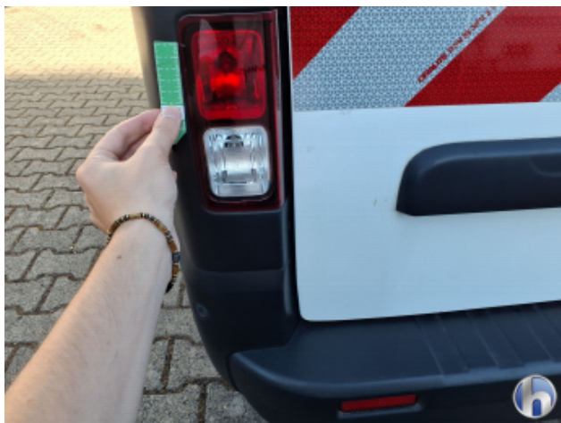
12. Rückleuchte Links Kratzer - Erneuern
