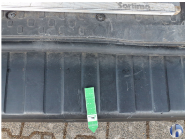
2. Stoßfänger Hinten Beschädigt - Erneuern
