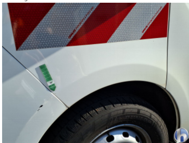
1. Kotflügel Vorne - Links Unfallsschaden -
