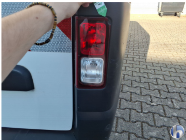
13. Rückleuchte Rechts Riss - Erneuern
