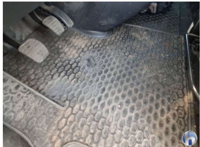
11. Fußraum Innenraum links vorne Loch - Erneuern
