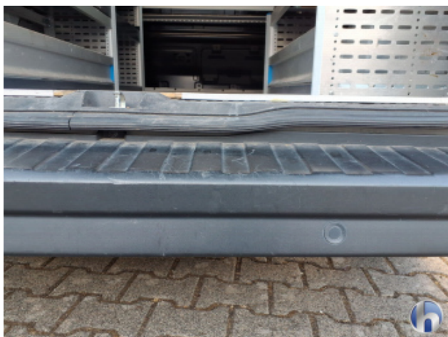
2. Stoßfänger Hinten Beschädigt - Erneuern
