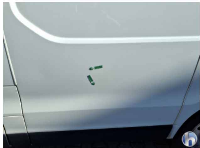
7. Tür Hinten - Links Verdellt - Instandsetzen und Lackieren
