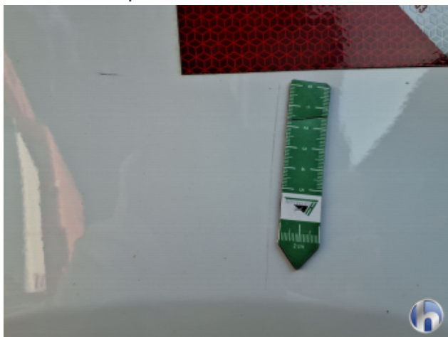
4. Seitenwand - Hinten - Links Oberflächenkratzer - Aufbereiten / Polieren
