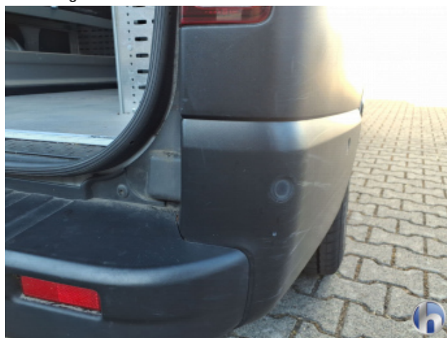
2. Stoßfänger Hinten Beschädigt - Erneuern
