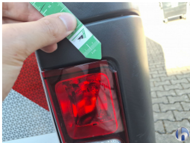
13. Rückleuchte Rechts Riss - Erneuern
