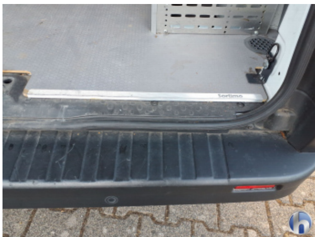
2. Stoßfänger Hinten Beschädigt - Erneuern
