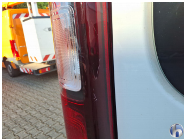
12. Rückleuchte Links Kratzer - Erneuern
