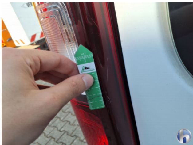
12. Rückleuchte Links Kratzer - Erneuern
