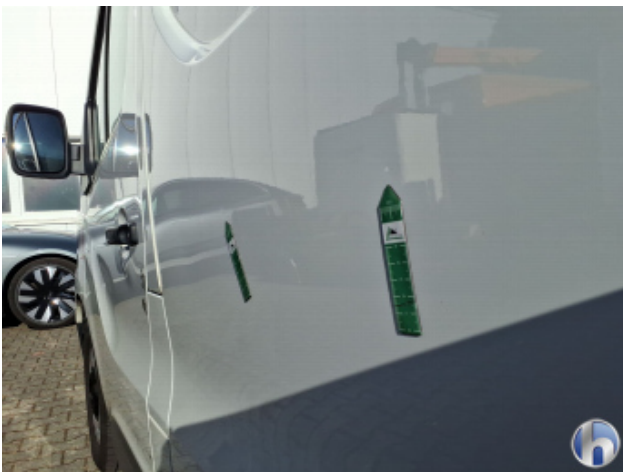
7. Tür Hinten - Links Verdellt - Instandsetzen und Lackieren
