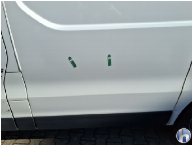
7. Tür Hinten - Links Verdellt - Instandsetzen und Lackieren
