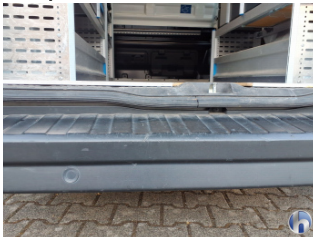
2. Stoßfänger Hinten Beschädigt - Erneuern
