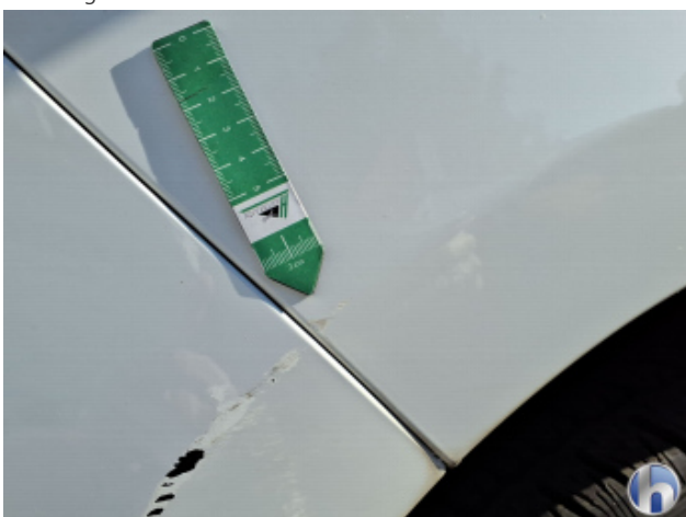
1. Kotflügel Vorne - Links Unfallsschaden -
