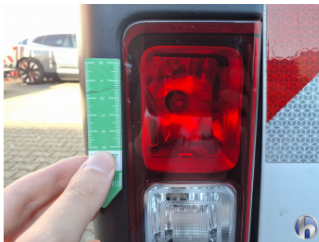
12. Rückleuchte Links Kratzer - Erneuern
