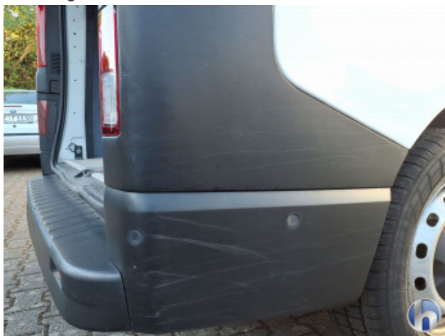
2. Stoßfänger Hinten Beschädigt - Erneuern
