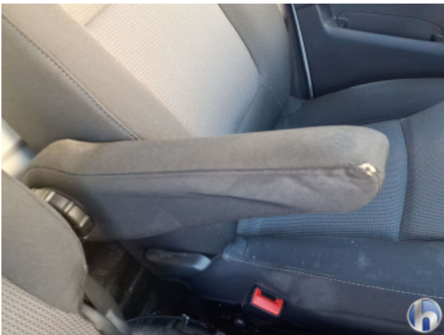
10. Sitz Innenraum links vorne Riss - Erneuern
