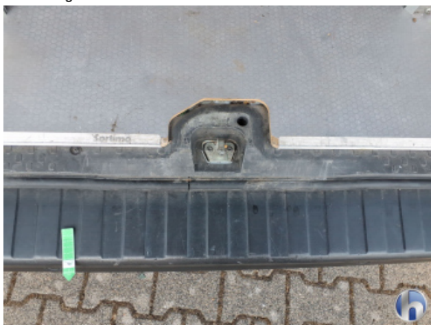
2. Stoßfänger Hinten Beschädigt - Erneuern
