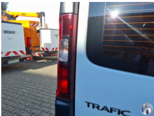
12. Rückleuchte Links Kratzer - Erneuern
