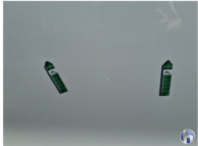
7. Tür Hinten - Links Verdellt - Instandsetzen und Lackieren
