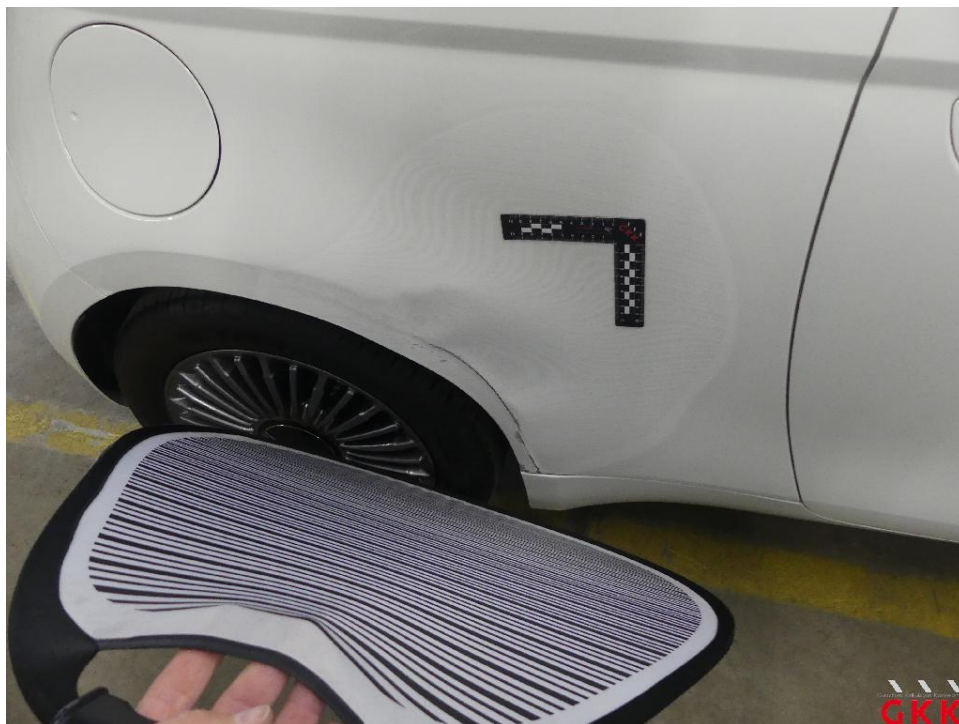
Bild 21 Seitenwand rechts, beschädigt, instand setzen - lackieren
