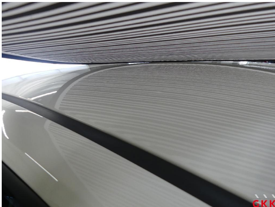
Bild 27 Fahrzeug, Hagelschaden, instand setzen
