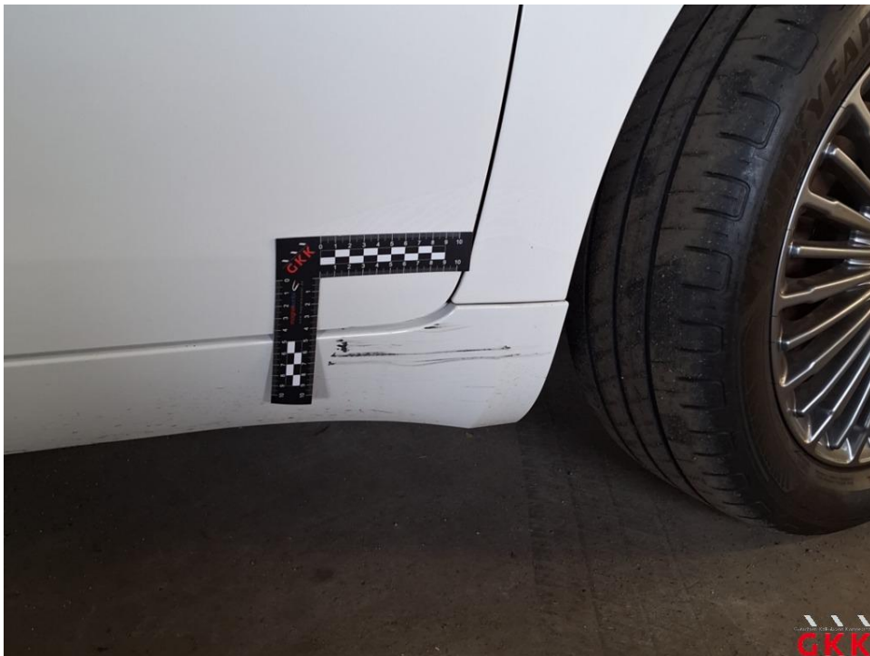
Bild 30 Schweller rechts, Verkleidung -lackiert-, beschädigt, ersetzen
