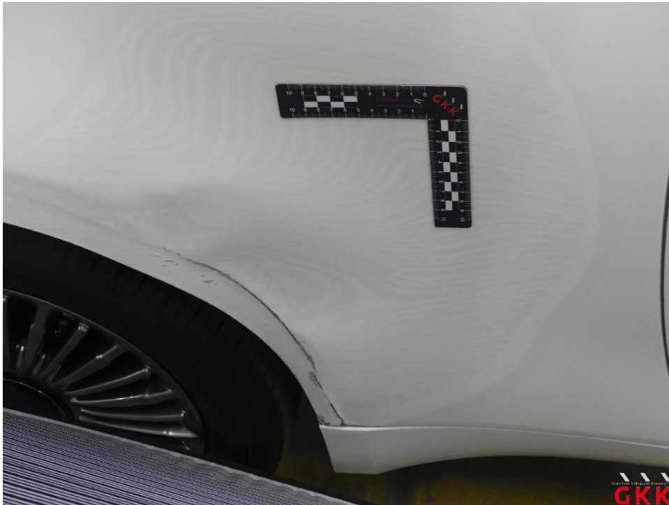
Bild 23 Seitenwand rechts, beschädigt, instand setzen - lackieren
