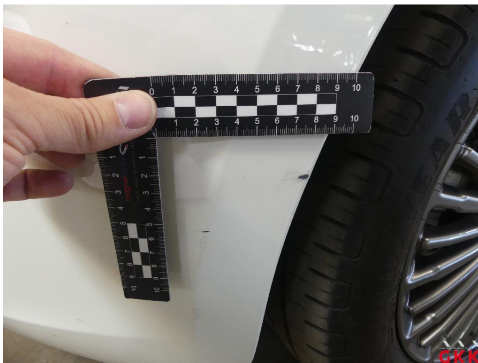
Bild 18 Stoßfänger vorne, Verkleidung -lackiert-, verkratzt, lackieren
