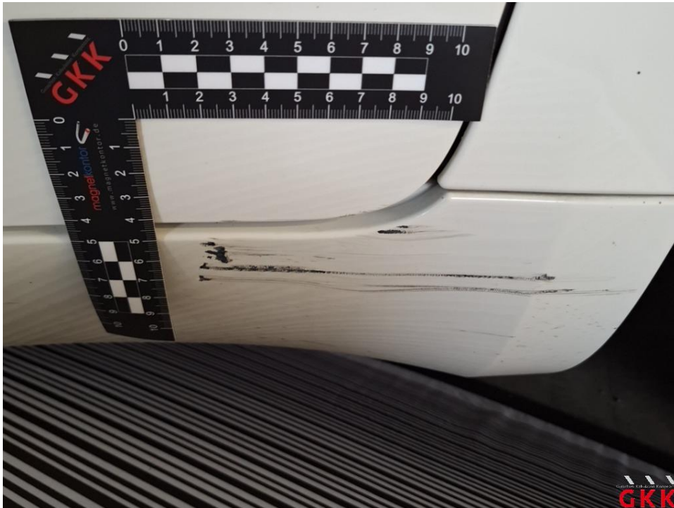
Bild 31 Schweller rechts, Verkleidung -lackiert-, beschädigt, ersetzen
