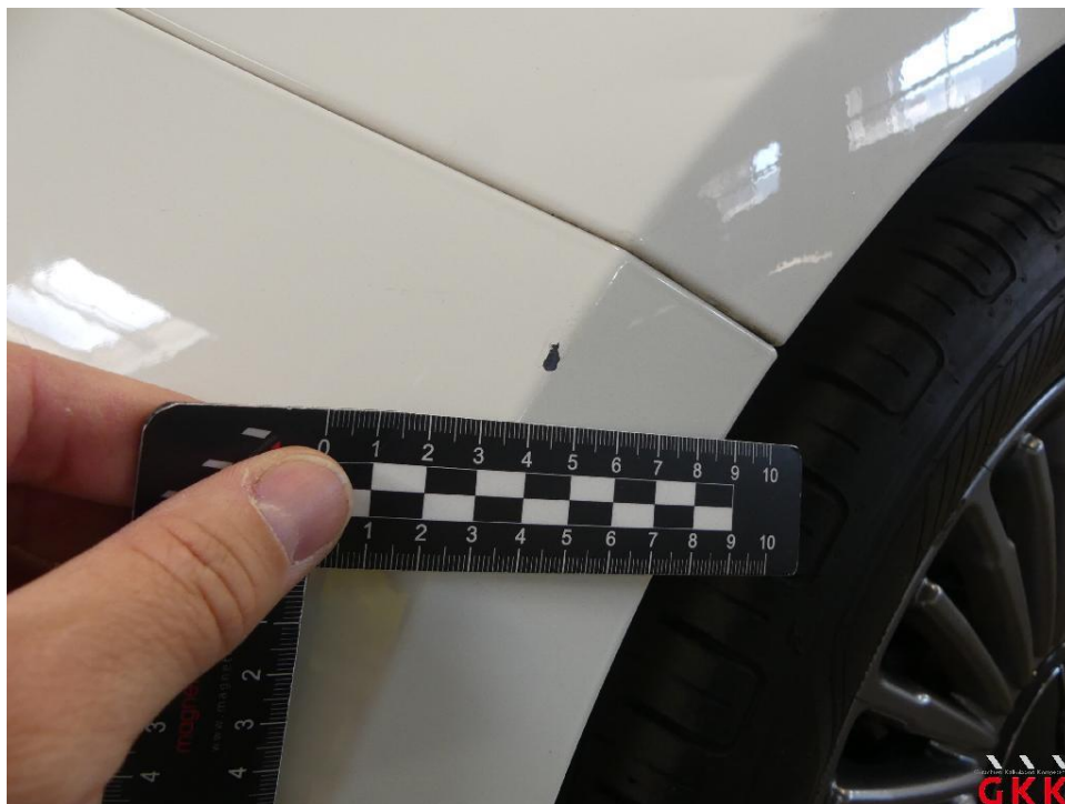
Bild 19 Stoßfänger vorne, Verkleidung -lackiert-, verkratzt, lackieren
