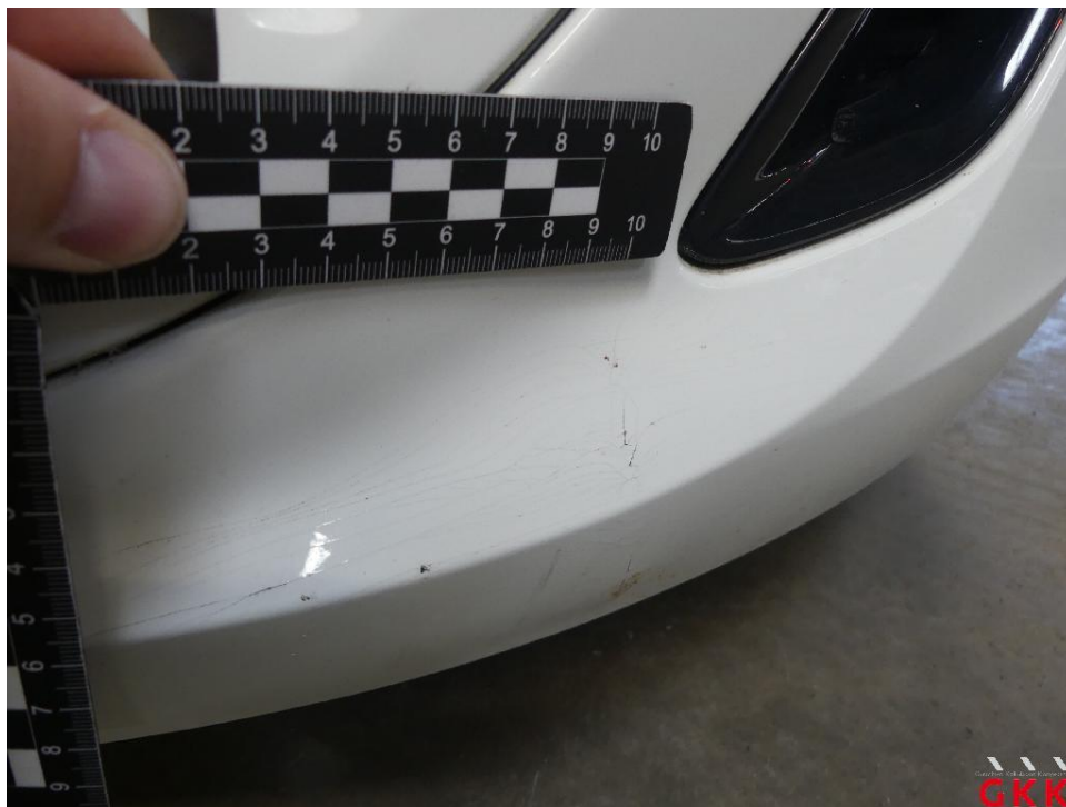
Bild 20 Stoßfänger vorne, Verkleidung -lackiert-, verkratzt, lackieren
