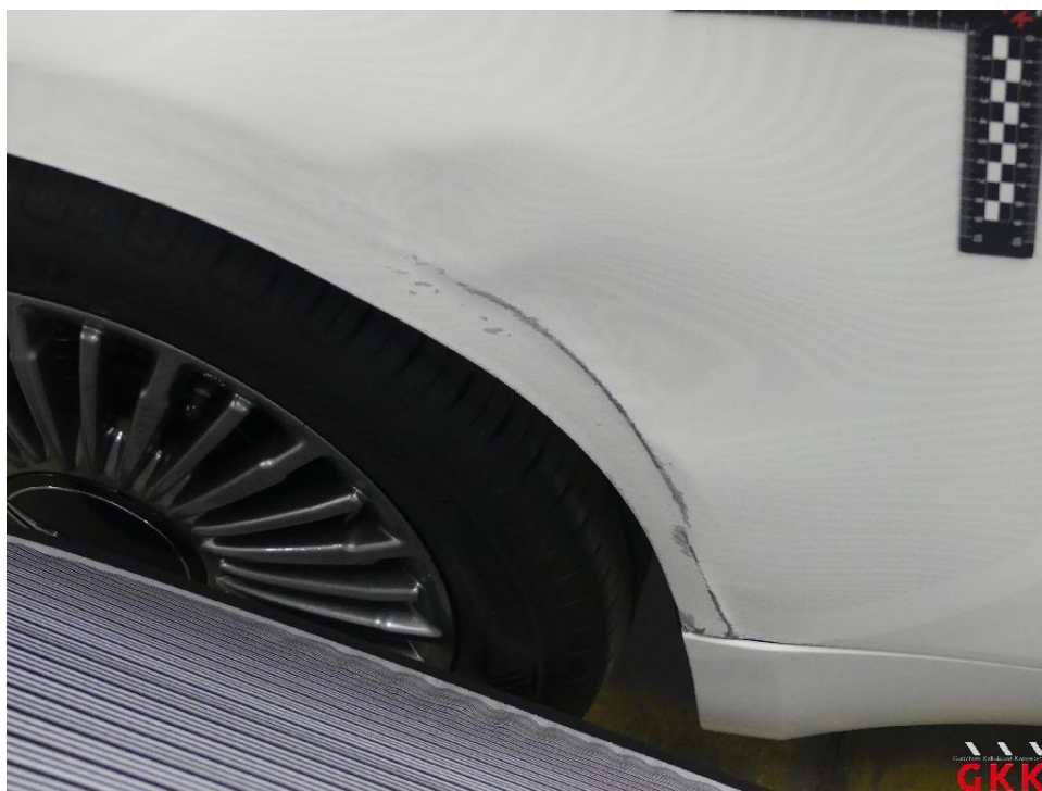
Bild 22 Seitenwand rechts, beschädigt, instand setzen - lackieren
