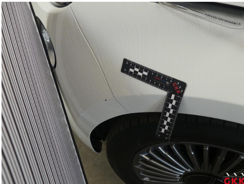
Bild 17 Kotflügel vorne links, beschädigt, instand setzen - lackieren
