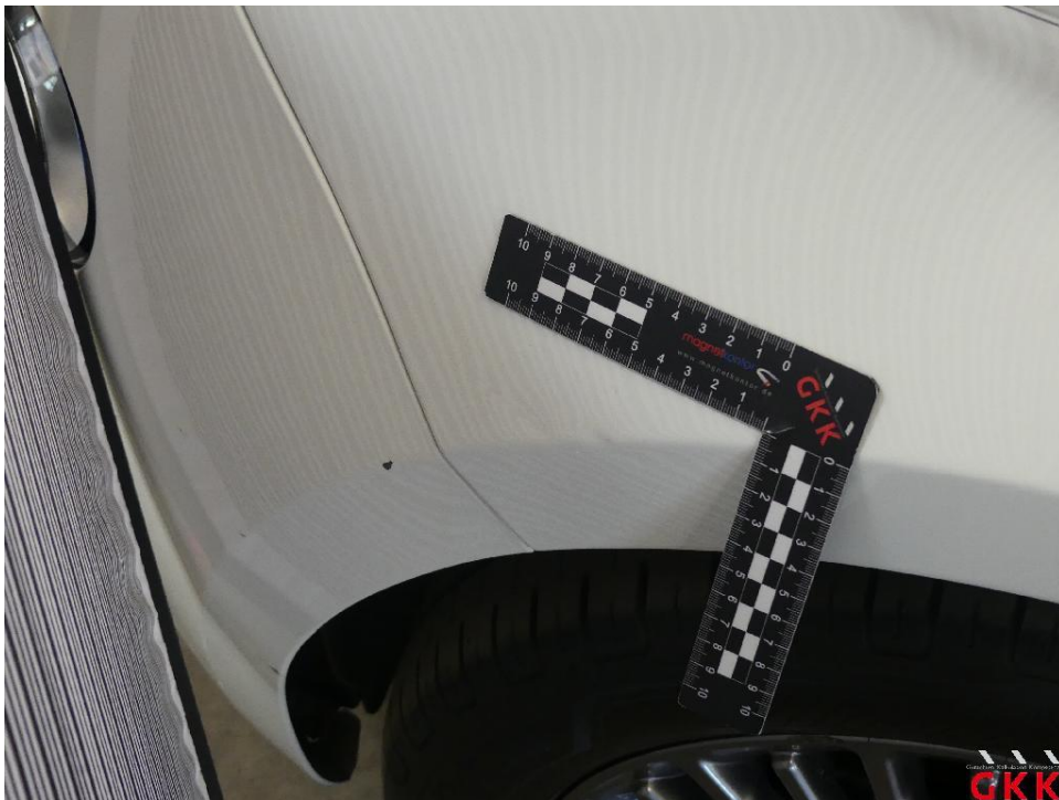
Bild 16 Kotflügel vorne links, beschädigt, instand setzen - lackieren
