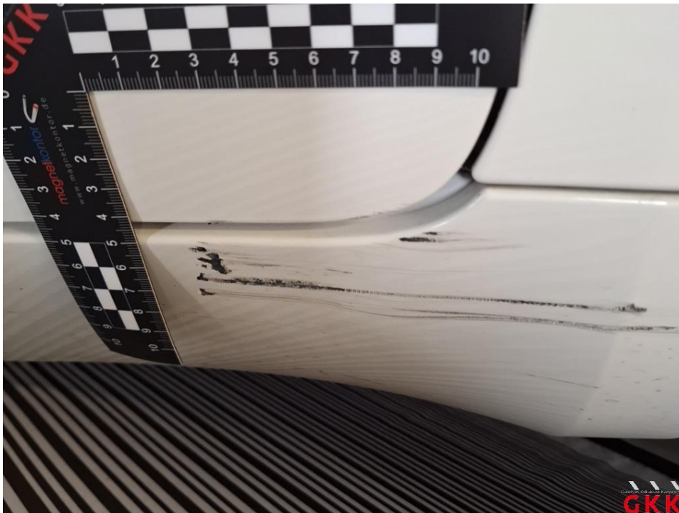
Bild 32 Schweller rechts, Verkleidung -lackiert-, beschädigt, ersetzen
