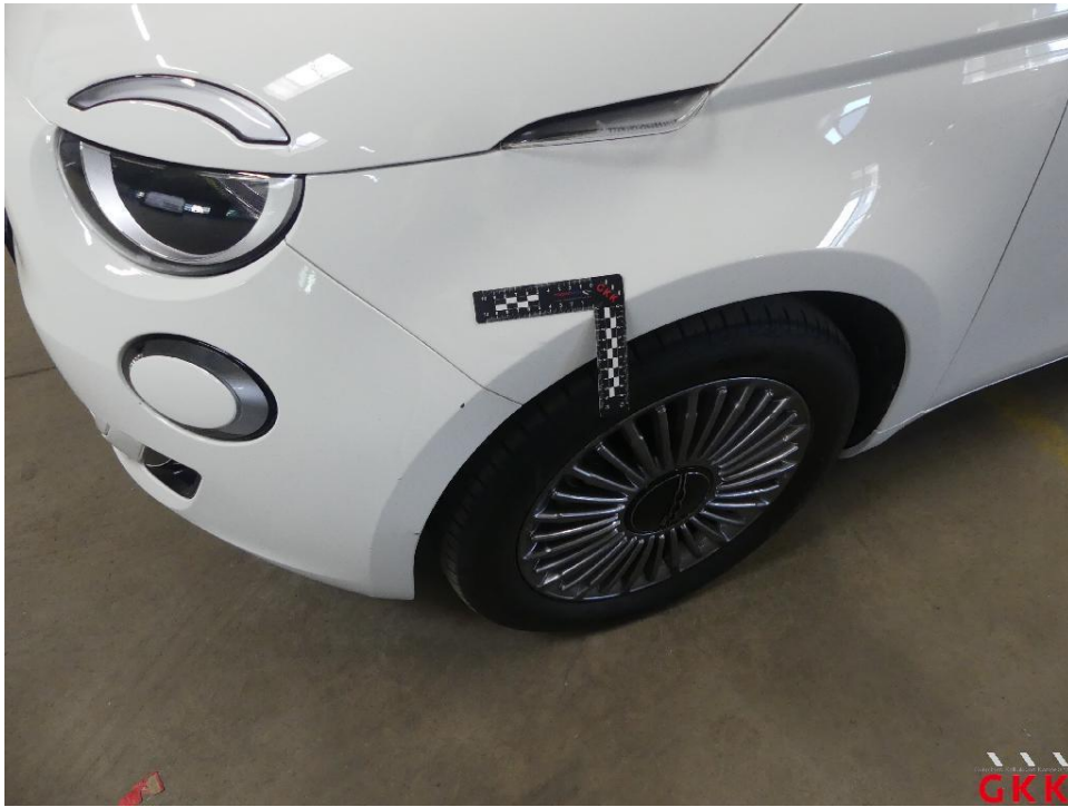
Bild 15 Kotflügel vorne links, beschädigt, instand setzen - lackieren
