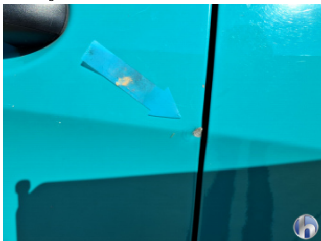
3. Tür Hinten - Rechts Beschädigt - Instandsetzen und Lackieren
