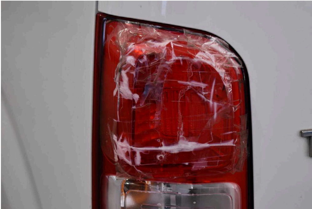
Bild 27 Fahrzeugheck Rückleuchte links gebrochen
