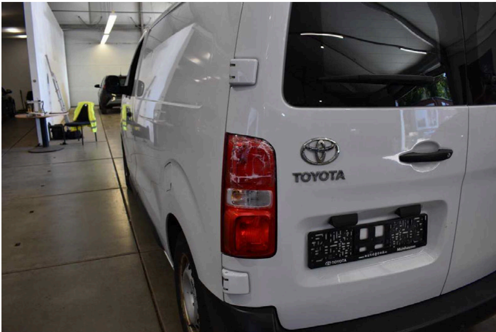
Bild 26 Fahrzeugheck Rückleuchte links gebrochen
