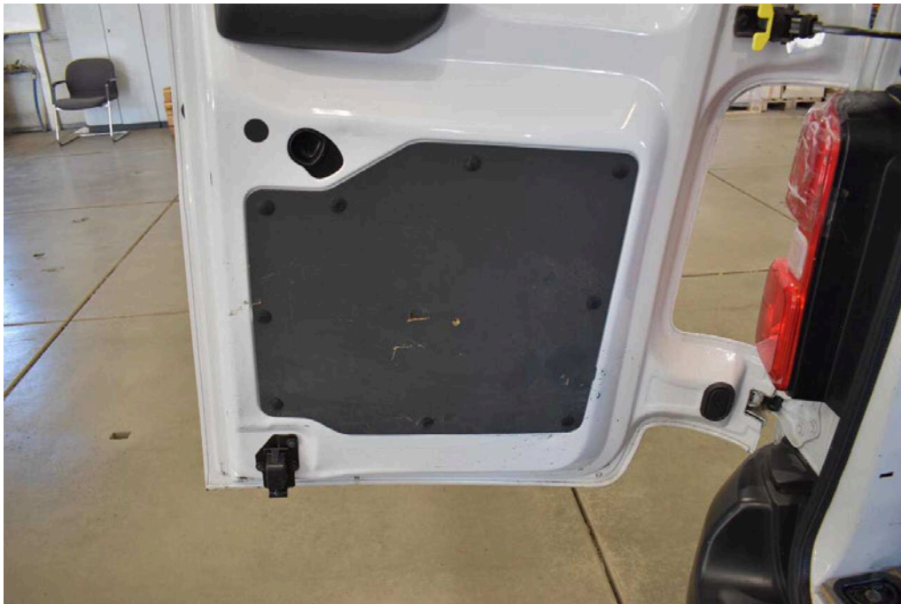
Bild 15 Innenraum Heckflügeltürverkleidung links gebrochen
