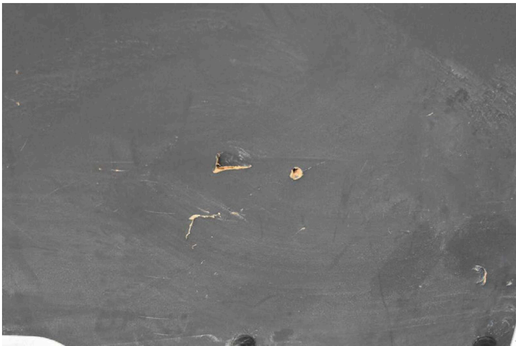
Bild 16 Innenraum Heckflügeltürverkleidung links gebrochen
