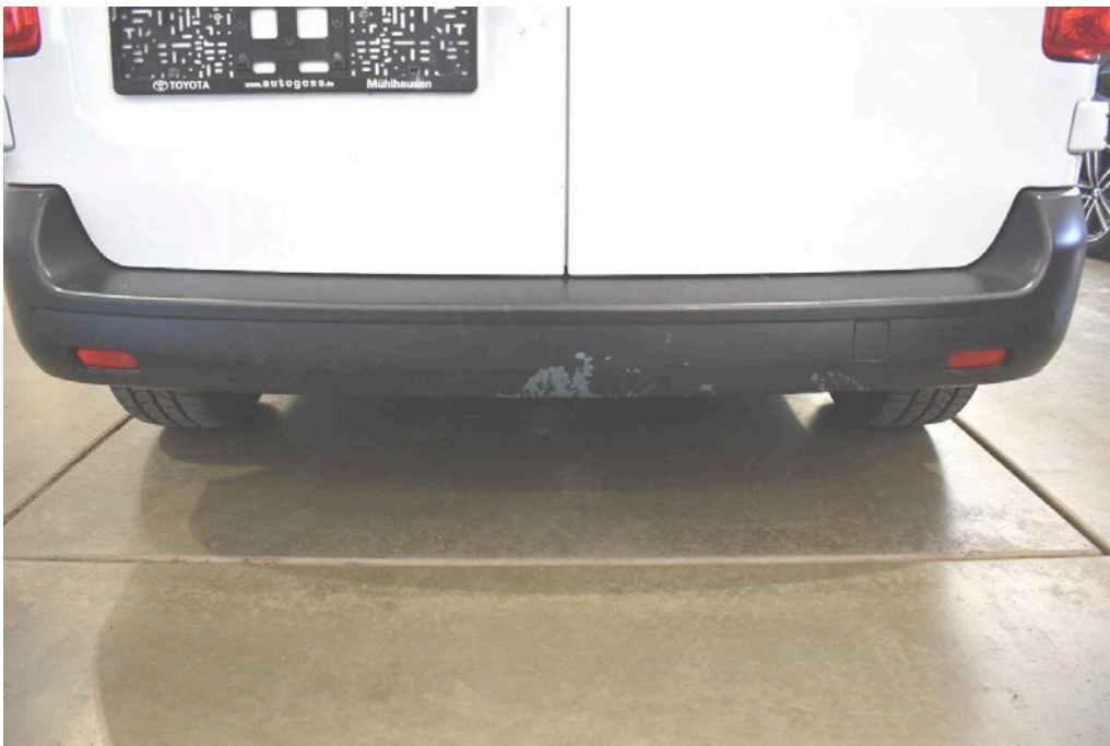
Bild 30 Fahrzeugheck Stoßfänger hinten Lackanhaftung
