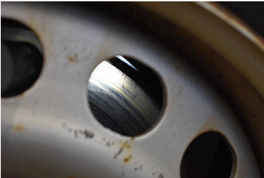
Bild 42 Hinterachse Bremsscheiben hinten verschlissen, erneuern, Bremsklötze, erneuern
