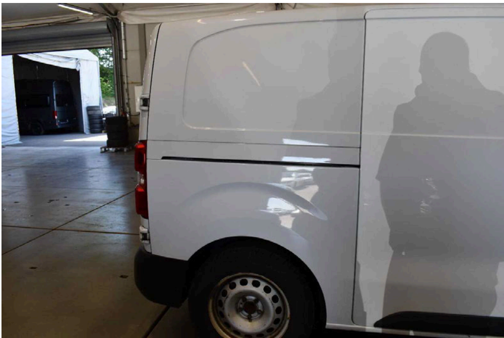
Bild 32 rechte Seite Seitenwand hinten rechts Delle
