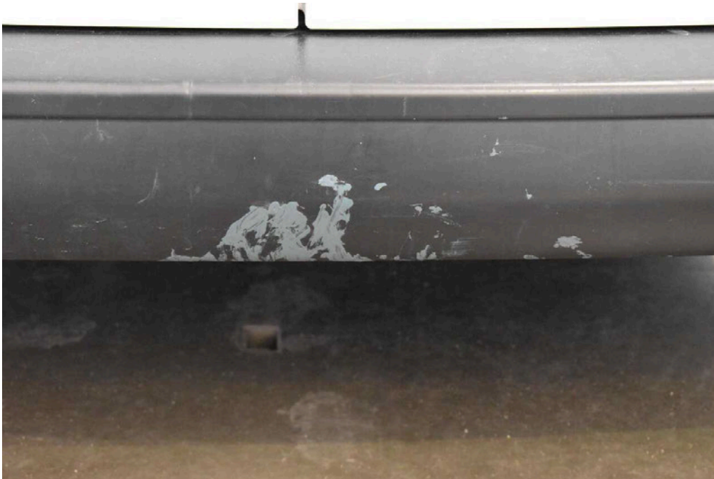
Bild 31 Fahrzeugheck Stoßfänger hinten Lackanhaftung
