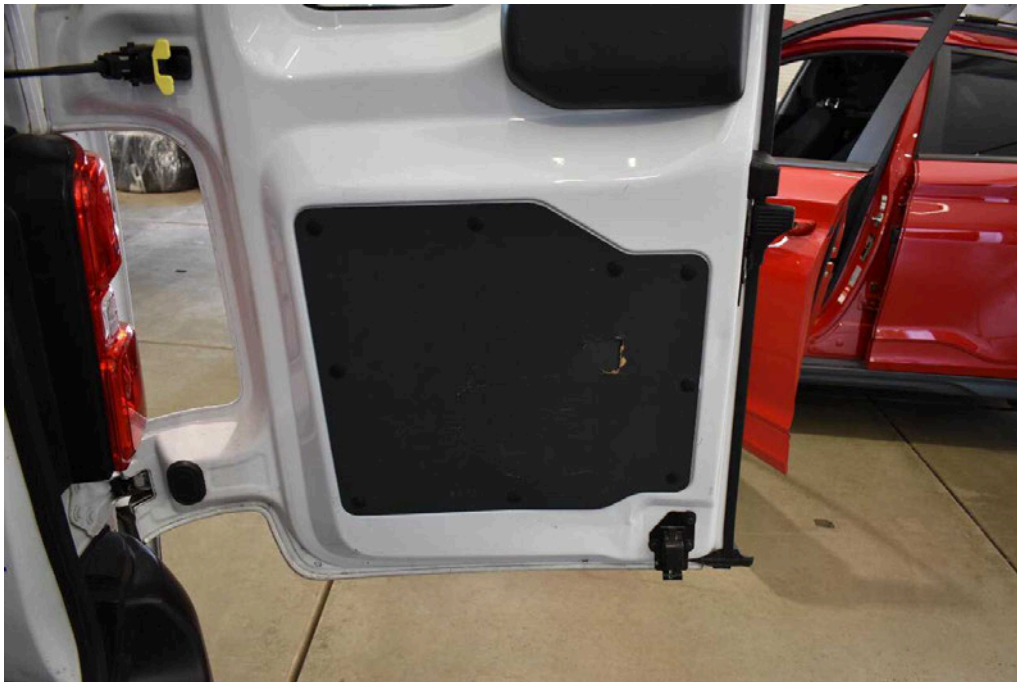
Bild 17 Innenraum Heckflügeltürverkleidung rechts gebrochen
