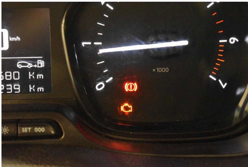
Bild 14 Systeme Motorkontrollleuchte aktiv / gestört
