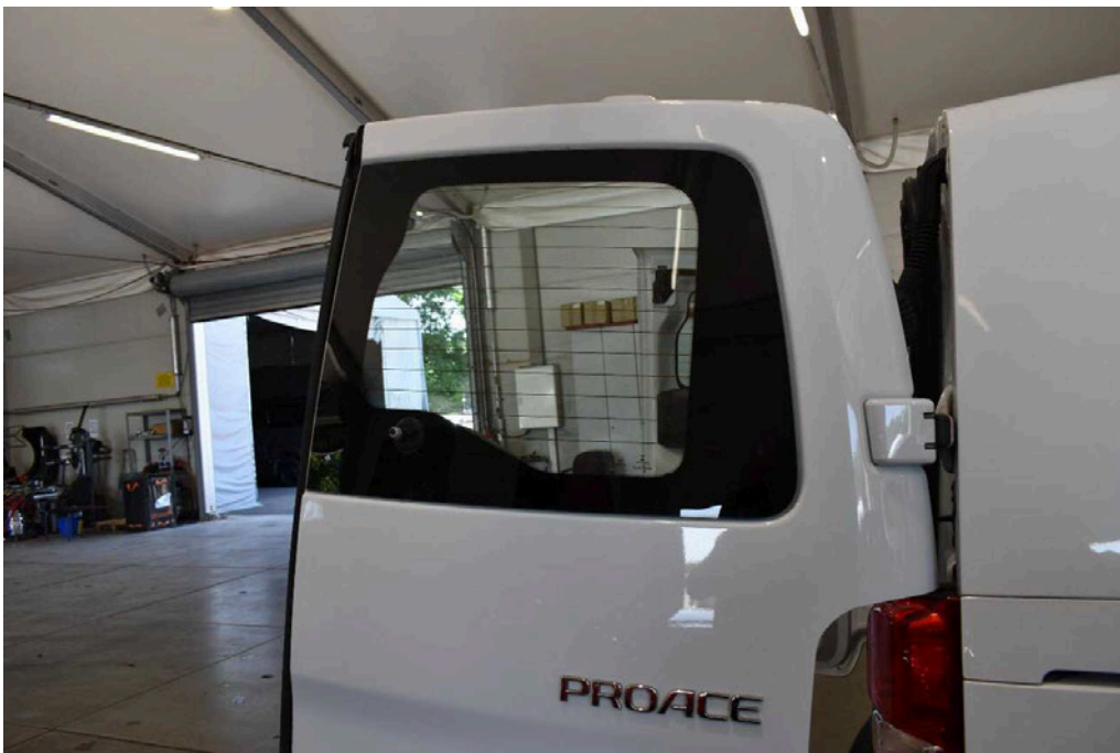
Bild 28 Fahrzeugheck Wischerarm hinten fehlt
