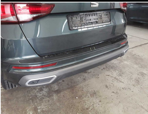
Beschädigung #6: Stossfänger hinten: Stossfänger hinten - verkratzt / verschürft - Smart Repair
