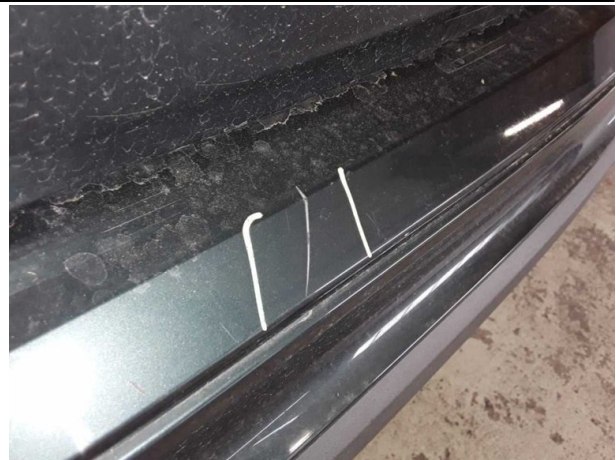
Beschädigung #6: Stossfänger hinten: Stossfänger hinten - verkratzt / verschürft - Smart Repair
