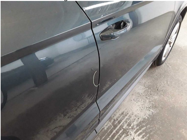
Beschädigung #3: Tür hinten rechts: Tür - Delle(n) - sanft instandsetzen
