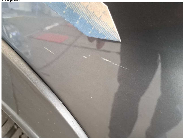
Beschädigung #4: Kotflügel links: Kotflügel links - Kratzer - lackieren
