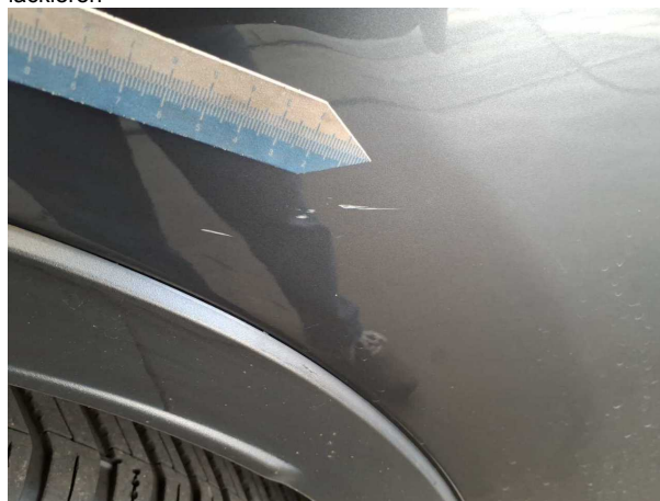
Beschädigung #4: Kotflügel links: Kotflügel links - Kratzer - lackieren
