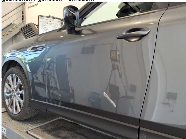
Beschädigung #2: Tür vorn links: Tür (Zwei Dellen) - Delle(n) - sanft instandsetzen
