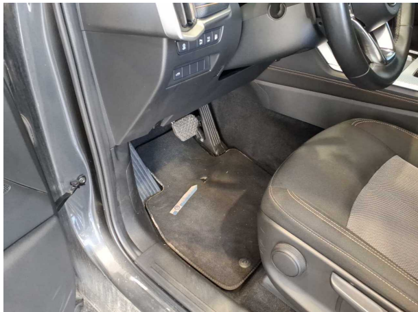
Beschädigung #1: Verkleidungen/Abdeckungen: Fußmatten (VL) - gebrochen / gerissen - erneuern
