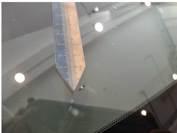
Beschädigung #3: Verglasung: Frontscheibe - Steinschlag - Smart Repair
