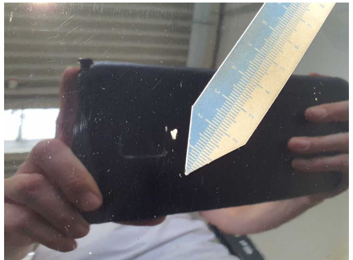
Damage 6: Bonnet: Bonnet (Steinschläge und Anätzung) - Paint defect - Paint
