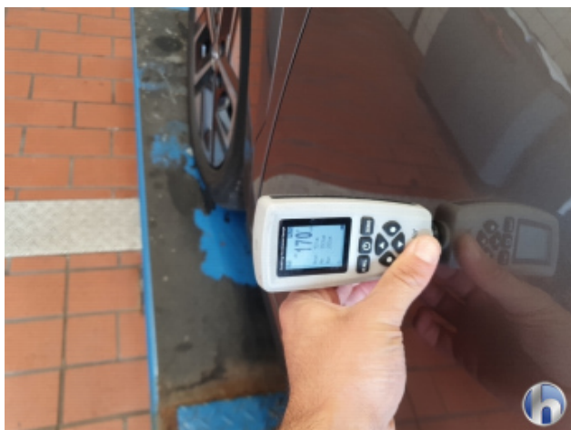
2. Tür Vorne - Links Nachlackiert - Ohne Reparatur
