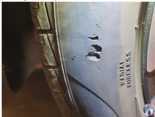
4. Reifen Vorne - Links Beschädigt - Erneuern
