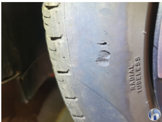
4. Reifen Vorne - Links Beschädigt - Erneuern
