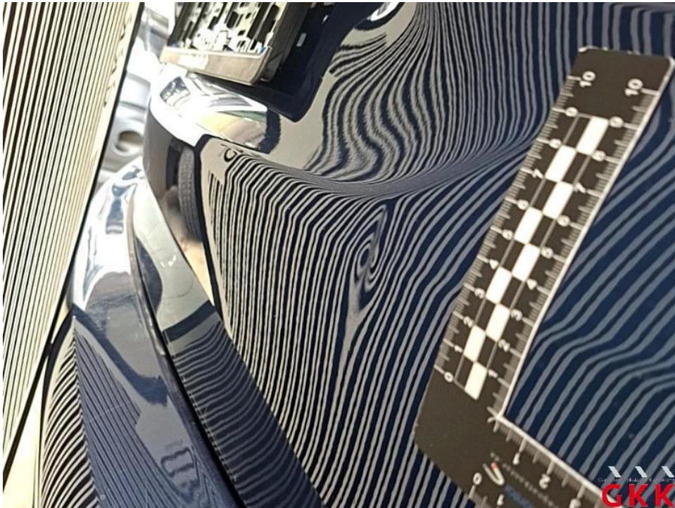
Bild 36. Heckklappe, beschädigt, instand setzen - lackieren
