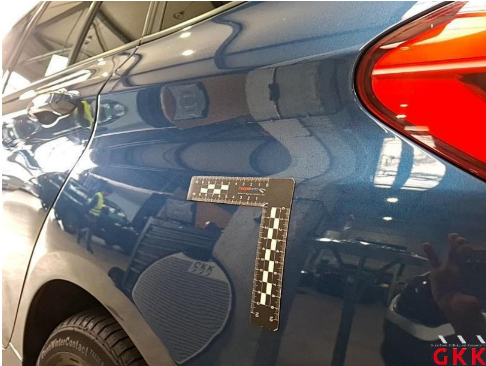
Bild 27. Seitenwand links, Reparaturmangel, aufbereiten
