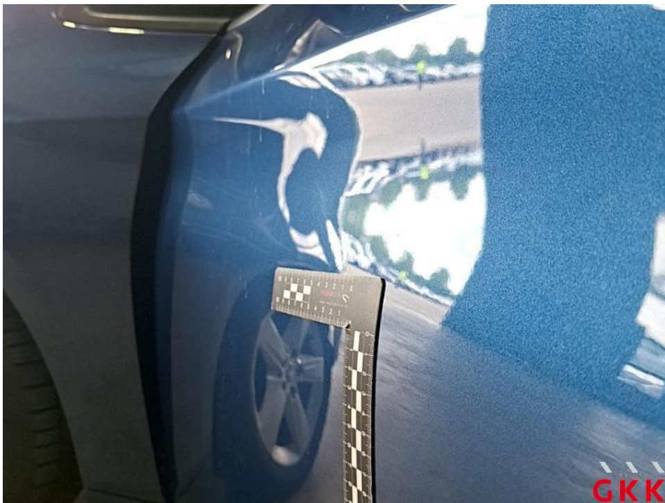
Bild 20. Tür vorne links, Reparaturmangel, aufbereiten
