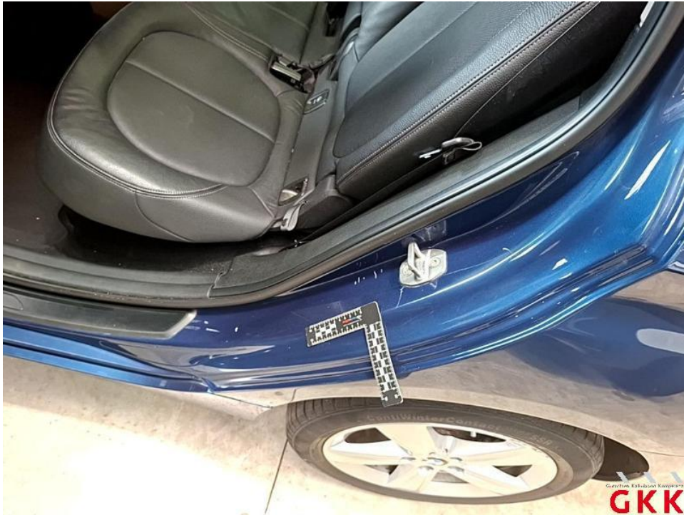
Bild 25. Tür hinten links, Einstieg, verkratzt, lackieren
