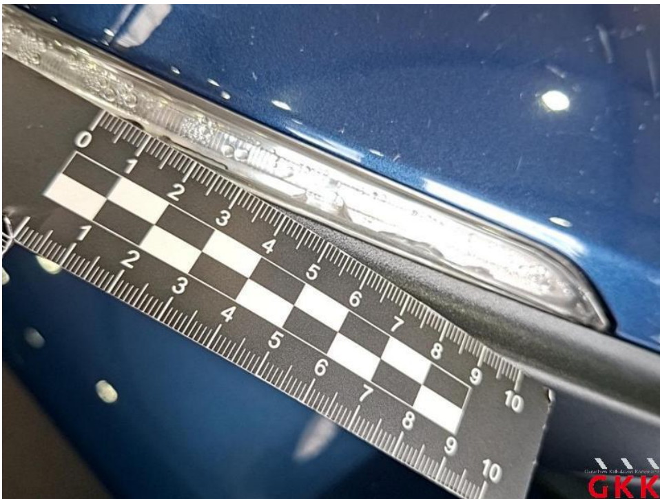
Bild 44. Spiegelgehäuse rechts, Blinker, beschädigt, ersetzen
