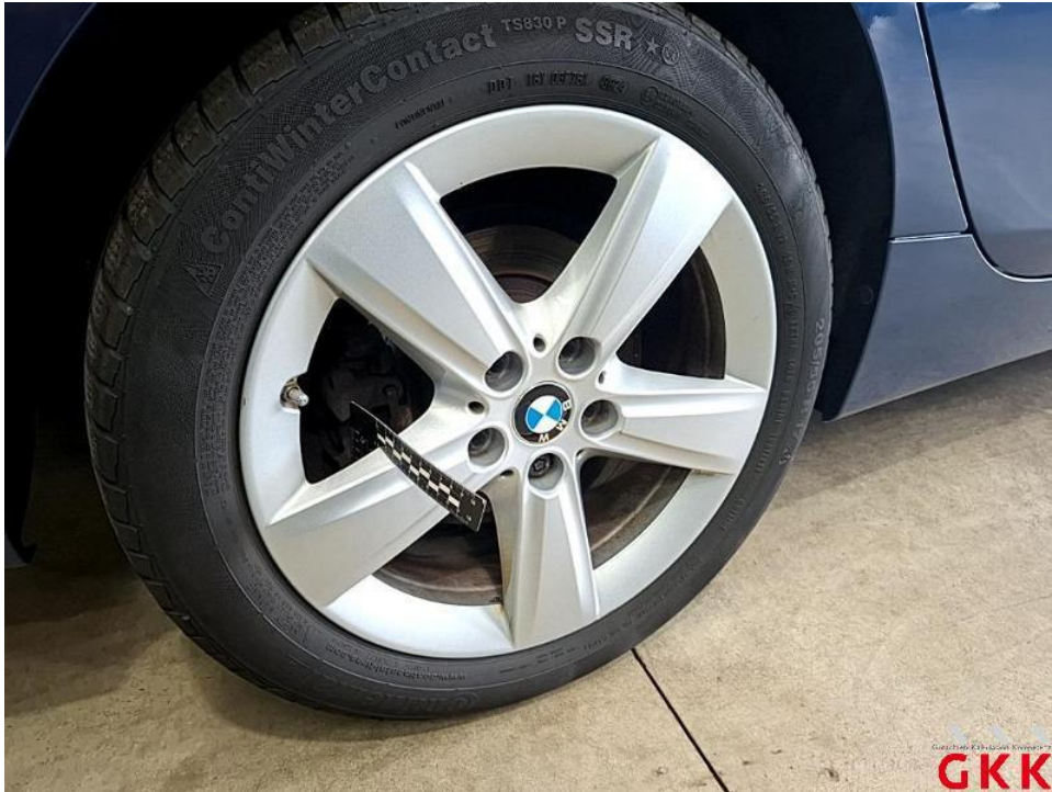
Bild 37. LM-Rad, hinten rechts, verkratzt, lackieren
