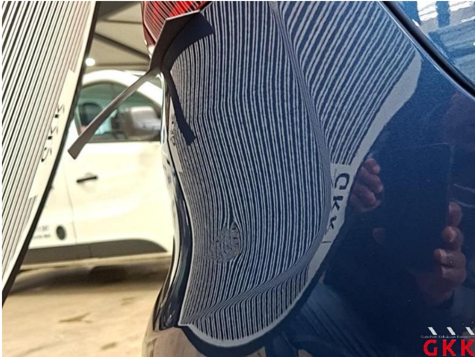
Bild 33. Stoßfänger hinten, Verkleidung -lackiert-, beschädigt, instand setzen - lackieren
