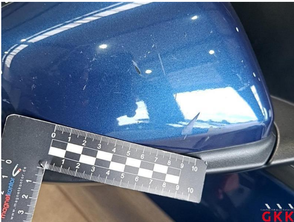
Bild 42. Spiegelgehäuse rechts, Kappe -lackiert-, verkratzt, lackieren
