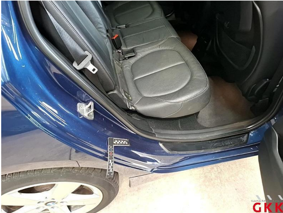
Bild 39. Tür hinten rechts, Einstieg, verkratzt, lackieren
