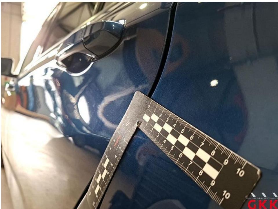
Bild 24. Tür hinten links, Reparaturmangel, aufbereiten
