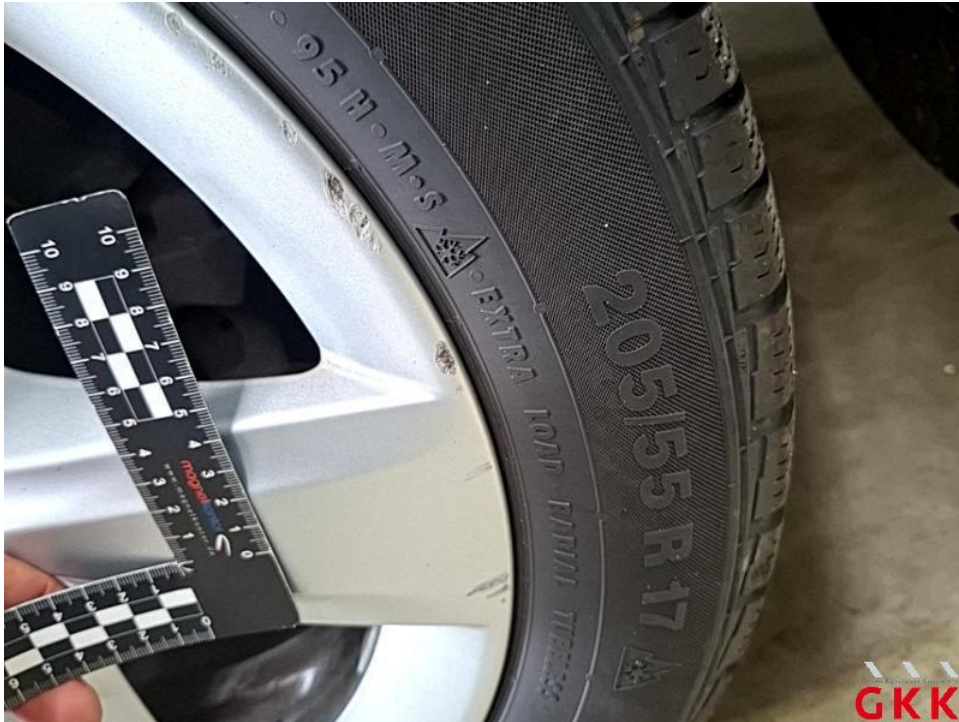
Bild 31. LM-Rad, hinten links, Materialabtrag, ersetzen
