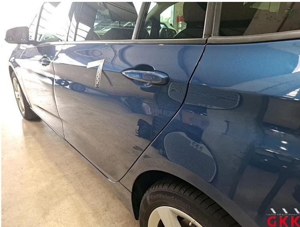
Bild 22. Tür hinten links, Reparaturmangel, aufbereiten
