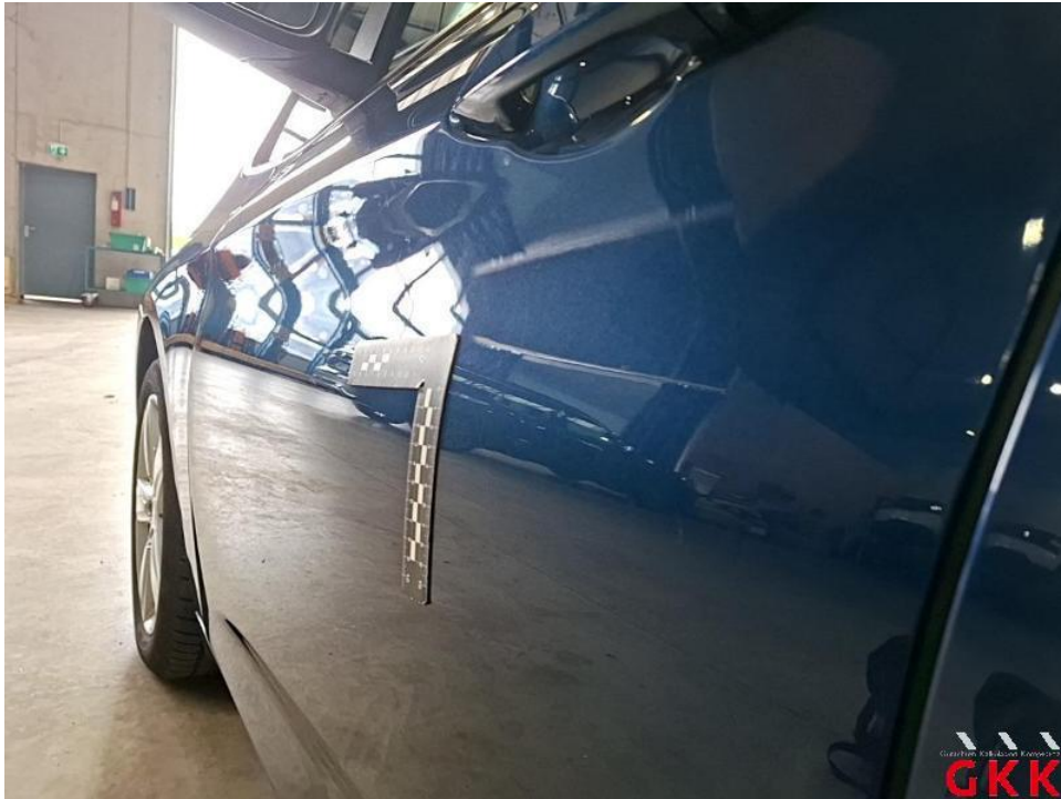
Bild 19. Tür vorne links, Reparaturmangel, aufbereiten
