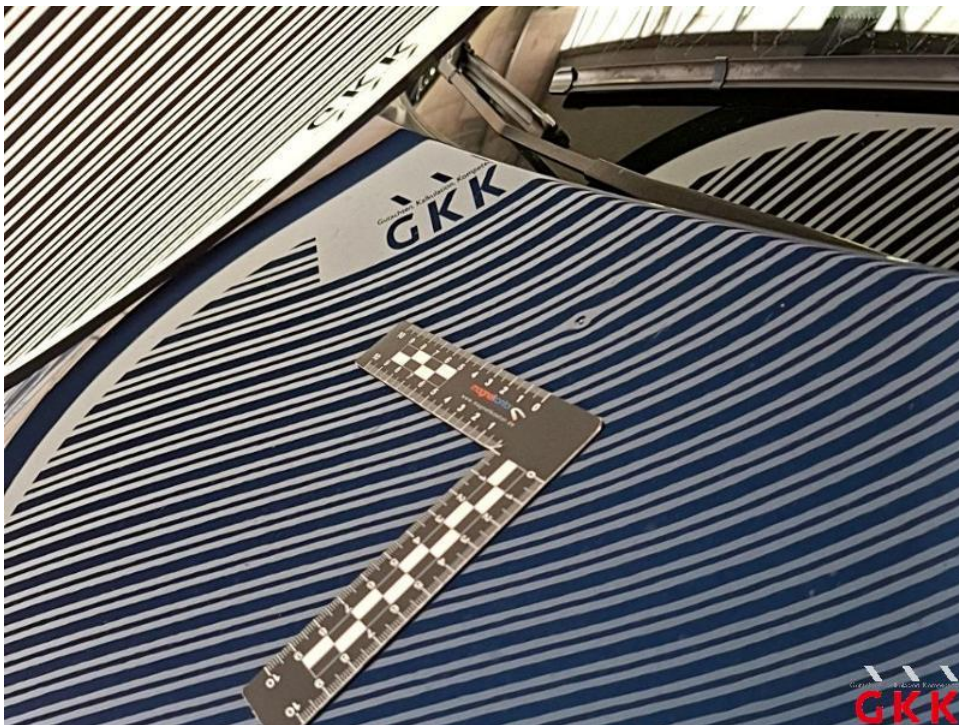
Bild 14. Motorhaube, beschädigt, instand setzen - lackieren
