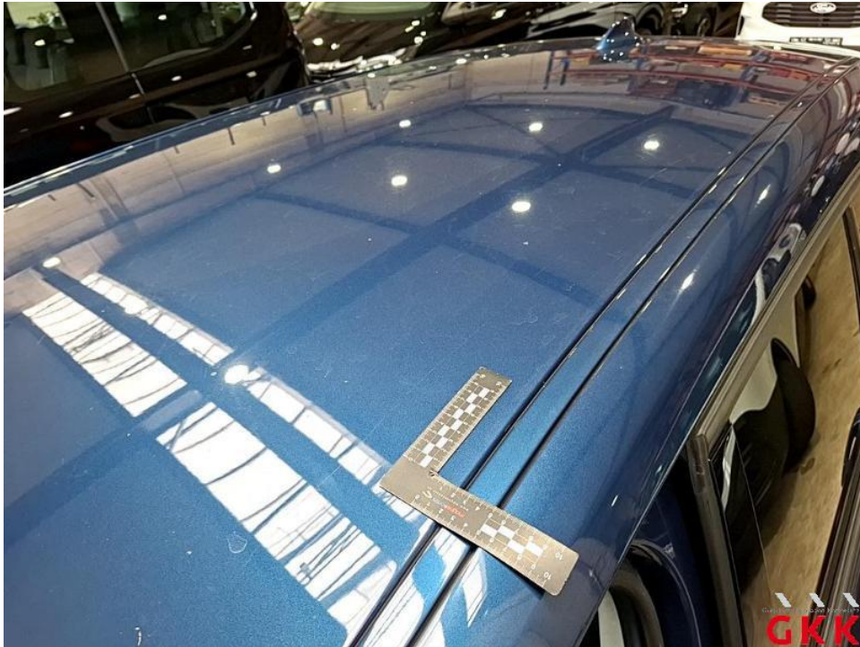
Bild 45. Dach, verkratzt, auslegen, schleifen, polieren
