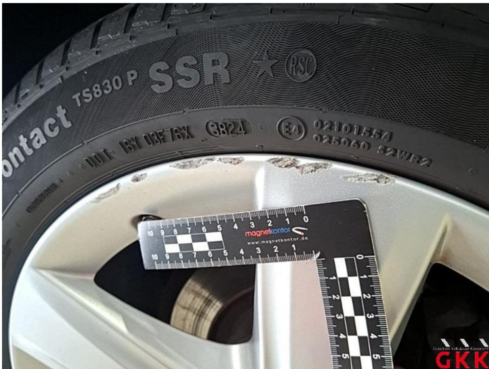
Bild 30. LM-Rad, hinten links, Materialabtrag, ersetzen
