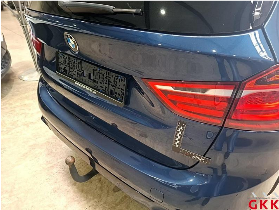
Bild 35. Heckklappe, beschädigt, instand setzen - lackieren
