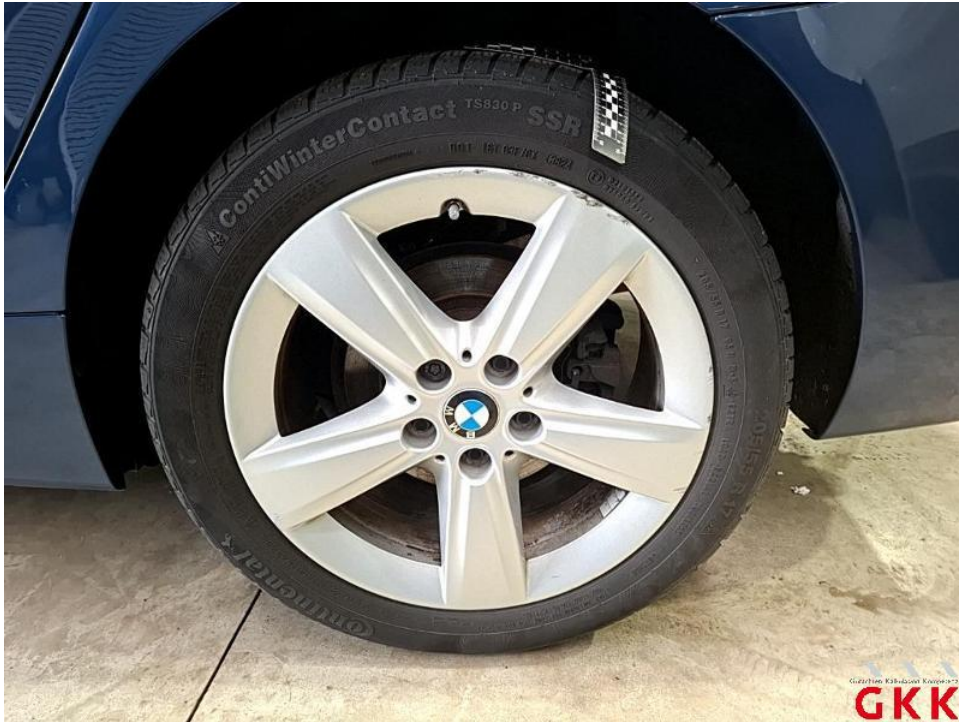
Bild 29. LM-Rad, hinten links, Materialabtrag, ersetzen
