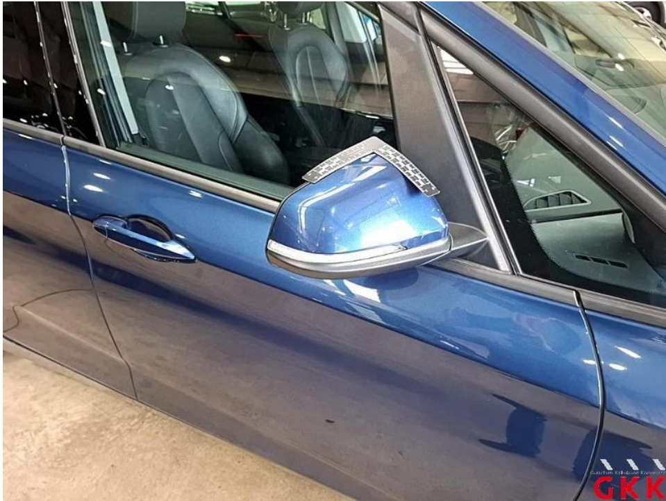
Bild 41. Spiegelgehäuse rechts, Kappe -lackiert-, verkratzt, lackieren
