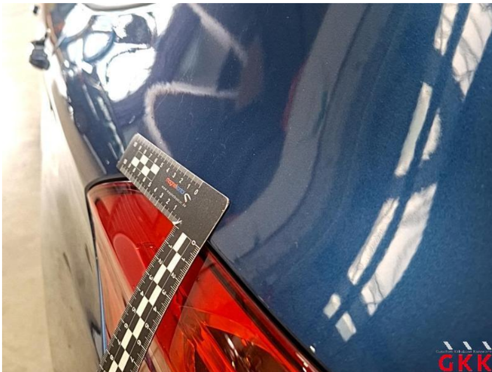
Bild 28. Seitenwand links, Reparaturmangel, aufbereiten
