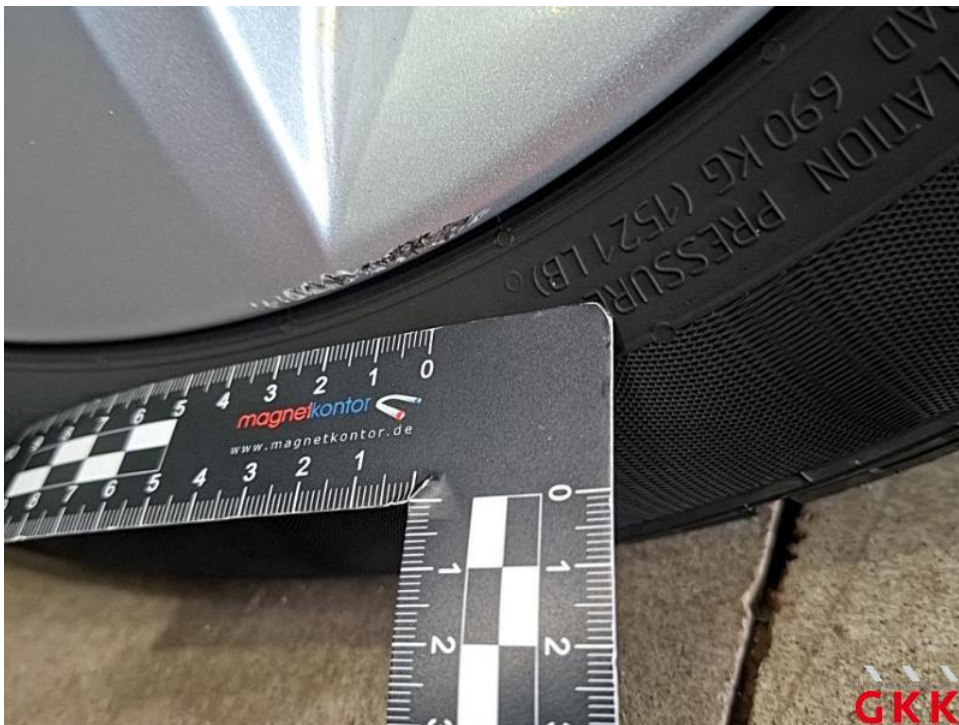
Bild 38. LM-Rad, hinten rechts, verkratzt, lackieren
