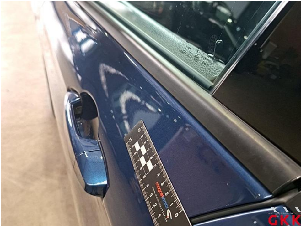
Bild 21. Tür vorne links, Reparaturmangel, aufbereiten
