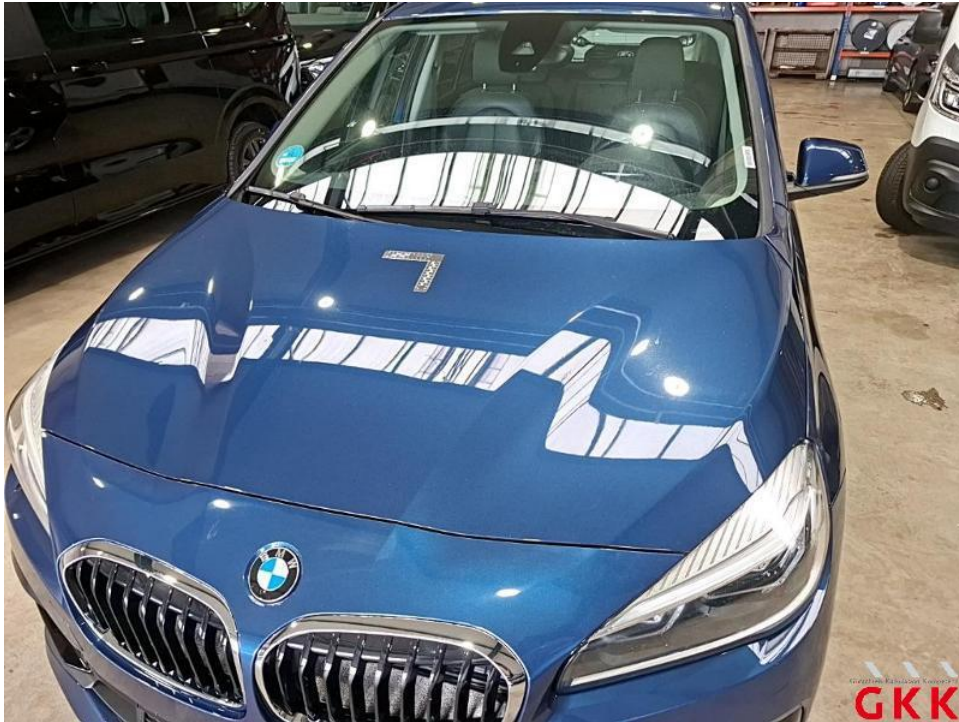
Bild 13. Motorhaube, beschädigt, instand setzen - lackieren
