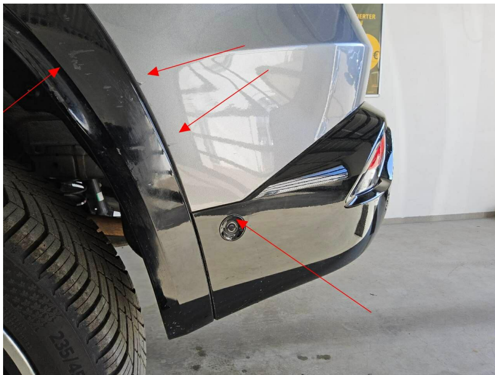
Bild 10 : Anfahrtschaden hinten links
