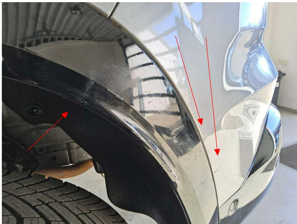
Bild 11 : Anfahrtschaden hinten links
