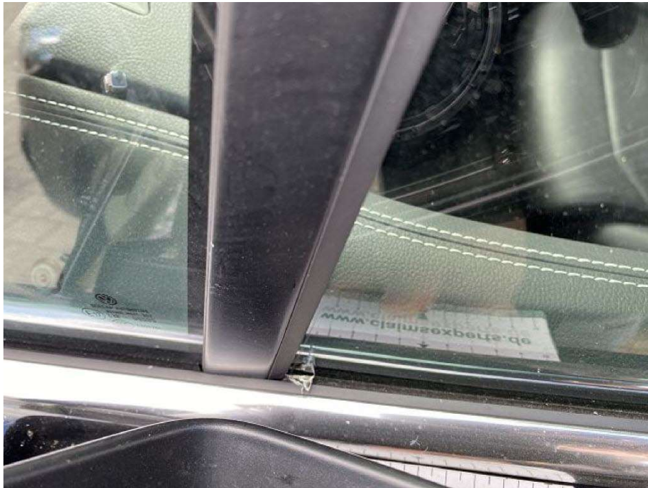
Bild 13 Detailansicht Schachtleiste aussen Tür vorne Fahrzeugseite links verschrammt
