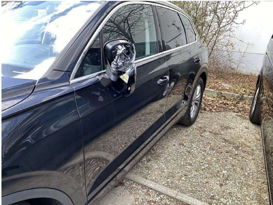
Bild 7 Schadenübersicht Aussenspiegel Fahrzeugseite links gebrochen
