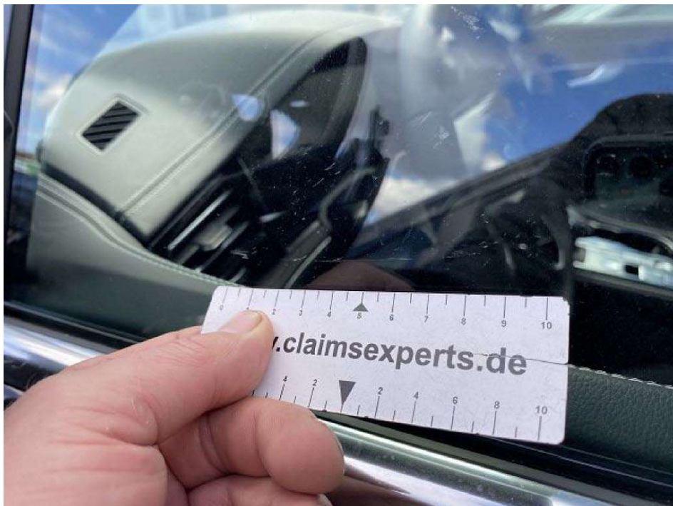
Bild 14 Detailansicht Tür vorne Fahrzeugseite links Fensterscheibe verschrammt
