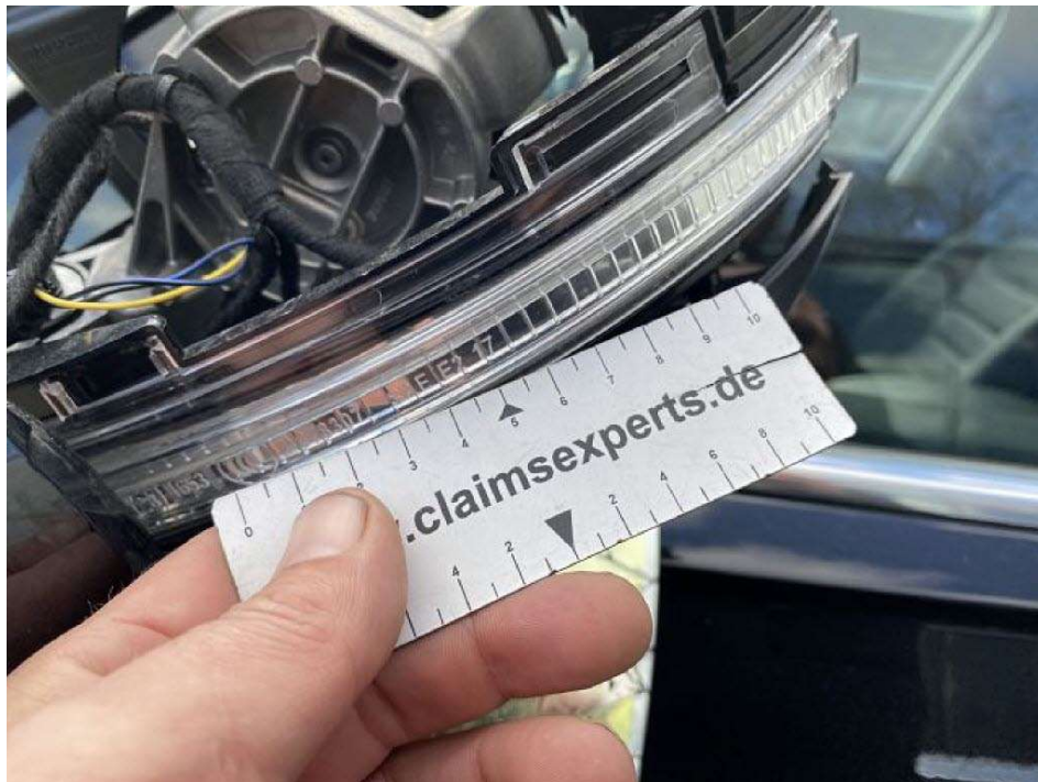
Bild 9 Detailansicht Blinkleuchte Aussenspiegel Fahrzeugseite links gebrochen
