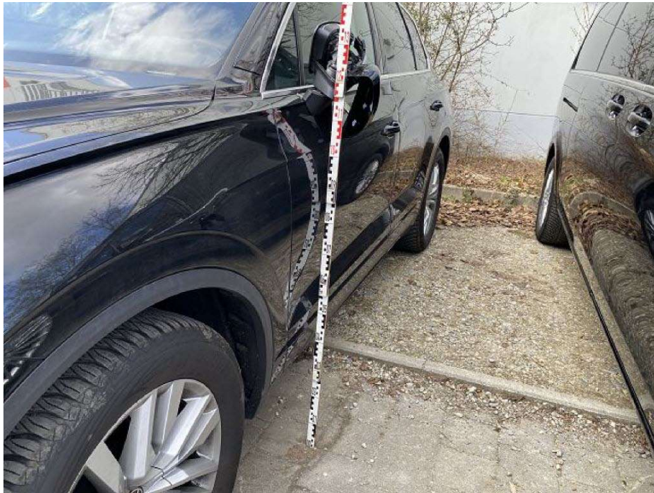
Bild 5 Schadenübersicht mit Höhenmessstab Aussenspiegel Fahrzeugseite links gebrochen
