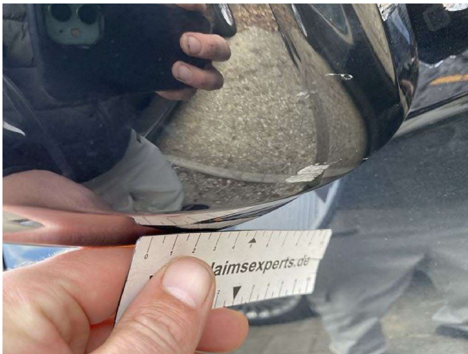
Bild 8 Detailansicht Abdeckkappe Aussenspiegel Fahrzeugseite links verschrammt
