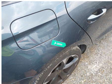
Aleta / Trasero Derecho / Abolladura
