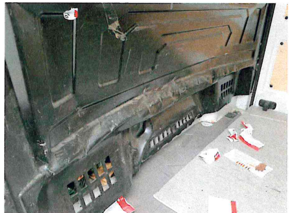
Beschädigung 21: Karosserie: Trennwand - beschädigt - erneuern
