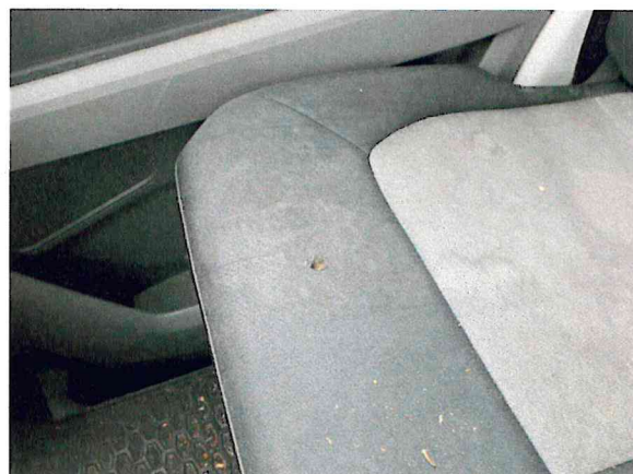
Beschädigung 5: Sitz vorn: Sitzbezug rechts - beschädigt - Wertminderung
