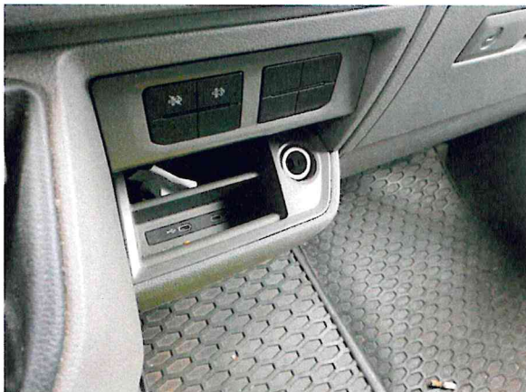
Beschädigung 1: elektrisches System: Steckdose (Adapter) - fehlt - erneuern
