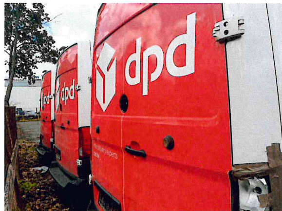
Beschädigung 2: Heckklappe/-tür: Emblem - fehlt - erneuern
