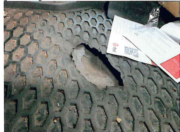
Beschädigung 14: Verkleidungen/Abdeckungen: Bodenbelag vorn links - beschädigt - erneuern
