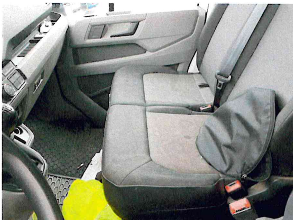
Beschädigung 5: Sitz vorn: Sitzbezug rechts - beschädigt - Wertminderung
