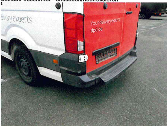
Beschädigung 18: Stossfänger hinten: Rückstrahler links (+ Blende) - beschädigt - erneuern
