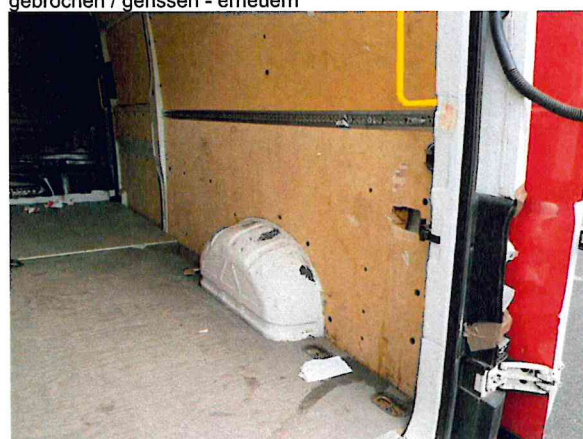
Beschädigung 12: Seitenwand rechts: Innenverkleidung - gebrochen / gerissen - erneuern
