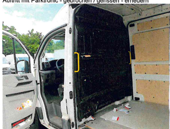
Beschädigung 21: Karosserie: Trennwand - beschädigt - erneuern
