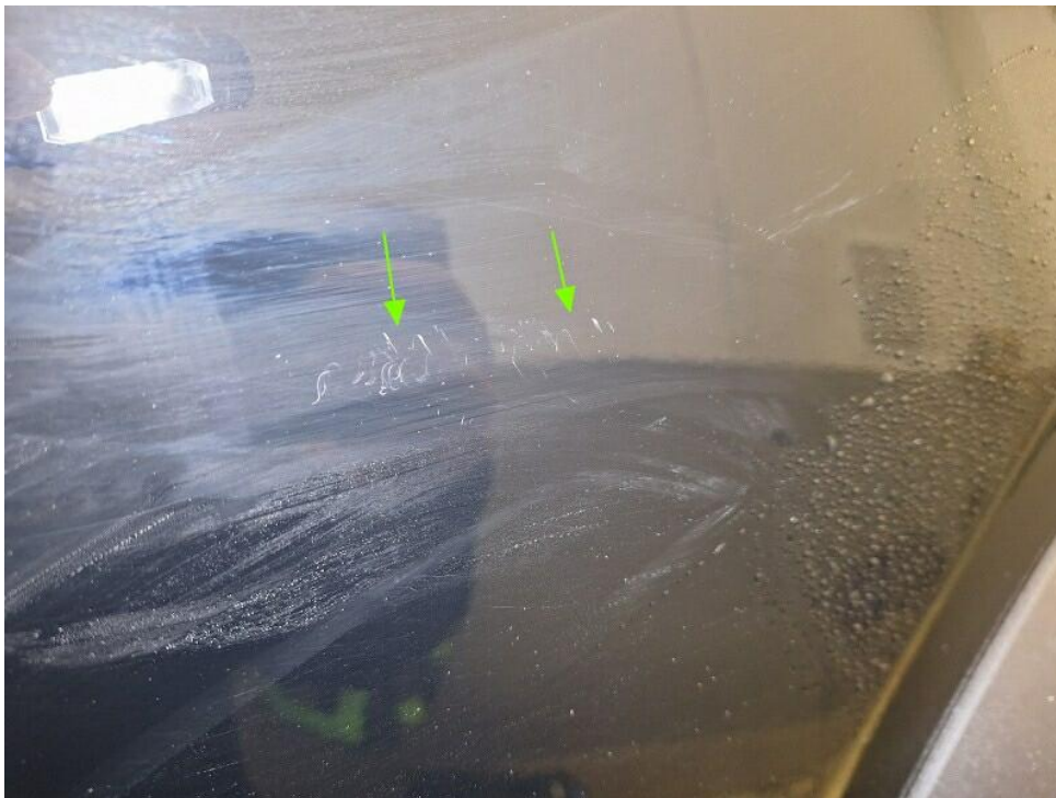
Bild 22 : Tür hinten links eingedellt und verschrammt
