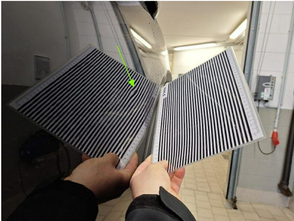
Bild 21 : Tür hinten links eingedellt und verschrammt
