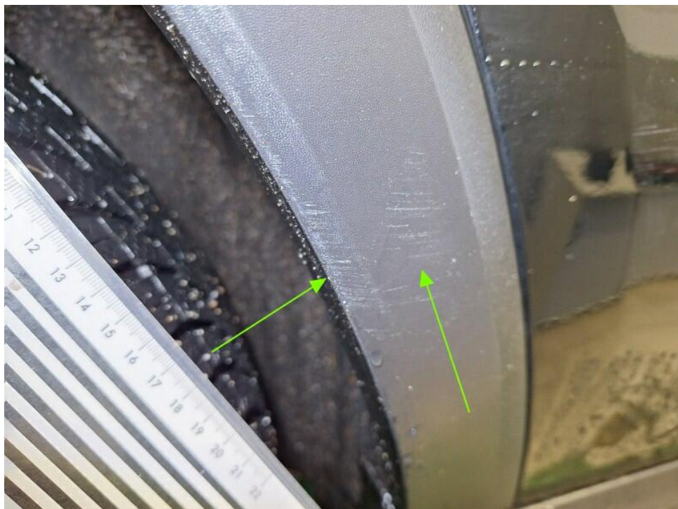
Bild 18 : Streifschaden hinten rechts Tür und Radlaufblende verschrammt
