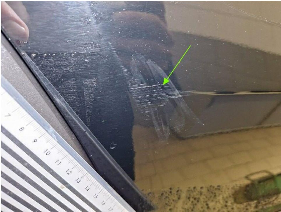
Bild 19 : Streifschaden hinten rechts Tür und Radlaufblende verschrammt
