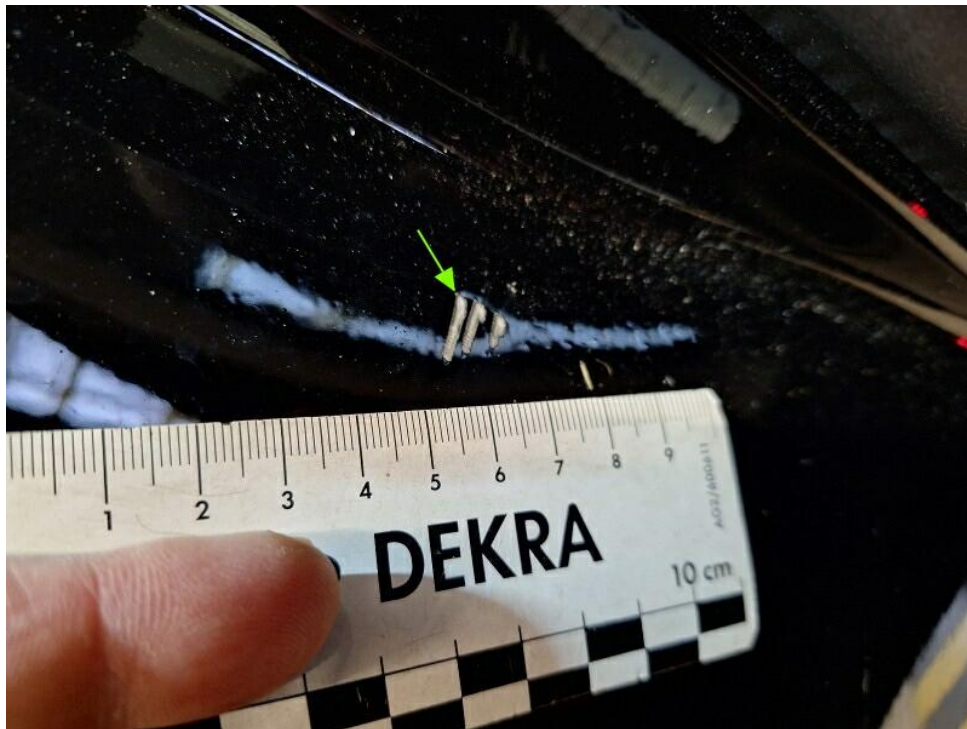
Bild 17 : Türeinstieg hinten rechts mehrfach verkratzt
