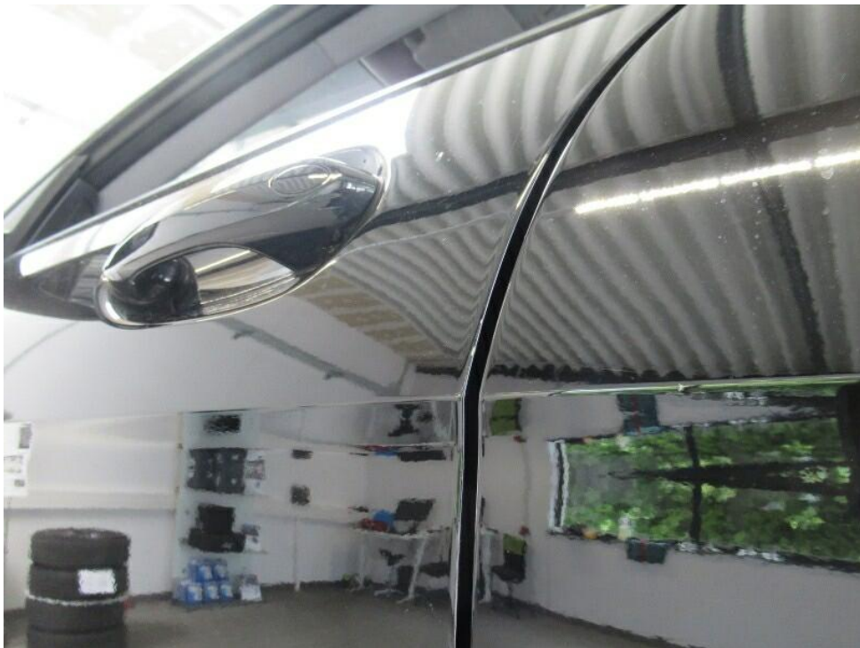
Bild 22 : Tür vorne links Türkante, Lackabplatzer, Gebrauchsspur
