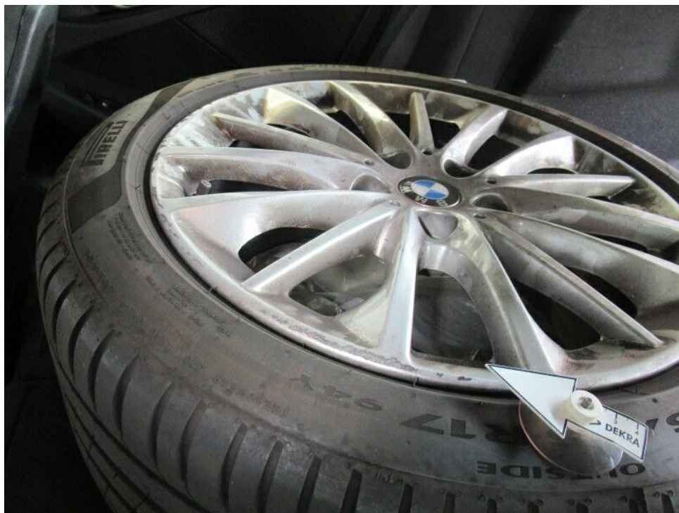
Bild 15 : Felge vorne rechts Lackierung, zerkratzt, lackieren mit Lackaufbau
