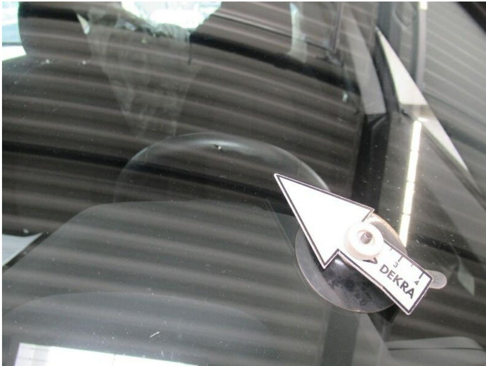
Bild 19 : T - Steinschlag Frontscheibe mit Rissbildung im Fahrersichtfeld
