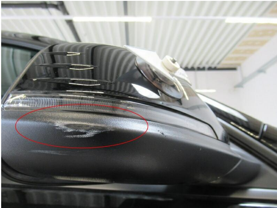
Bild 21 : Untere Abdeckkappe Außenspiegel rechts verkratzt
