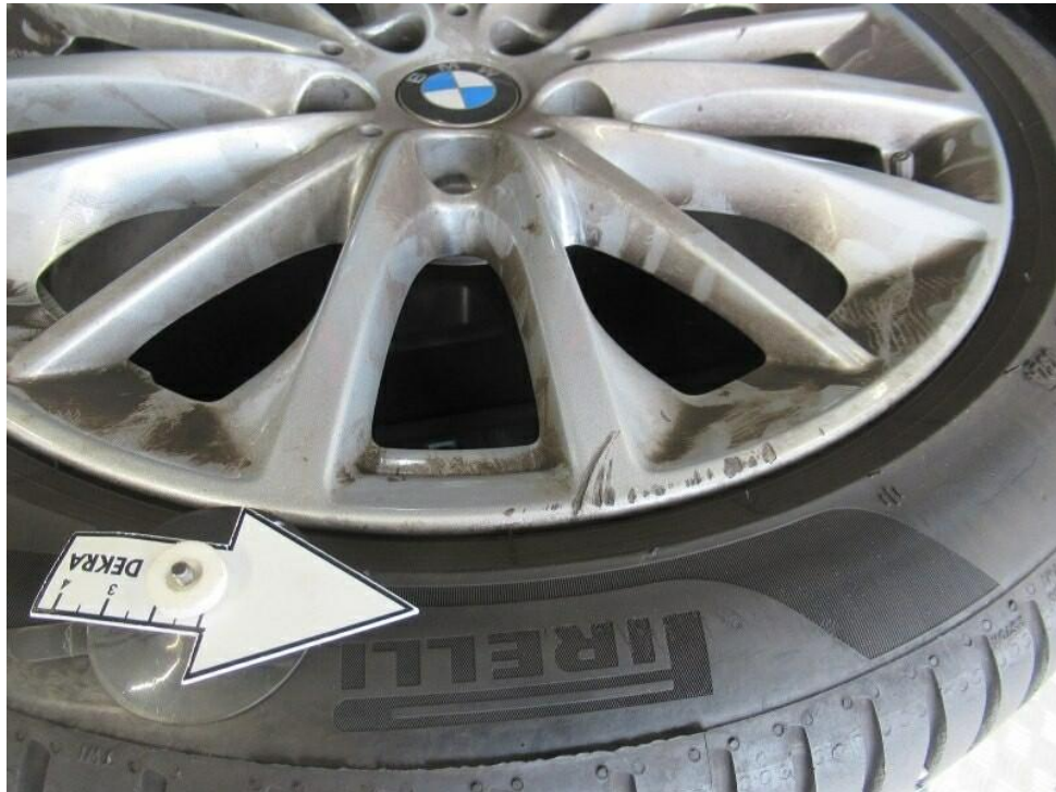
Bild 17 : Felge hinten rechts Lackierung, zerkratzt, lackieren mit Lackaufbau
