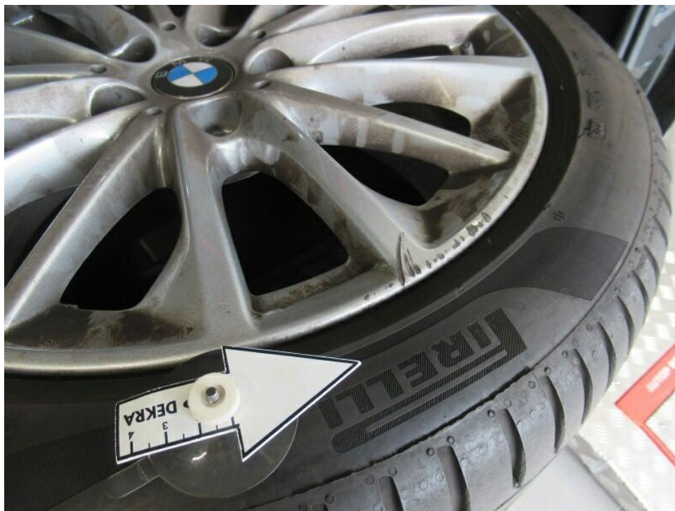
Bild 16 : Felge hinten rechts Lackierung, zerkratzt, lackieren mit Lackaufbau
