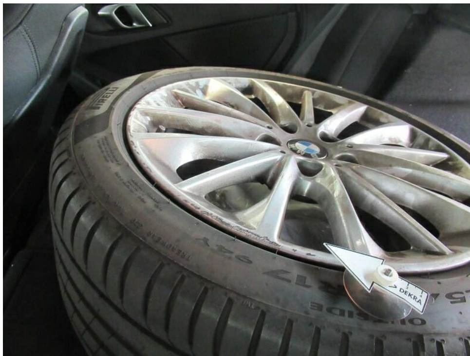
Bild 14 : Felge vorne rechts Lackierung, zerkratzt, lackieren mit Lackaufbau
