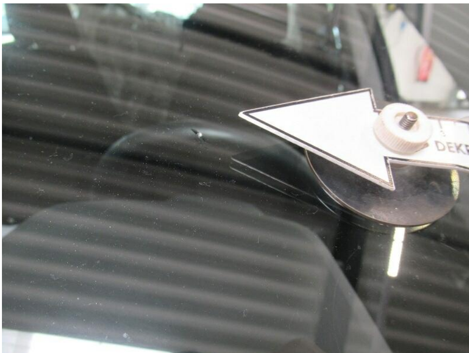
Bild 20 : T - Steinschlag Frontscheibe mit Rissbildung im Fahrersichtfeld
