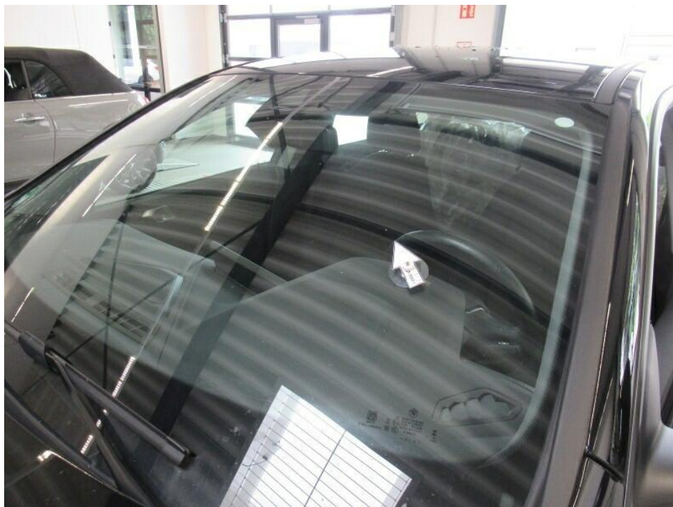
Bild 18 : T - Steinschlag Frontscheibe mit Rissbildung im Fahrersichtfeld
