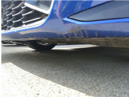
Stoßfänger / Vorne / Delle
