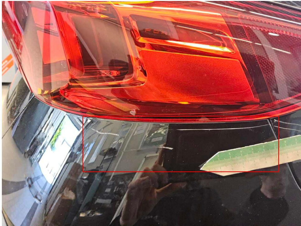
Bild 13 : Stoßfänger hinten Lackierung, zerkratzt, smart repair
