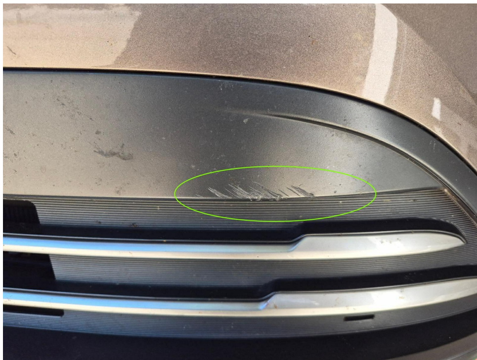
Bild 9 : Stoßfänger vorn Mittelstück verschrammt und deformiert
