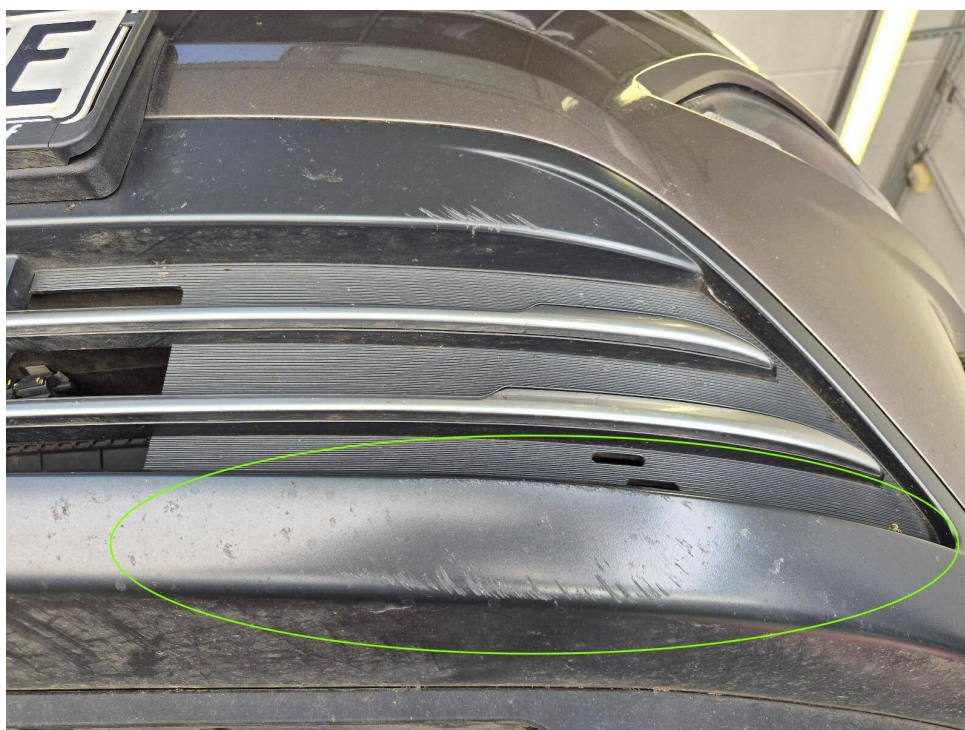
Bild 10 : Stoßfänger vorn Mittelstück verschrammt und deformiert
