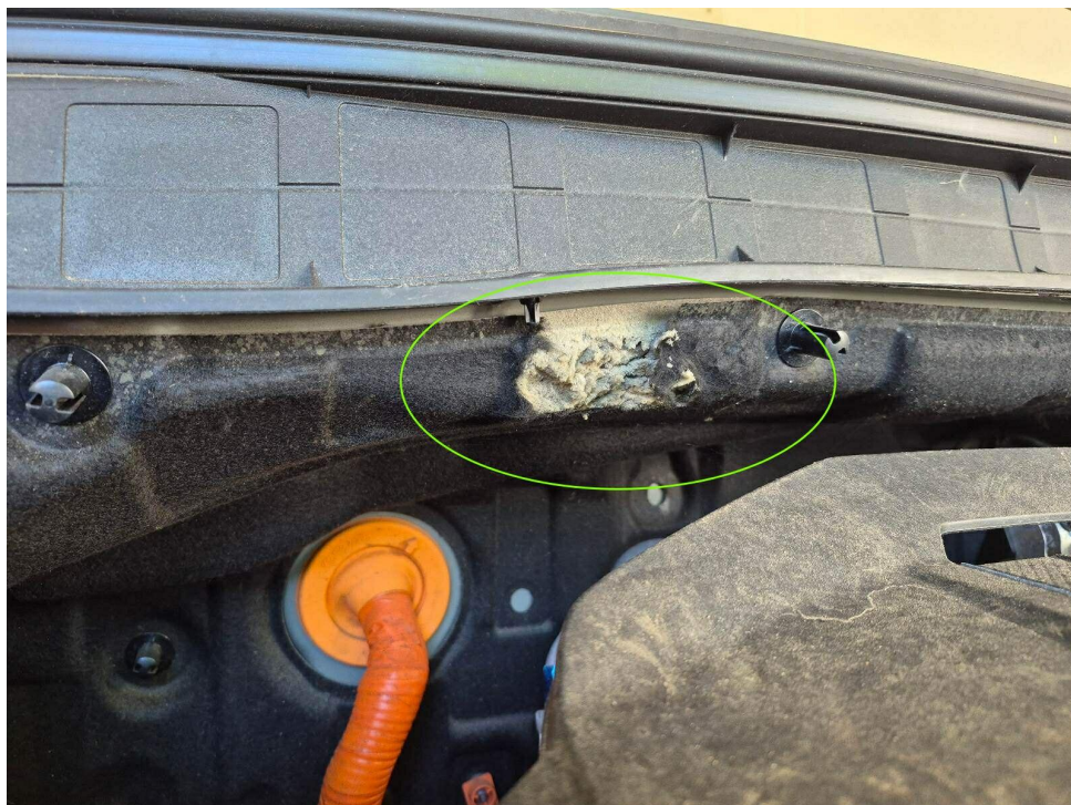
Bild 8 : Dämmmatte Spritzwand beschädigt
