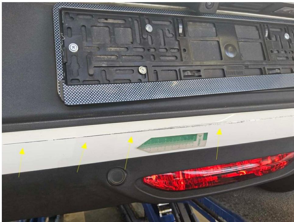
Bild 15 : Stoßfänger hinten Lackierung, verschrammt, lackieren mit Lackaufbau
