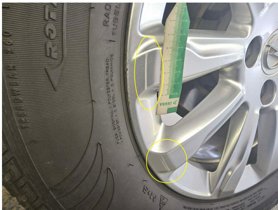
Bild 27 : LM Felge hinten links zerkratzt
