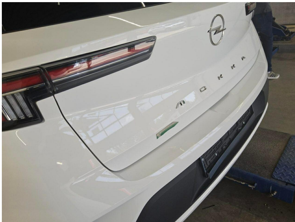
Bild 19 : Heckklappe Lackierung, zerkratzt, Gebrauchsspur
