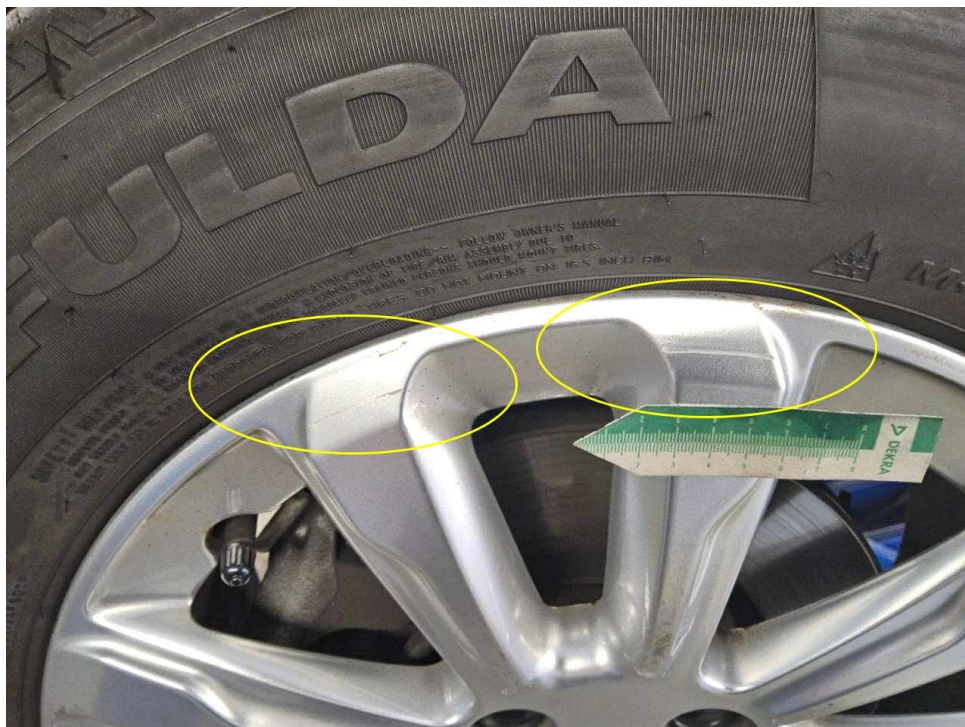
Bild 26 : LM Felge vorne links, zerkratzt
