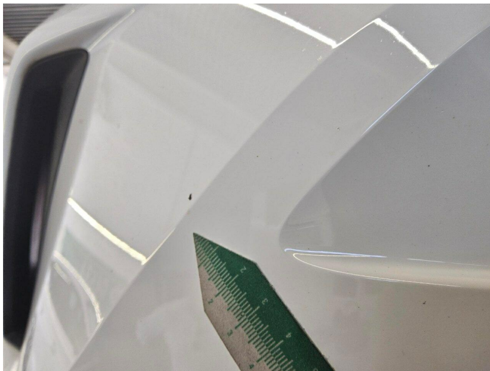
Bild 18 : Stoßfänger vorne Lackierung, Steinschlag, Gebrauchsspur
