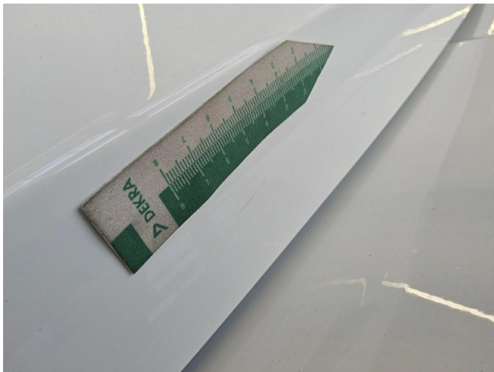
Bild 20 : Heckklappe Lackierung, zerkratzt, Gebrauchsspur
