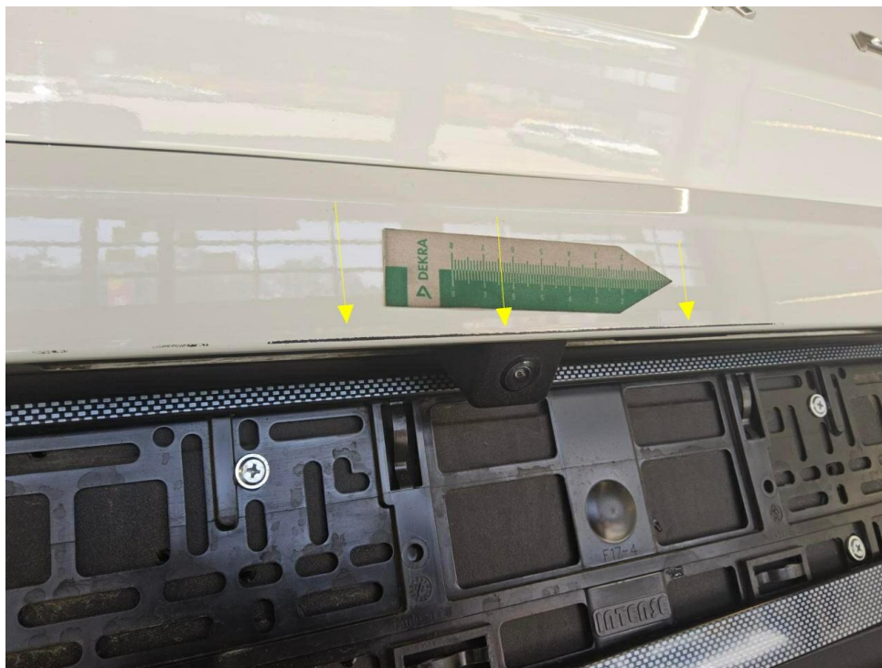
Bild 16 : Stoßfänger hinten Lackierung, verschrammt, lackieren mit Lackaufbau
