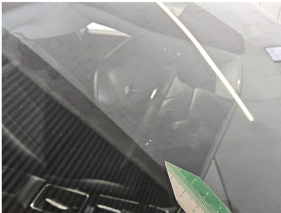
Bild 22 : Frontscheibe, Steinschlag, Gebrauchsspur
