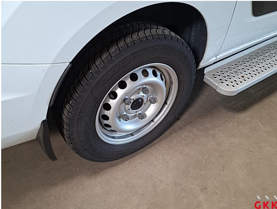
Bild 21 Radkappe(n), hinten rechts, fehlt, ersetzen
