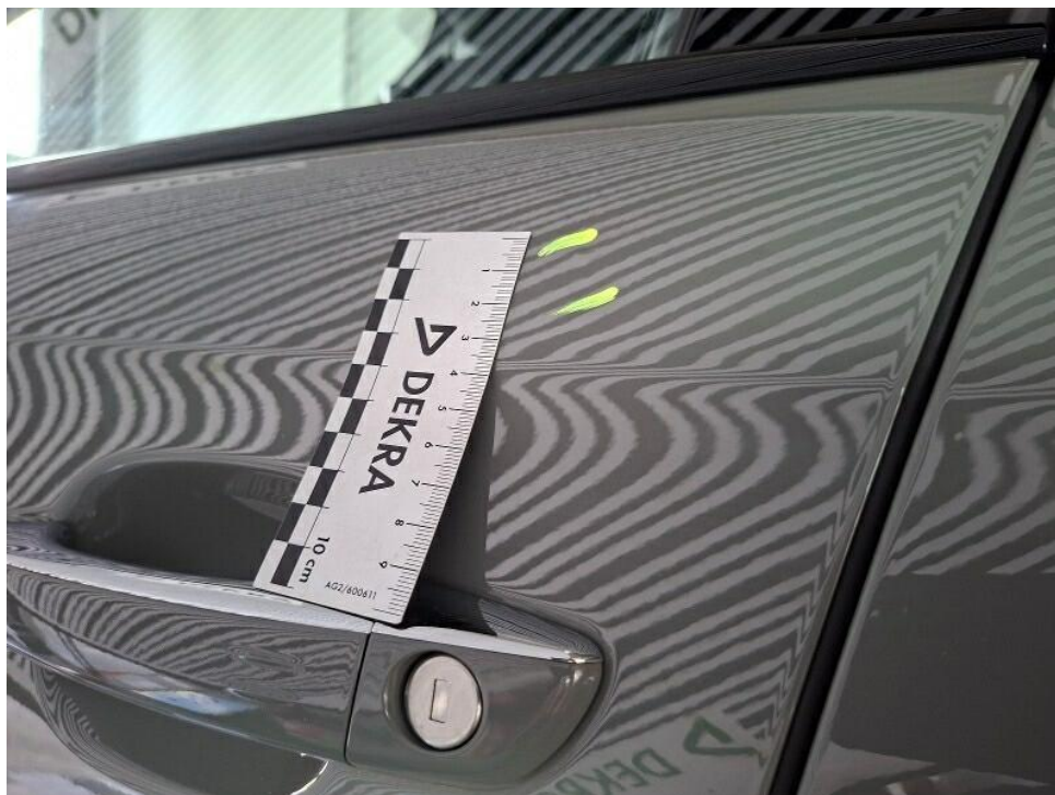
Bild 20 : Tür vorne links mehrfach eingedellt <20mm
