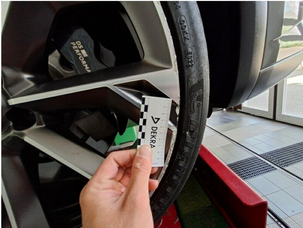
Bild 25 : Scheibenrad vorne rechts mehrfach verschrammt
