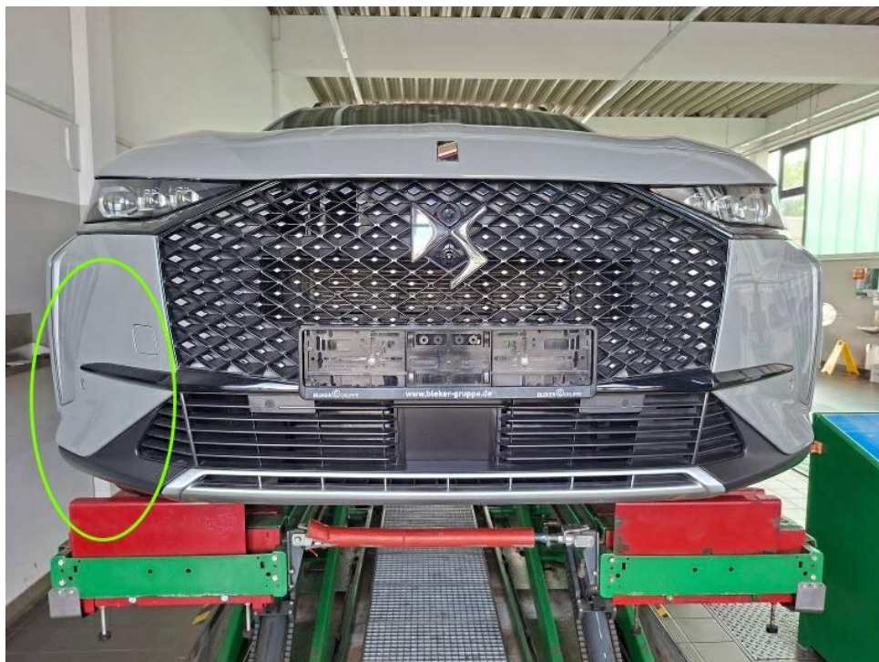
Bild 14 : Stoßfängerverkleidung vorne rechtsseitig streifend zerkratzt
