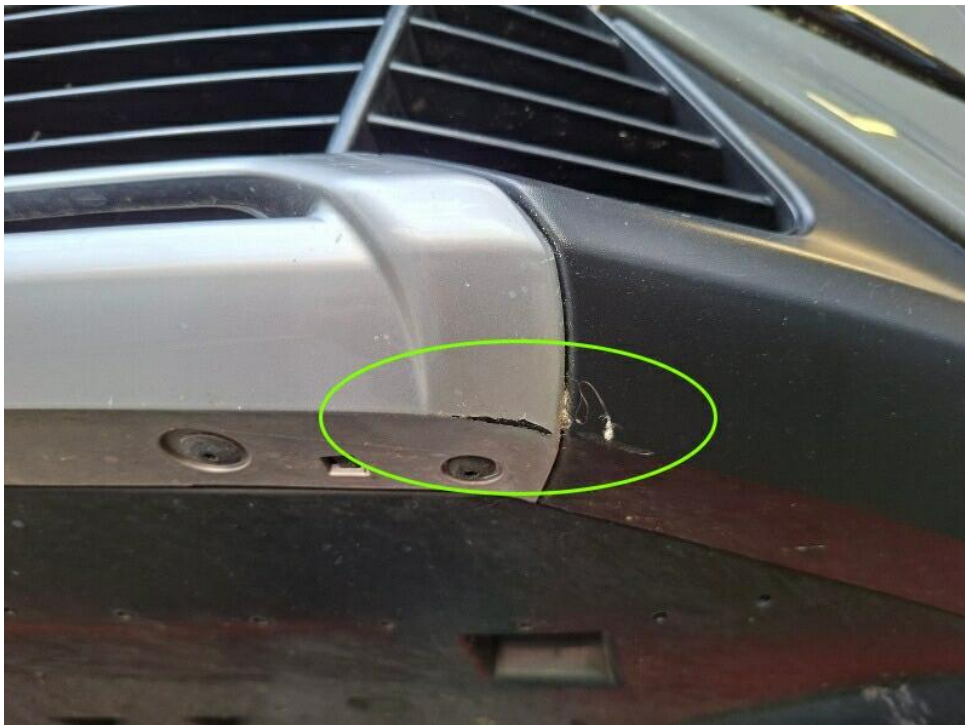
Bild 16 : Stoßfängerzierleiste links unterhalb verschrammt
