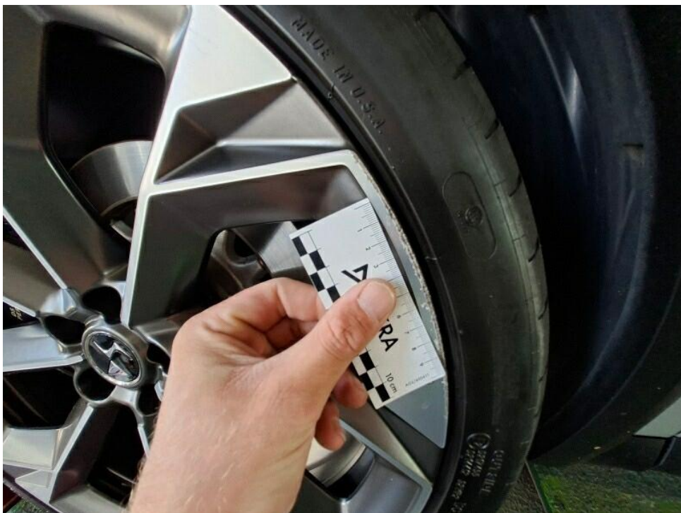
Bild 26 : Scheibenrad vorne links mehrfach verschrammt
