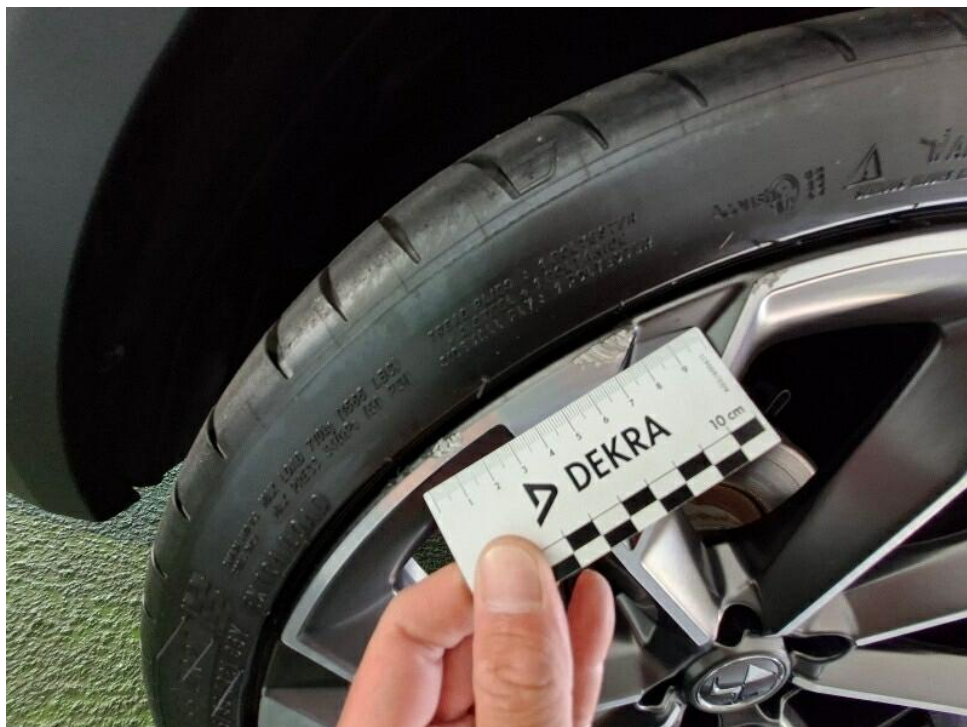
Bild 28 : Scheibenrad hinten rechts mehrfach verschrammt
