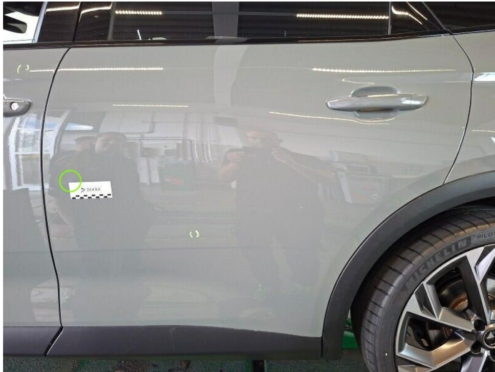
Bild 21 : Tür hinten links punktuell eingedellt <20mm sowie im vorderen Bereich zerkratzt
