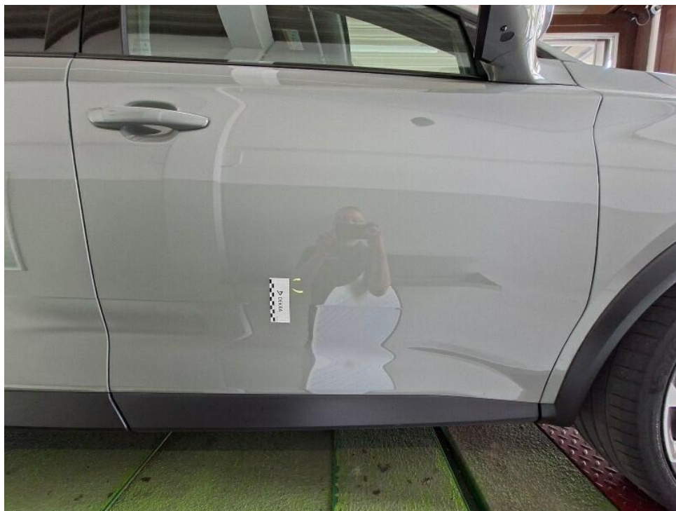
Bild 23 : Tür vorne rechts punktuell eingedellt <20mm
