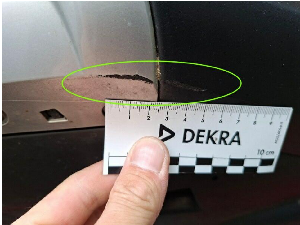
Bild 17 : Stoßfängerzierleiste links unterhalb verschrammt
