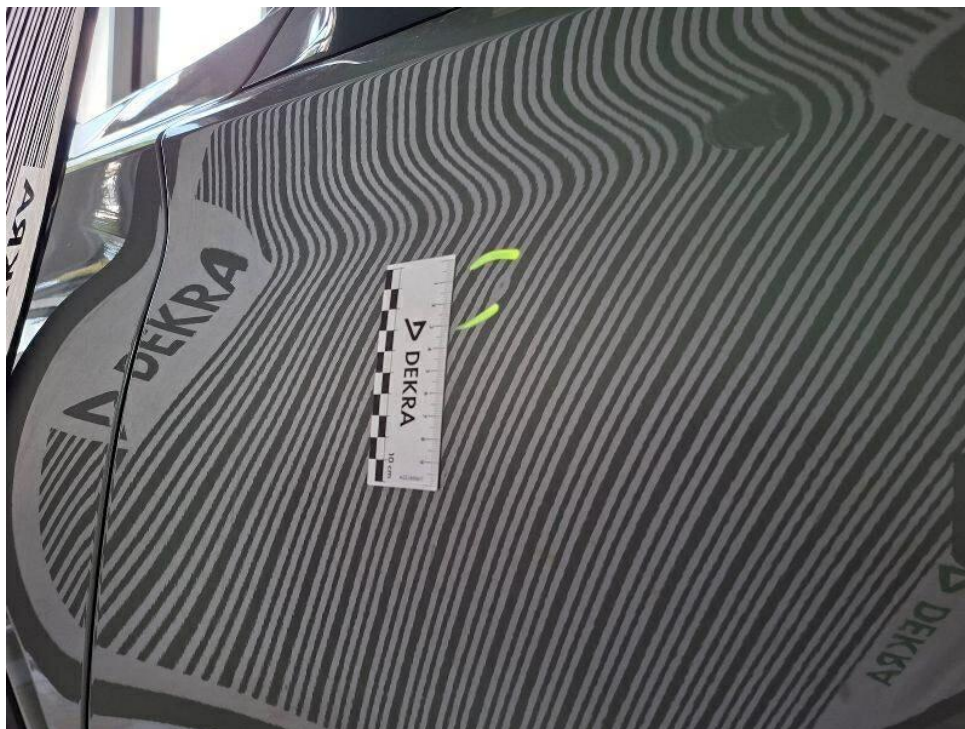
Bild 19 : Tür vorne links mehrfach eingedellt <20mm
