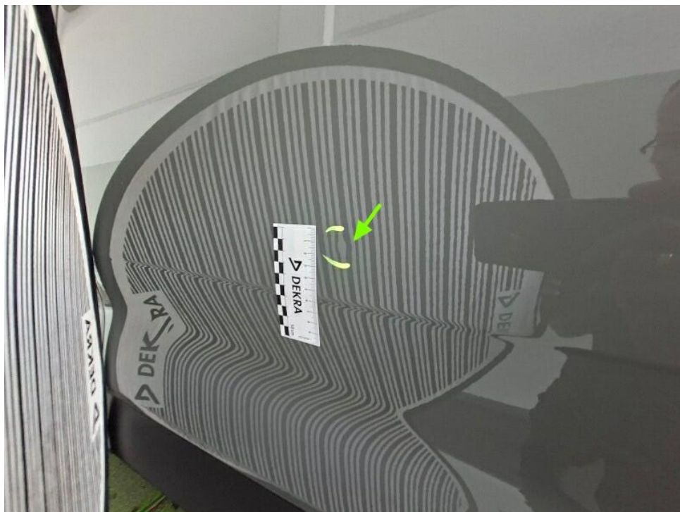
Bild 24 : Tür vorne rechts punktuell eingedellt <20mm
