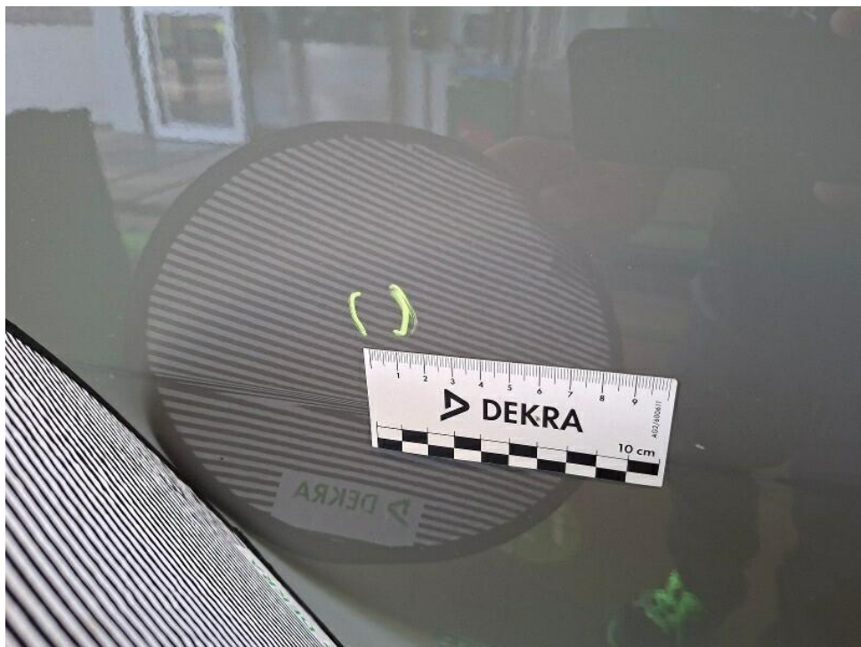
Bild 22 : Tür hinten links punktuell eingedellt <20mm sowie im vorderen Bereich zerkratzt
