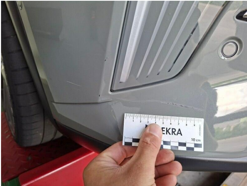
Bild 15 : Stoßfängerverkleidung vorne rechtsseitig streifend zerkratzt
