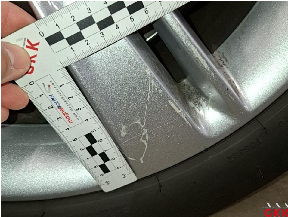
Bild 17 LM-Rad, vorne links, verkratzt, Smartrepair
