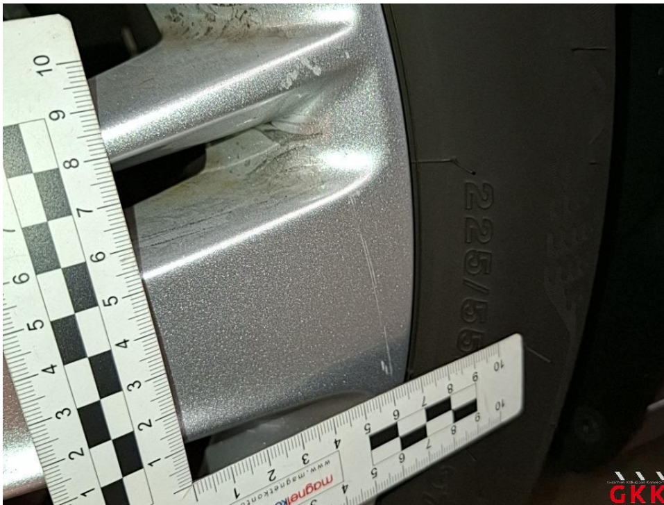
Bild 18 LM-Rad, vorne links, verkratzt, Smartrepair
