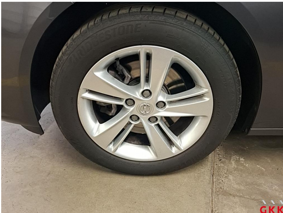
Bild 16 LM-Rad, vorne links, verkratzt, Smartrepair
