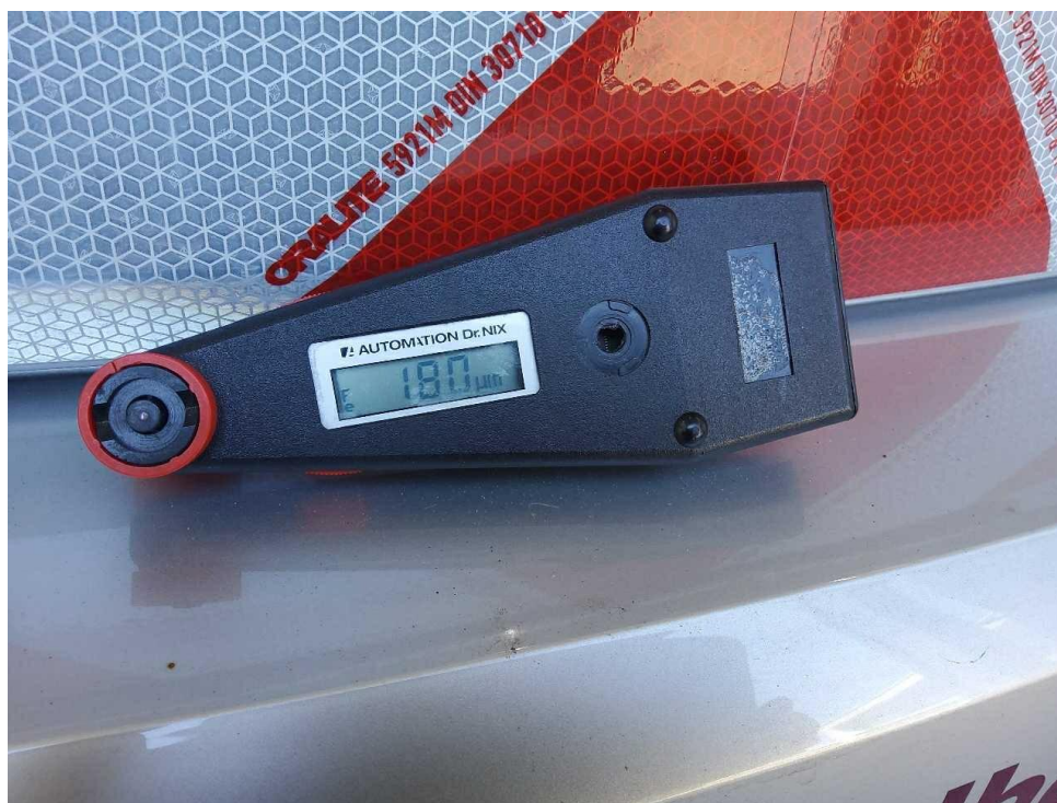
Bild 24 : Heckklappe unterhalb Nachlackiert.
