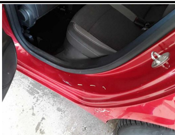
Beschädigung #5: Seitenwand links: Einstieg - verkratzt / verschürft - Smart Repair
