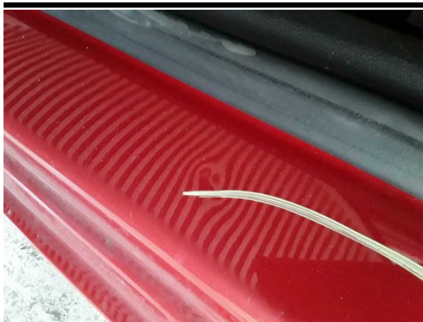
Beschädigung #8: Schweller links: Einstieg - Delle / Lackschade... Smart Repair
