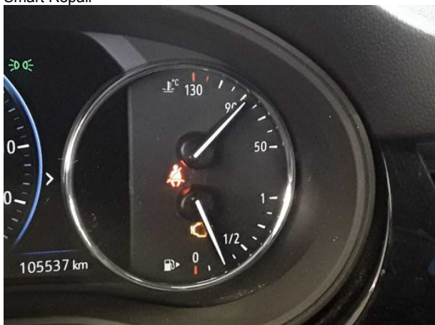
Beschädigung #9: Instrumententafel: Kontrollleuchte (Motorkontrollleuchte leuchtet) - Befund festlegen - Diagnose
