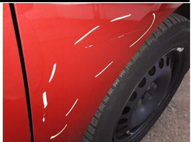
Beschädigung #11: Kotflügel rechts: Kotflügel rechts - verkratzt / verschürft - instandsetzen und lackieren
