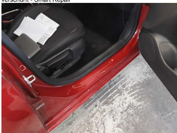
Beschädigung #6: Schweller rechts: Einstieg - verkratzt / verschürft - reinigen
