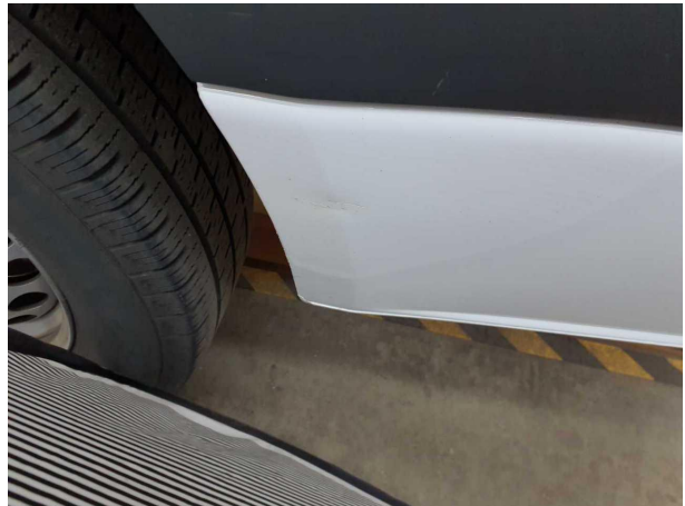
Beschädigung #11: Seitenwand links: Seitenwand (Beplankung HLU) - Delle / Lackschaden - instandsetzen und lackieren
