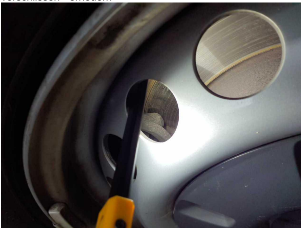
Beschädigung #14: Bremsanlage: Bremsscheiben und Beläge hinten... verschlissen - erneuern
