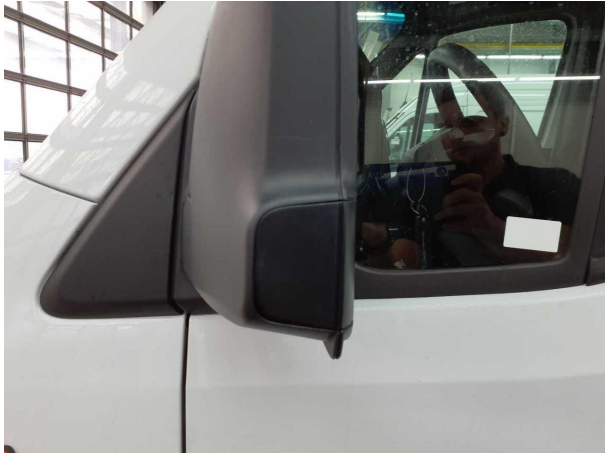
Beschädigung #1: Außenspiegel links: Abdeckkappe - gebrochen / gerissen - erneuern
