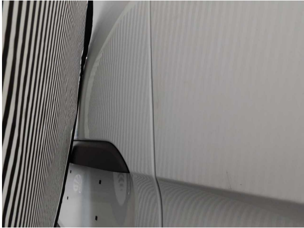
Beschädigung #17: Heckklappe/-tür: Hecktür links (Kantenbereich) - verformt - instandsetzen und lackieren
