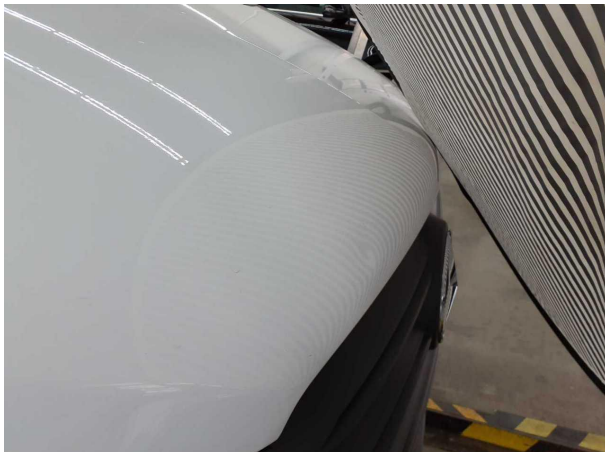
Beschädigung #4: Motorhaube: Motorhaube - Delle(n) - Smart Repair
