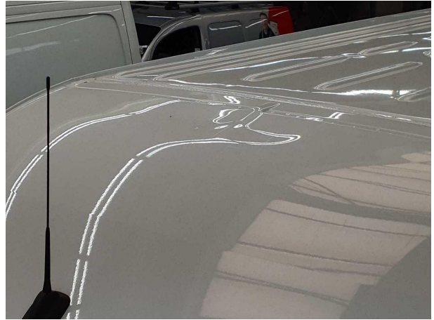
Beschädigung #18: Fahrzeugdach: Dach - verformt - instandsetzen/lackieren (S2)
