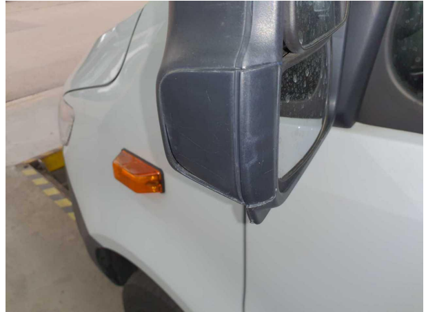
Beschädigung #1: Außenspiegel links: Abdeckkappe - gebroche... gerissen - erneuern
