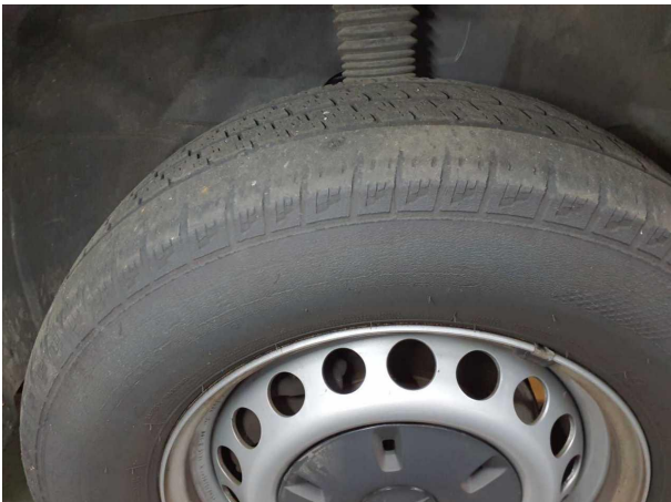
Beschädigung #12: Rad/Reifen: Reifen vorn - verschlissen - erneuern
