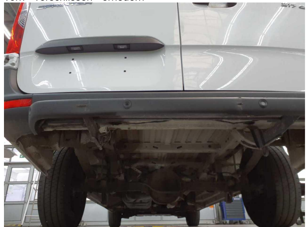
Beschädigung #15: Stossfänger hinten: Verkl. Stossfänger Auftritt mit Parktronic (Kostenausweitung möglich) - gebrochen / gerissen -
