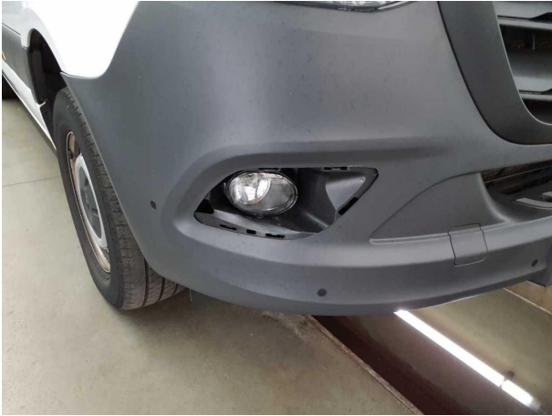
Beschädigung #5: Nebelleuchte: Nebelleuchte vorn links (Verkleidung + rechts) - fehlt - erneuern
