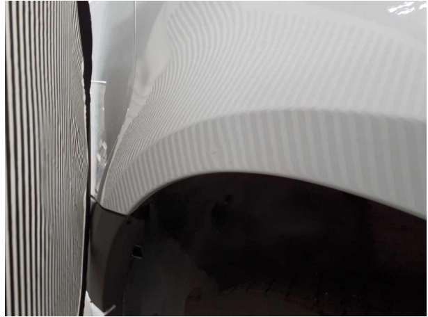
Beschädigung #6: Kotflügel rechts: Kotflügel rechts - Delle / Lackschaden - Smart Repair
