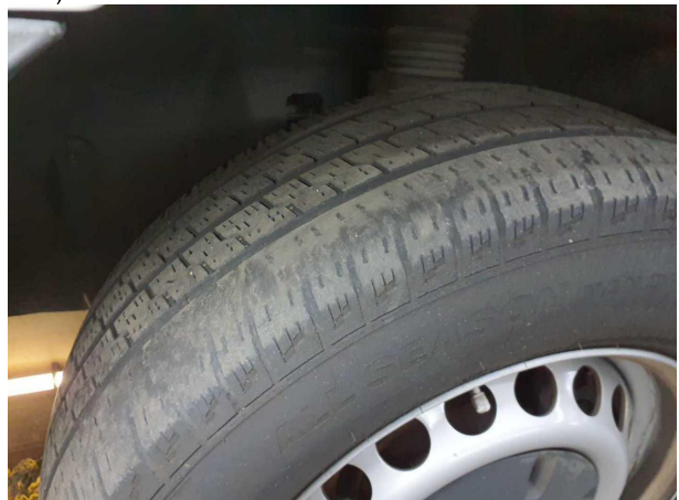
Beschädigung #12: Rad/Reifen: Reifen vorn - verschlissen - erneuern
