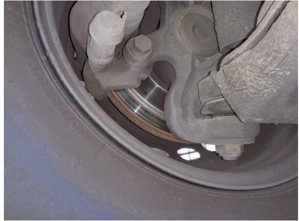
Beschädigung #13: Bremsanlage: Bremsscheiben und Beläge vorn - verschlissen - erneuern
