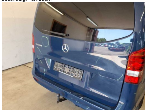
Beschädigung #22: Heckklappe/-tür: Heckklappe - Delle / Lackschaden - erneuern
