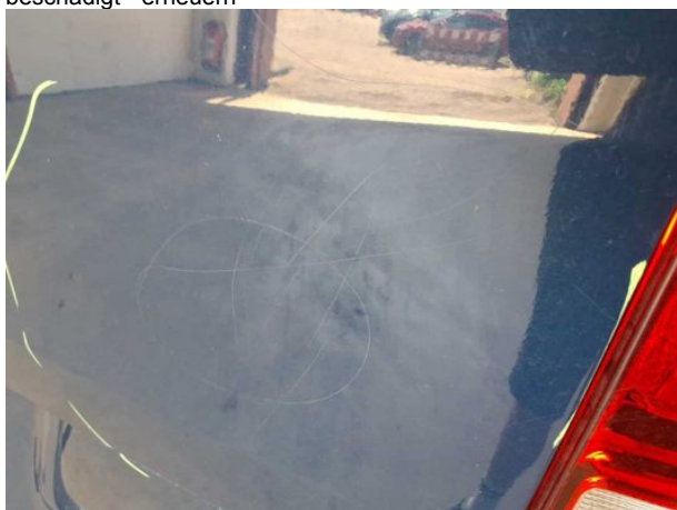
Beschädigung #22: Heckklappe/-tür: Heckklappe - Delle / Lackschaden - erneuern
