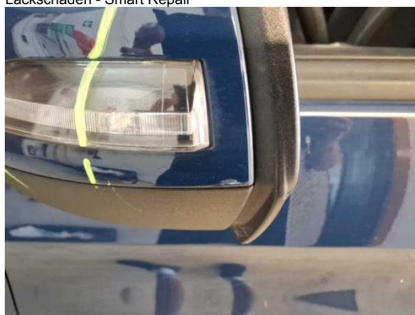
Beschädigung #9: Außenspiegel links: Abdeckkappe - verkratzt / verschürft - Smart Repair
