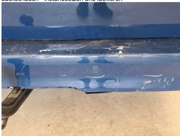
Beschädigung #20: Stossfänger hinten: Stossfänger hinten - beschädigt - erneuern
