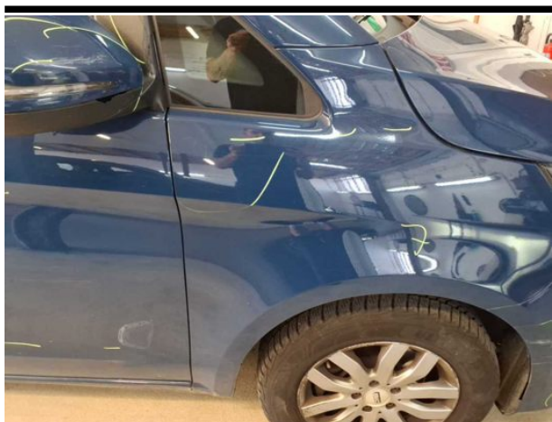
Beschädigung #13: Kotflügel rechts: Kotflügel rechts - verkratzt / verschürft - instandsetzen und lackieren
