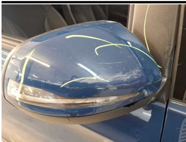
Beschädigung #10: Außenspiegel rechts: Abdeckkappe - beschädigt - erneuern
