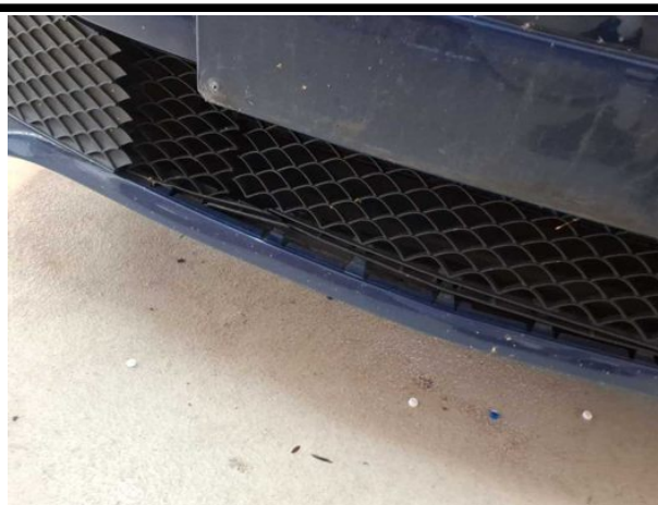
Beschädigung #21: Stossfänger vorn: Stossfänger vorn - beschädigt - erneuern
