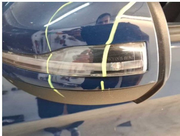
Beschädigung #3: Blinkleuchte: Spiegel links - beschädigt - erneuern
