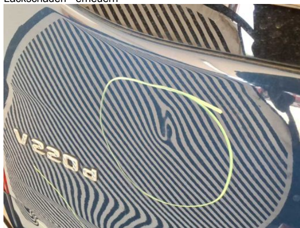
Beschädigung #22: Heckklappe/-tür: Heckklappe - Delle / Lackschaden - erneuern
