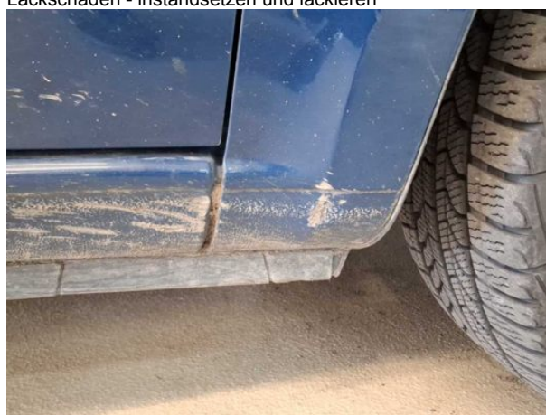
Beschädigung #14: Schweller rechts: Schweller - Delle / Lackschaden - instandsetzen und lackieren
