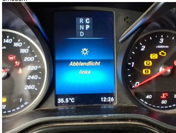
Beschädigung #5: elektrisches System: Lichanlage - erneuern
