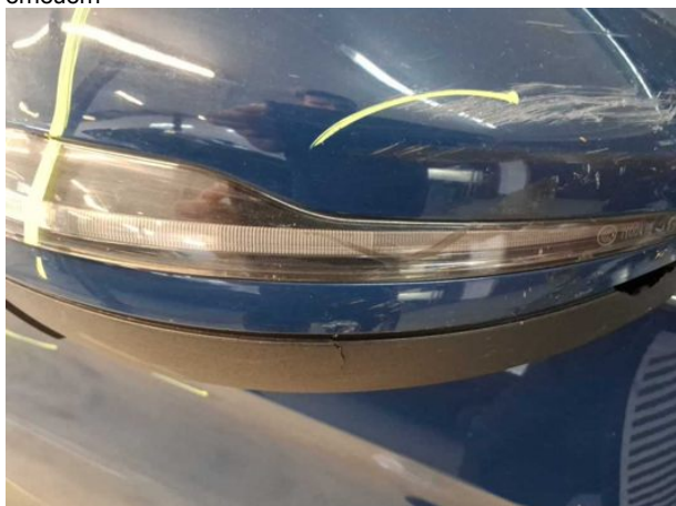
Beschädigung #4: Blinkleuchte: Spiegel rechts - beschädigt - erneuern
