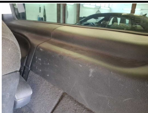
Beschädigung #11: Interieur: Innenraum - verkratzt / versch... - Wertminderung
