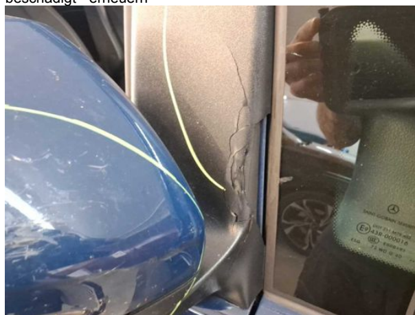
Beschädigung #12: Außenspiegel rechts: Spiegelgehäuse - beschädigt - erneuern
