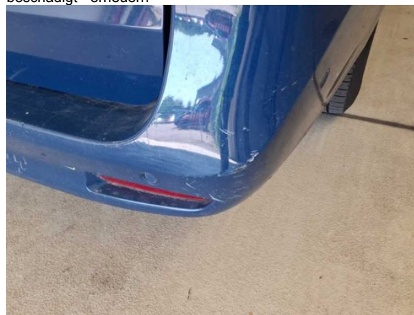
Beschädigung #20: Stossfänger hinten: Stossfänger hinten - beschädigt - erneuern
