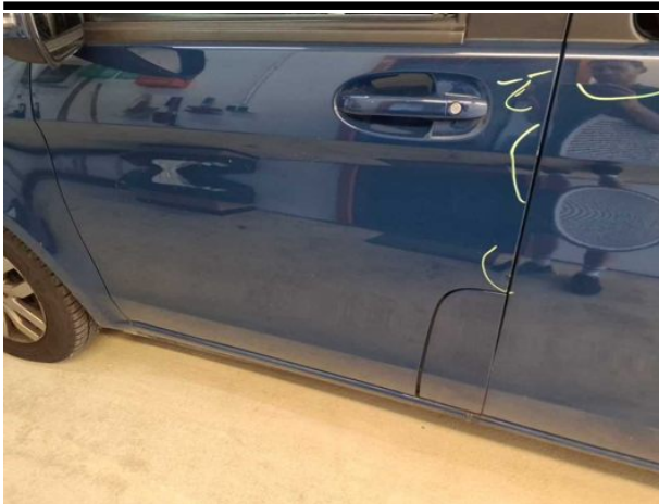
Beschädigung #16: Tür vorn links: Tür - verkratzt / verschürft - instandsetzen und lackieren
