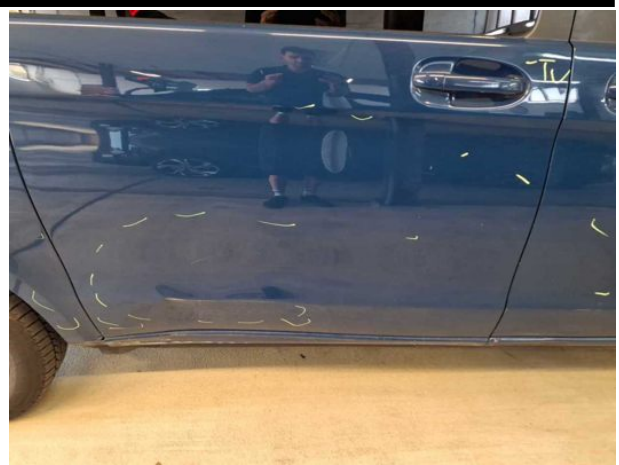
Beschädigung #23: Schiebetür rechts: Schiebetür mit Glasscheibe - Delle / Lackschaden - erneuern
