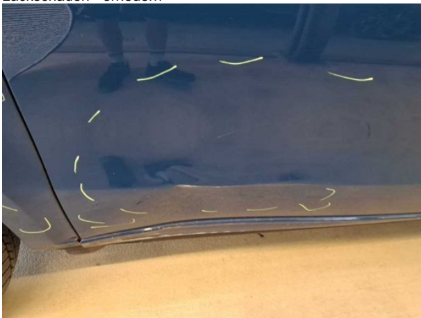
Beschädigung #23: Schiebetür rechts: Schiebetür mit Glasschei... - Delle / Lackschaden - erneuern
