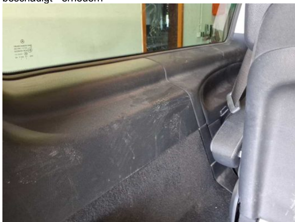
Beschädigung #11: Interieur: Innenraum - verkratzt / verschürft - Wertminderung
