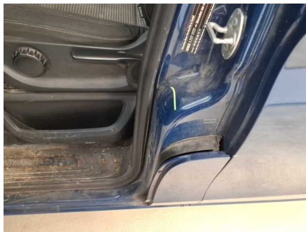
Beschädigung #8: Schweller links: Einstieg - Delle / Lackschaden - Smart Repair
