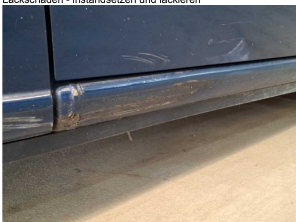
Beschädigung #14: Schweller rechts: Schweller - Delle / Lackschaden - instandsetzen und lackieren
