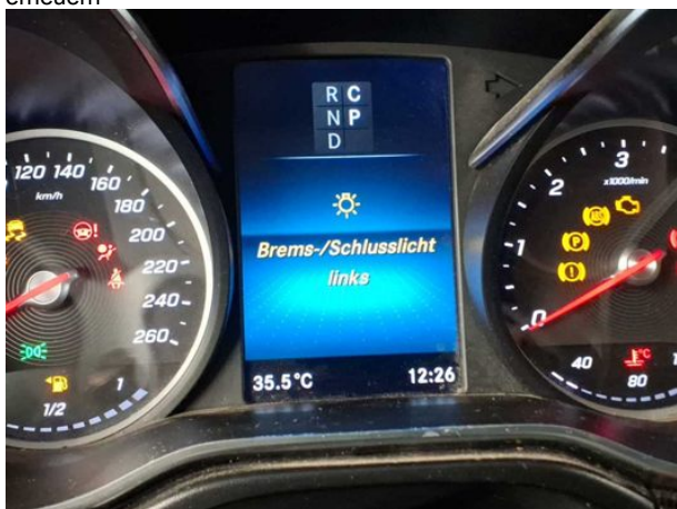
Beschädigung #5: elektrisches System: Lichanlage - erneuern
