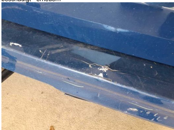
Beschädigung #20: Stossfänger hinten: Stossfänger hinten - beschädigt - erneuern
