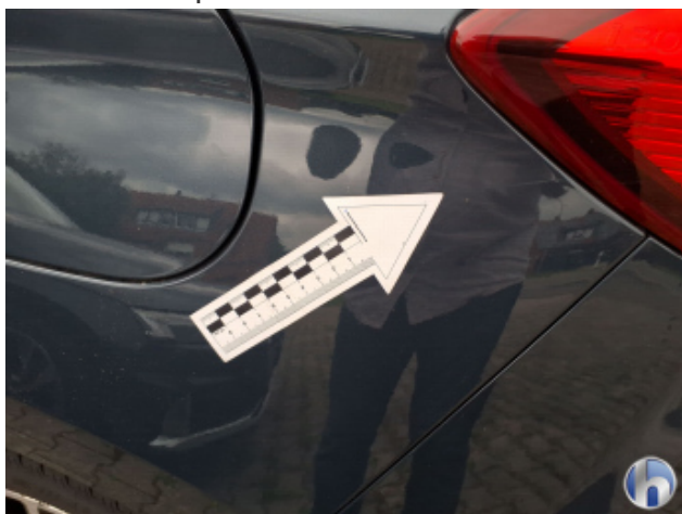
3. Seitenwand - Hinten - Links Oberflächenkratzer - Auslegen / Polieren
