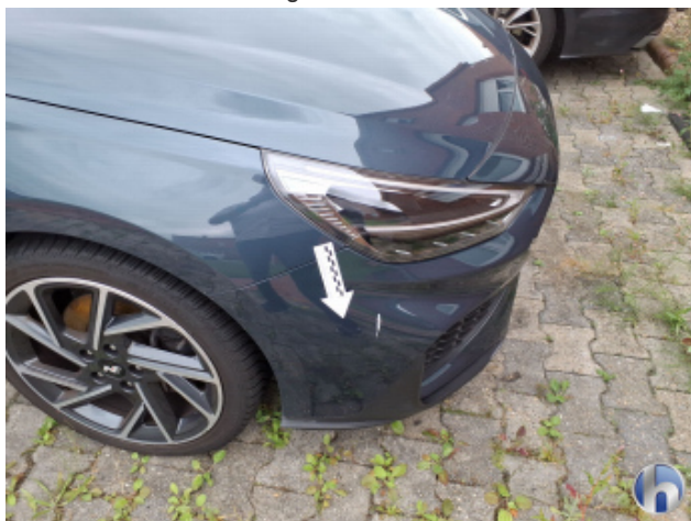
4. Kotflügel Vorne - Rechts Kratzer - Smart Repair
