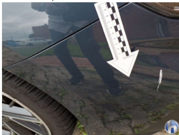
4. Kotflügel Vorne - Rechts Kratzer - Smart Repair
