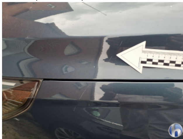
8. Motorhaube Kratzer - Lackieren
