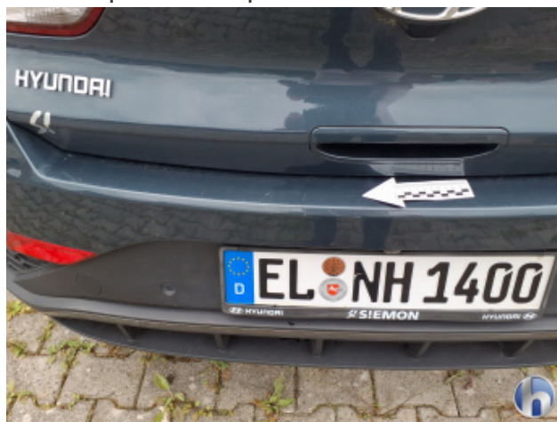
11. Stoßfänger Hinten Kratzer - Lackieren
