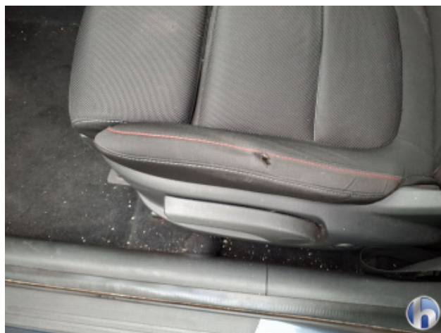
13. Sitz Innenraum links vorne Riss - Erneuern
