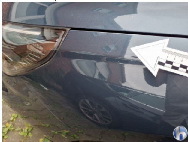
5. Kotflügel Vorne - Links Kratzer - Lackieren
