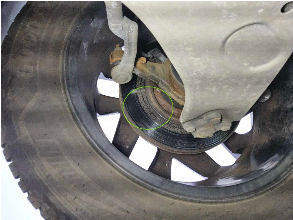
Bild 15 : Tragbild Bremsscheiben vorn mangelhaft
