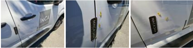
Door trim RR, Scratch(es), Replace
