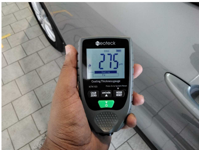
Door - front left side: 275 µm
