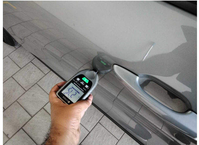
Door - front left side: 275 µm
