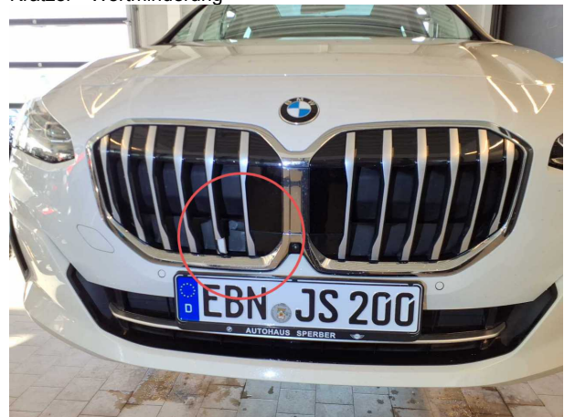
Beschädigung 7: Motorhaube: Kühlergrill - gebrochen / gerissen - erneuern
