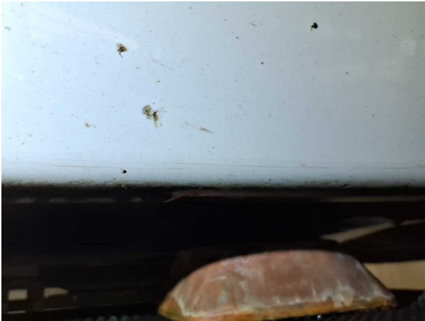
Beschädigung 4: Schweller rechts: Verkleidung - Kratzer - Smart Repair
