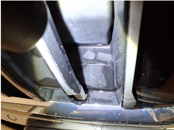
Beschädigung 7: Motorhaube: Kühlergrill - gebrochen / gerissen - erneuern
