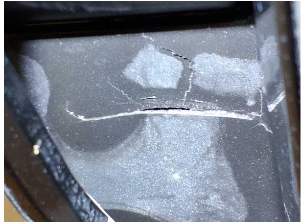
Beschädigung 7: Motorhaube: Kühlergrill - gebrochen / gerissen - erneuern
