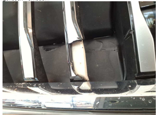
Beschädigung 7: Motorhaube: Kühlergrill - gebrochen / gerissen - erneuern
