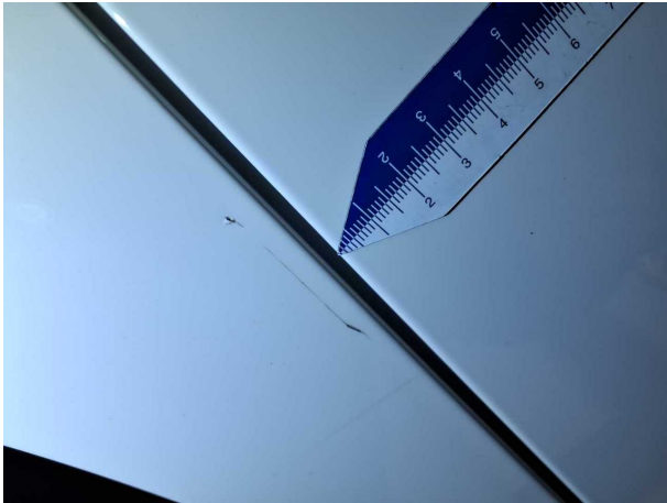
Beschädigung 3: Seitenwand rechts: Seitenwand - Kratzer - Smart Repair
