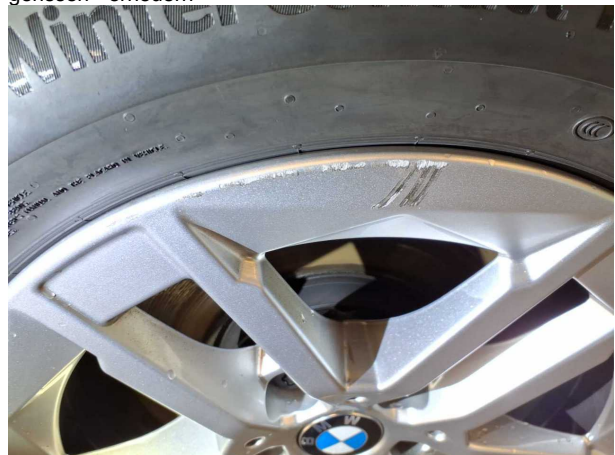
Beschädigung 8: Rad/Reifen: Leichtmetallfelge vorn rechts - beschädigt - erneuern
