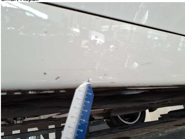
Beschädigung 4: Schweller rechts: Verkleidung - Kratzer - Smart Repair
