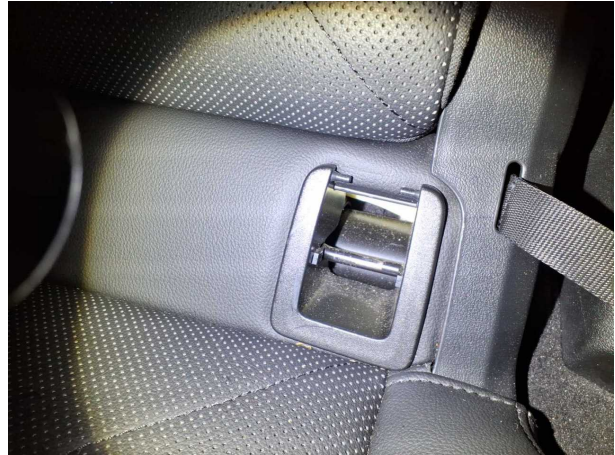
Beschädigung 1: Sitz hinten: Sitz 2. Reihe links (ISO Fix Abdeckung) - fehlt - erneuern
