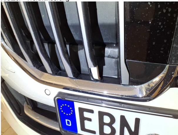
Beschädigung 7: Motorhaube: Kühlergrill - gebrochen / gerissen - erneuern
