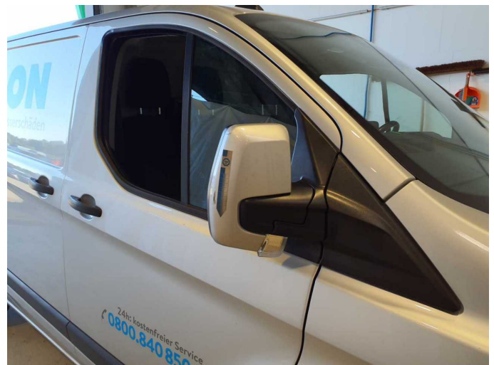
Damage 3: Wing mirror - right side: Cap (Zusätzlich Gehäuse Kratzer) - Scratch(es) - Paint
