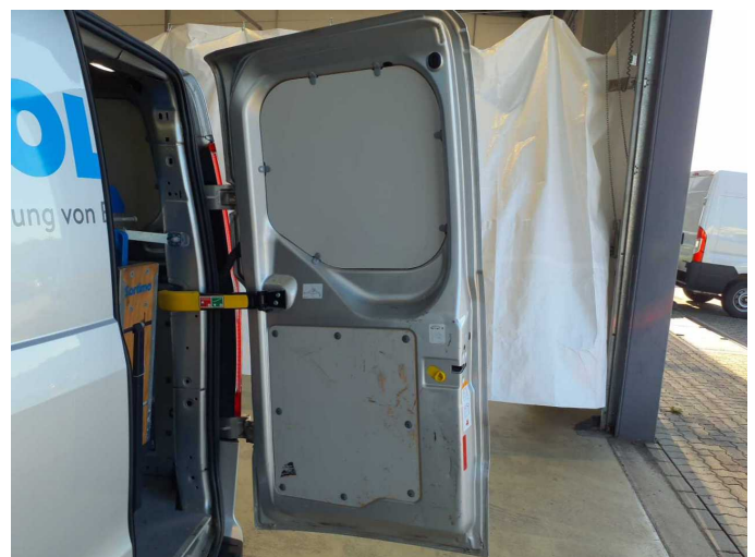
Damage 10: Boot lid / rear door: Rear door - right side (Schwergängig, zusätzlich Korrosion) - Dent / paintcoat damage - Repair and paint
